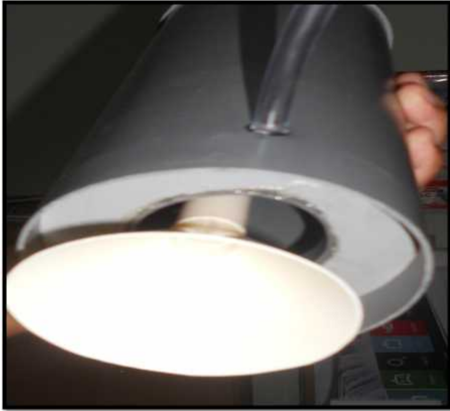
Figura N° 14 Campana Colectora y desfogue de gas metano
