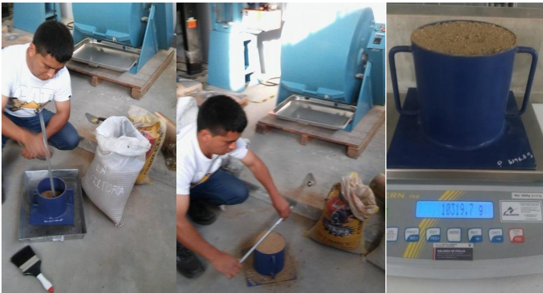
En esta fotografía se muestran el procedimiento del peso volumétrico suelto agregado fino
