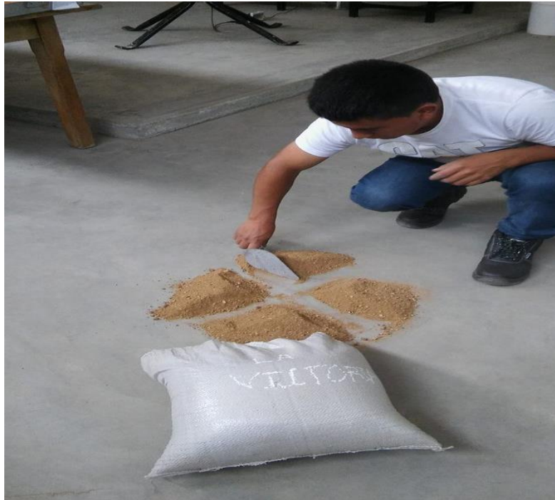
En esta fotografía se muestra el cuarteo del agregado
