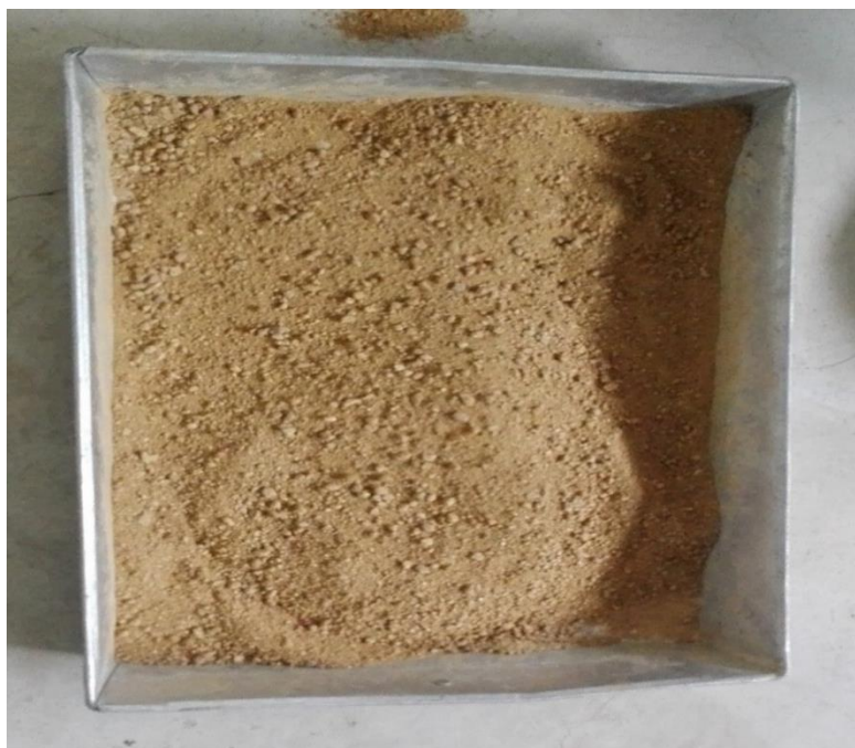
En esta fotografía se muestra al agregado fino secando a temperatura ambiente
