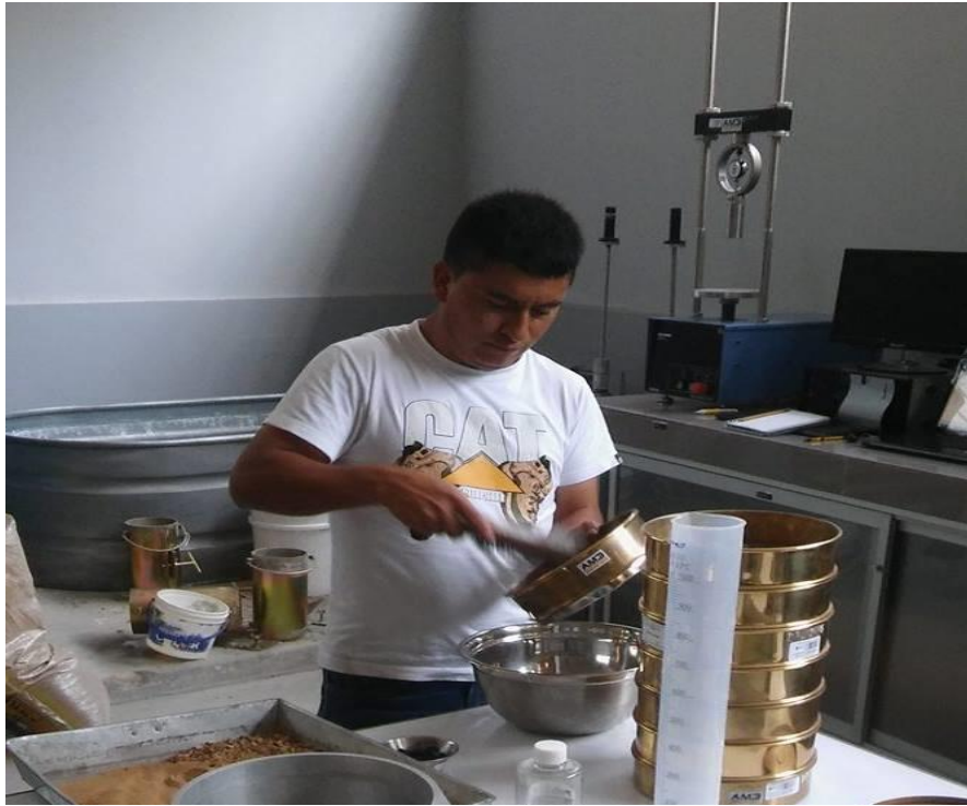
En esta fotografía se muestra sacando las partículas de agregado del tamiz mediante una escobilla metálica
