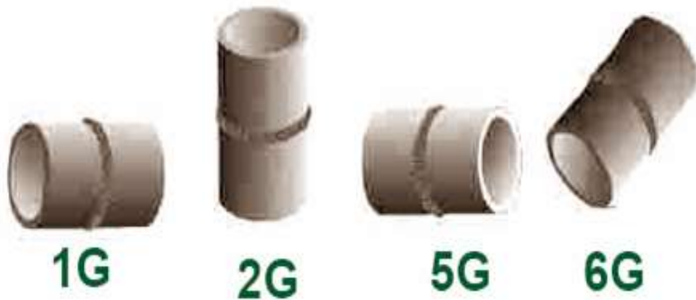
Calificación en tuberías
