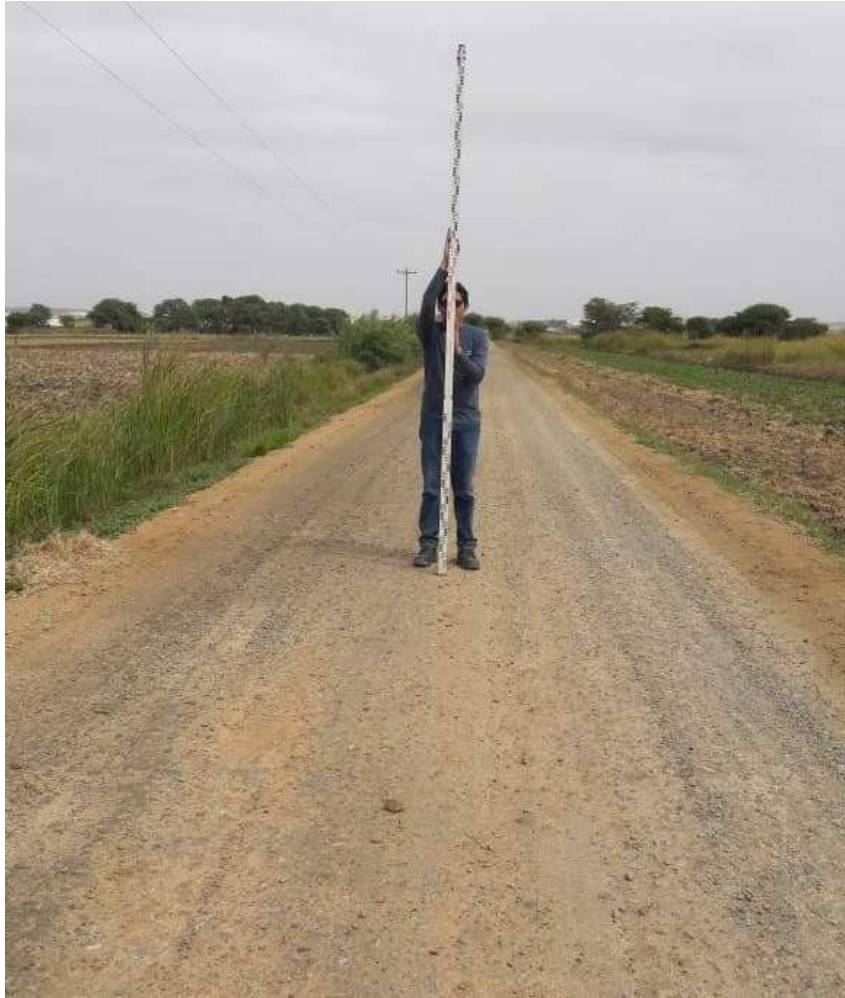
Figura 70. Levantamiento del eje del camino vecinal en el Km 0+300.
