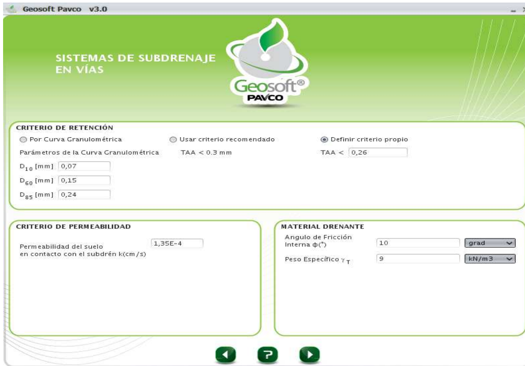
Figura 15. Cálculo del criterio de Retención y de Permeabilidad, así como del material drenante en el software Geosoft PAVCO v3.0
