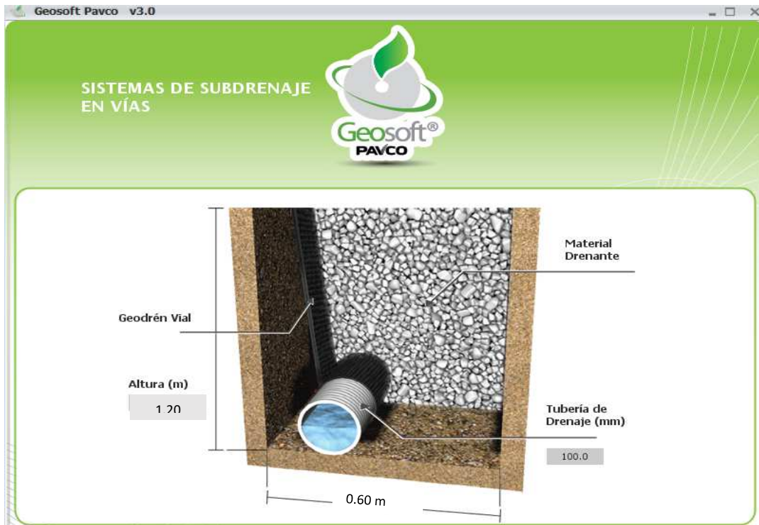
Figura 17. Resultado final de las dimensiones de la sección transversal del Geodren en el software Geosoft PAVCO v3.0
