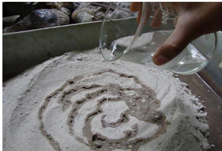
Figura 14: Aplicación de salmuera en laboratorio
