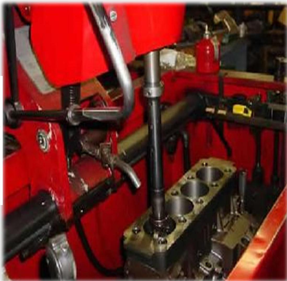
***Recuperación del blok de cilindros.***
