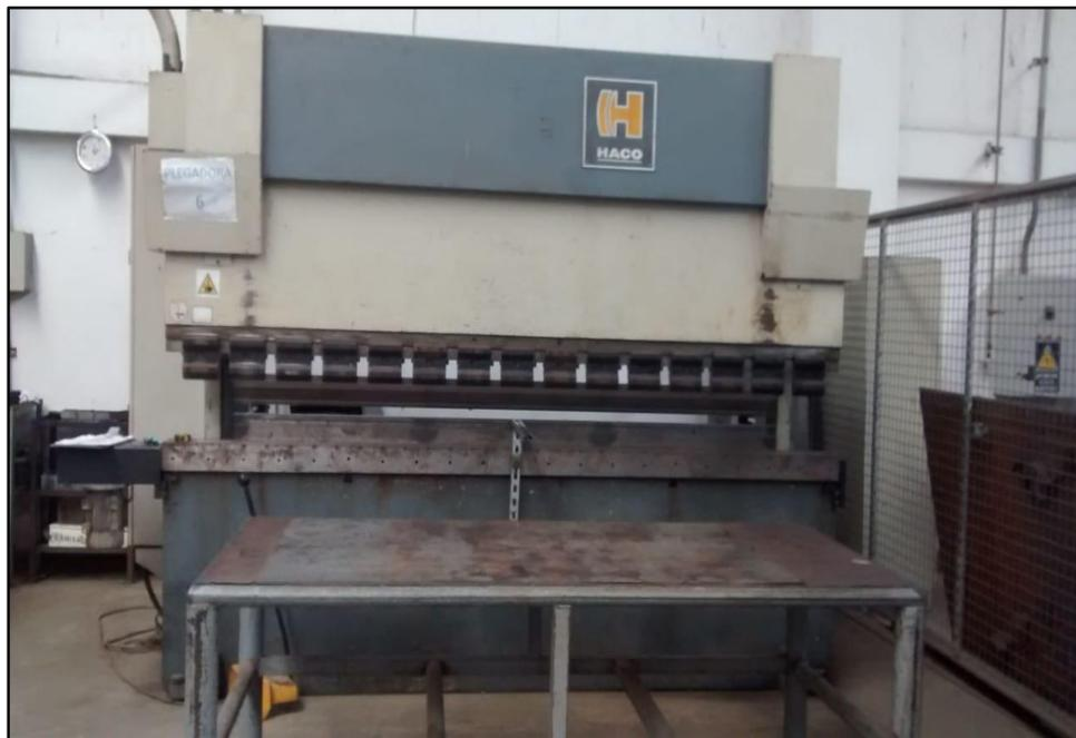
*Figura 10: Plegadora Hidraulica*
