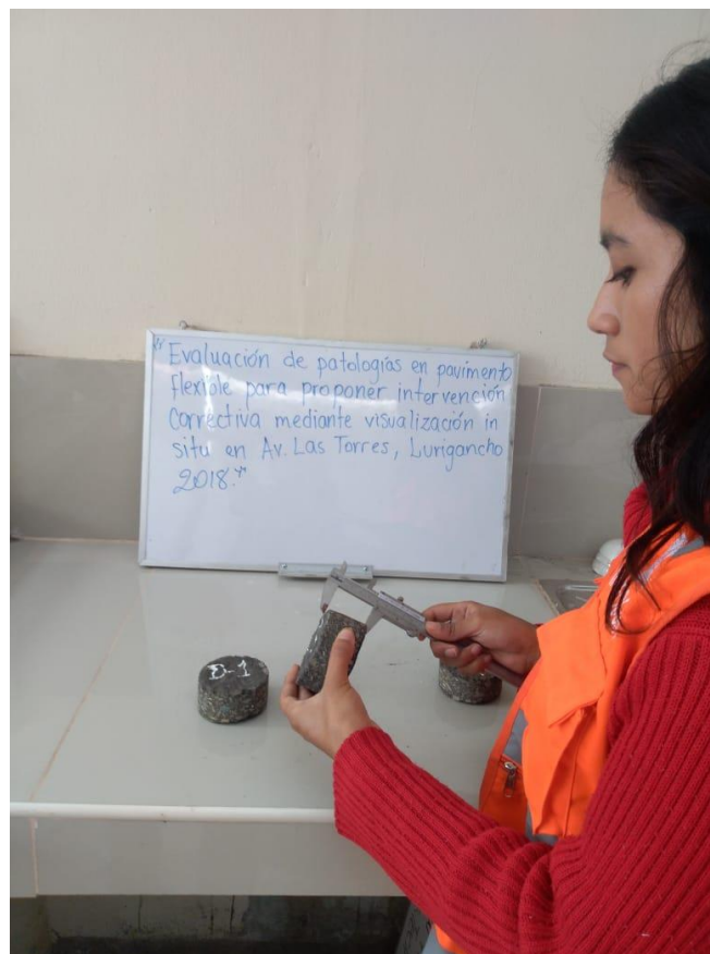
Figura 182. Medición de muestras con el vernier.
