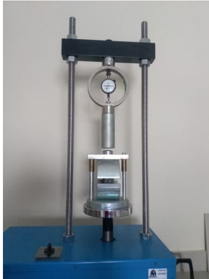
Figura 185. Equipo para la estabilidad y flujo.
