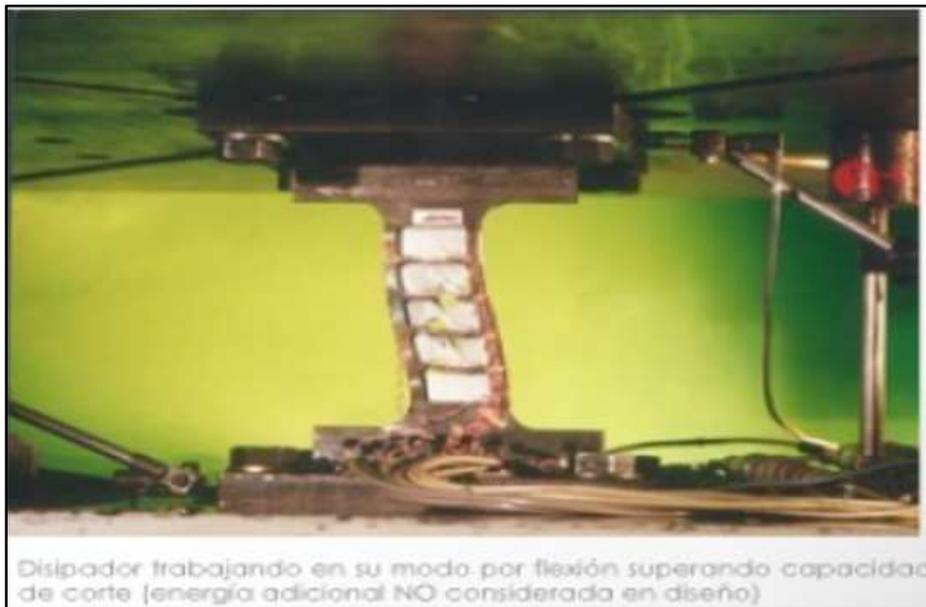
Figura 5. Disipador trabajando en su modo por flexión
