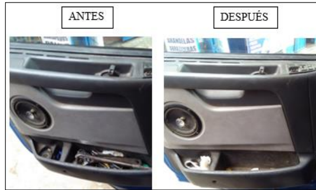
Figura 23: Antes y Después del Mantenimiento Autónomo
