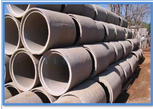
Figura 73: Tubería de fibrocemento
