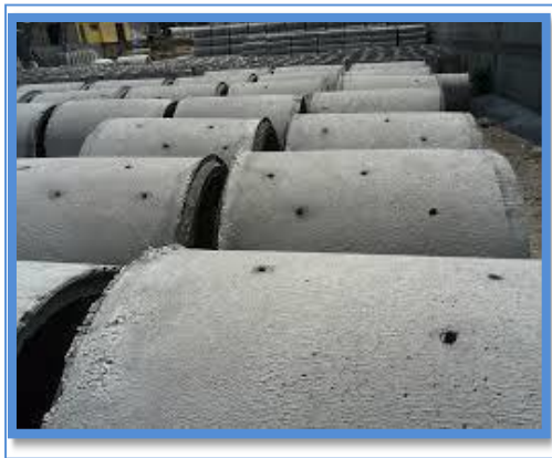
Figura 75: Tubería de Concreto
