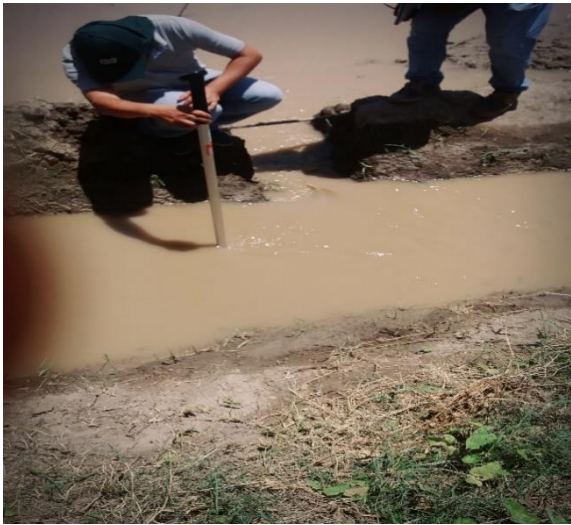
FIGURA N°13. Medición de ingreso de agua con el correntómetro- Apoyo INIA
