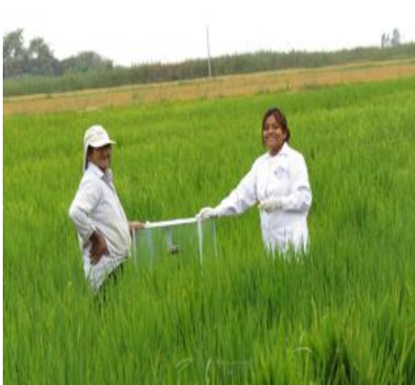
FIGURA N° 31. Recojo de muestra de gas metano en el cultivo de arroz
