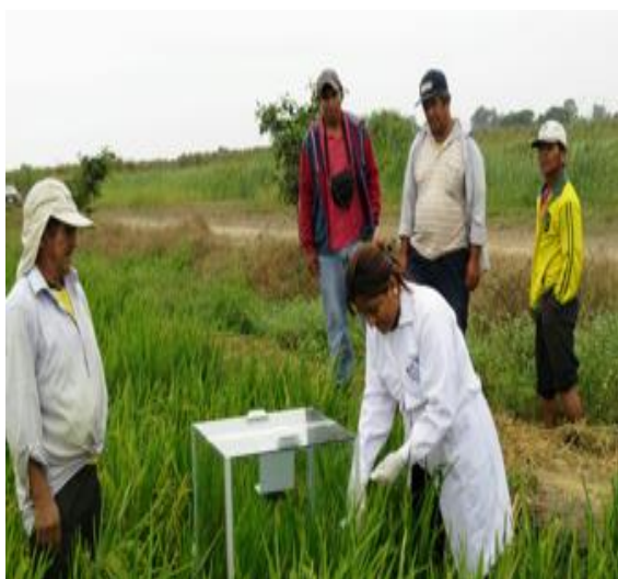
FIGURA N° 33. Recojo de Muestra de gas metano en cámara estática.
