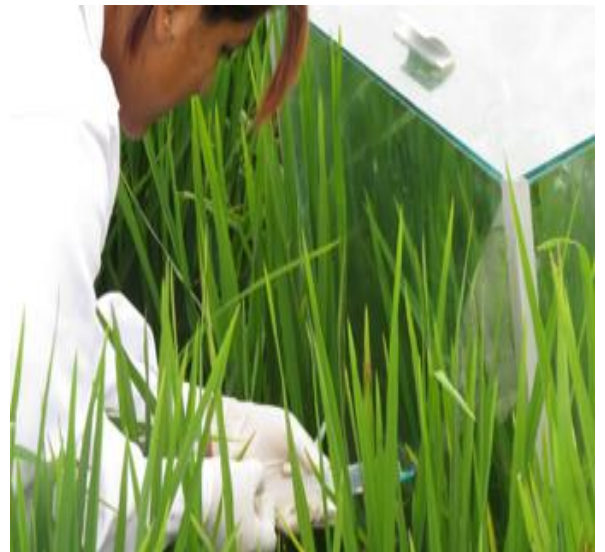
FIGURA N° 32. Extracción de Gas Metano en la Cámara Estática.
