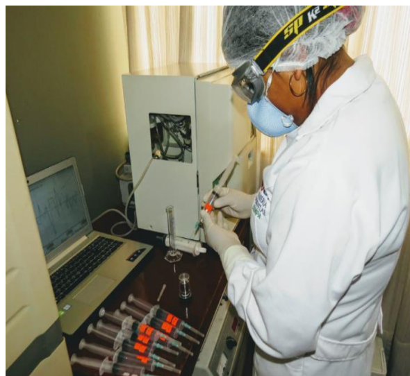
FIGURA N° 34. Inyectado del gas Metano en viales diseñados para el analizador del Cromatógrafo de Ga gases
