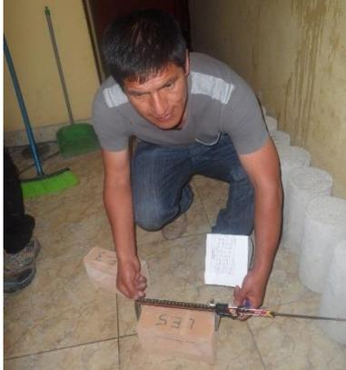
**Foto N° 05.** Unidades para prueba de resistencia compresión.
