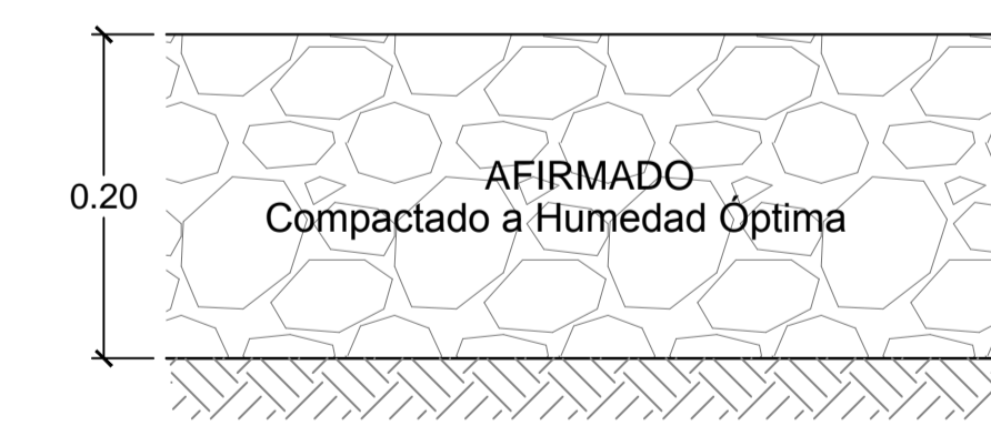
Sección del Pavimento Esc. 1:5
