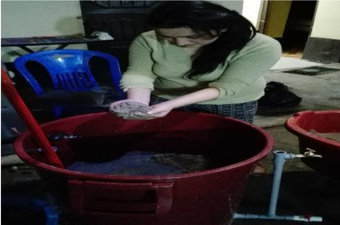
FIGURA N° 27 Incorporación de la última capa filtrante conformada por la arena fina con una altura de 25 cm
