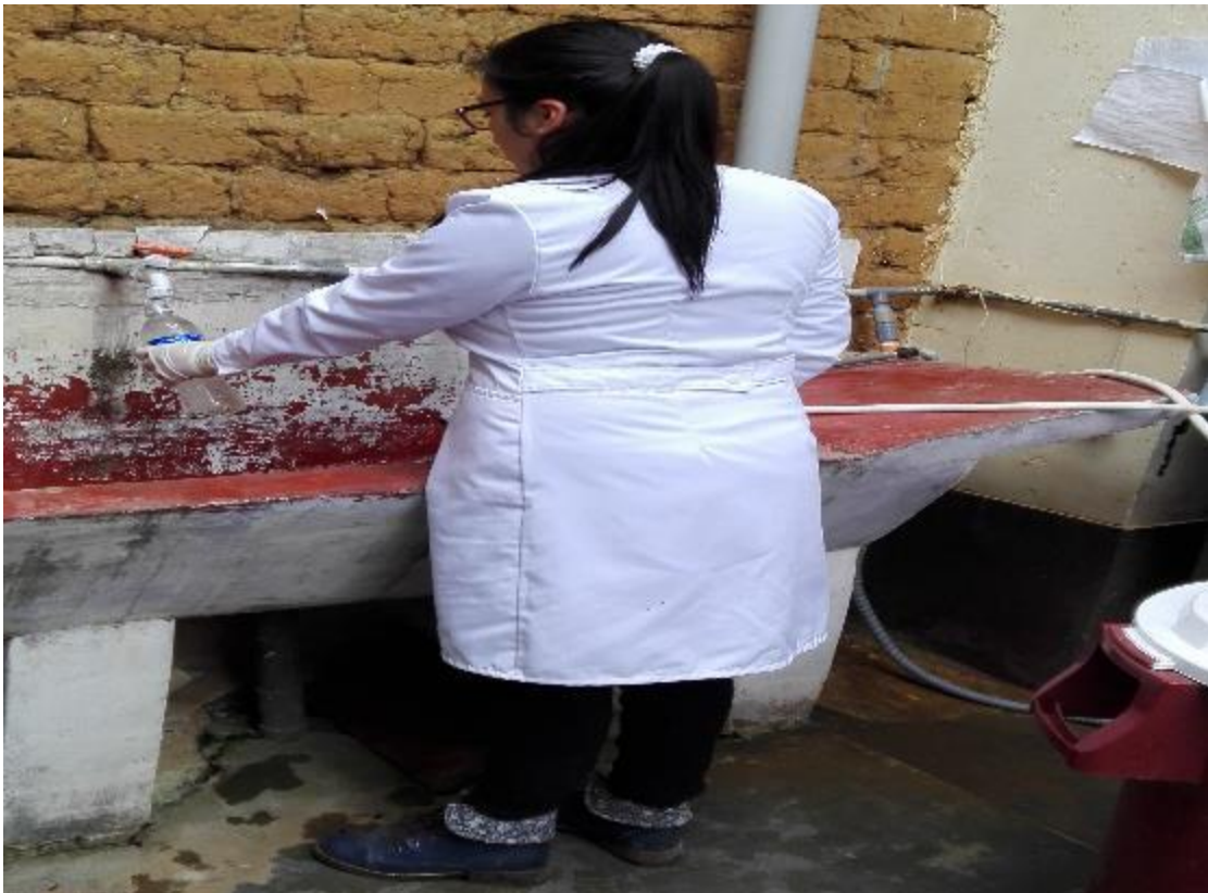
FIGURA N° 38 Toma de muestra del agua sin tratamiento (no filtrada)
