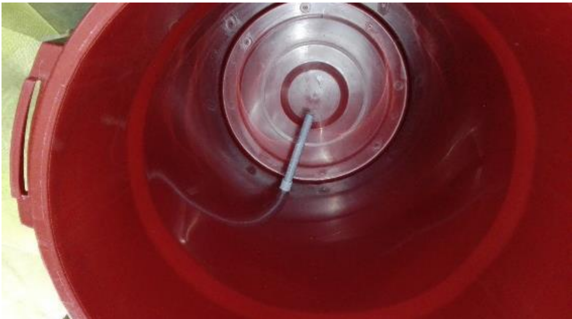
FIGURA N° 10 Se incorporó el tubo de 15 cm por el interior que servirá como salida del agua y limpieza del filtro
