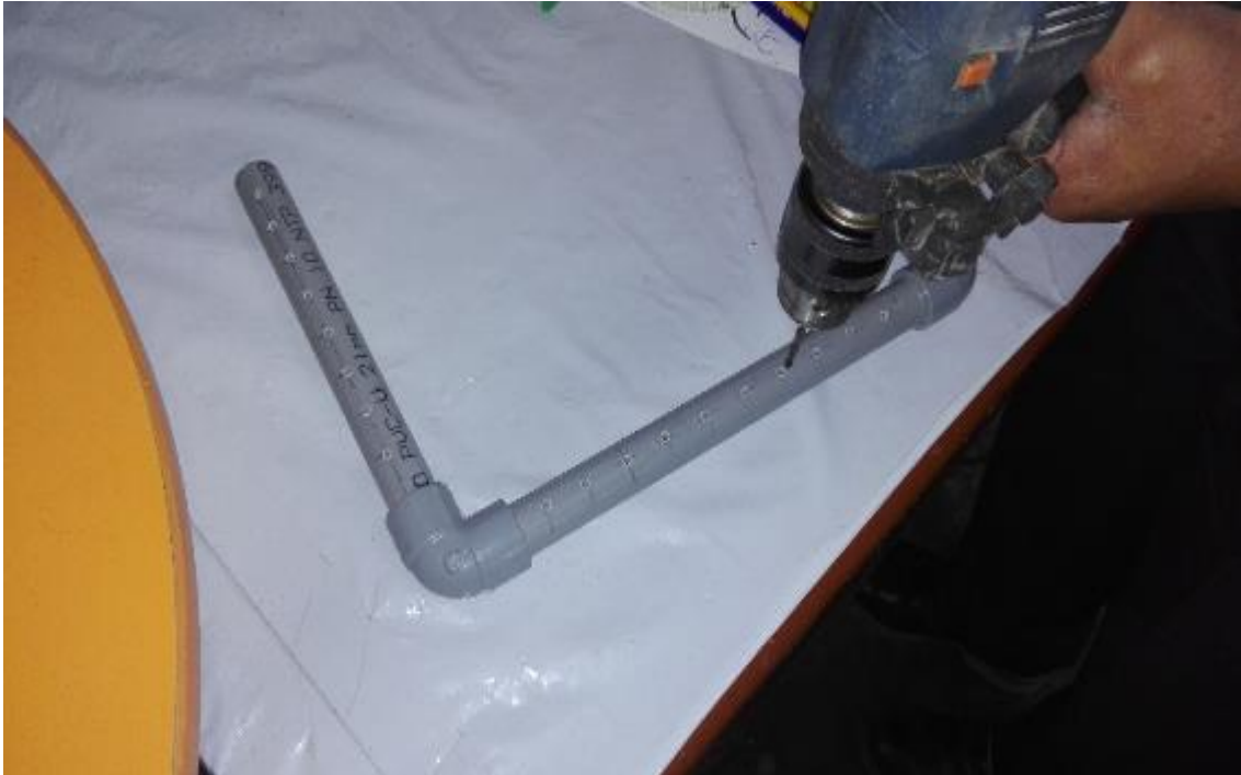
FIGURA N° 11 Se realizó perforaciones a los tubos de 39 cm y 1 de 26 cm con una broca de 0,5 milímetros a una distancia de 1 cm para el difusor del agua.
