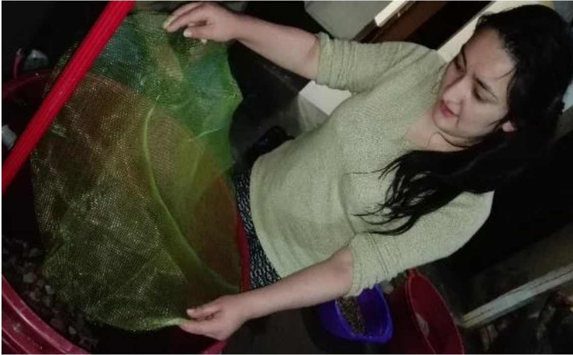
FIGURA Nº 21 Ubicación de la malla plástica gruesa y fina después de cada capa filtrante llenada
