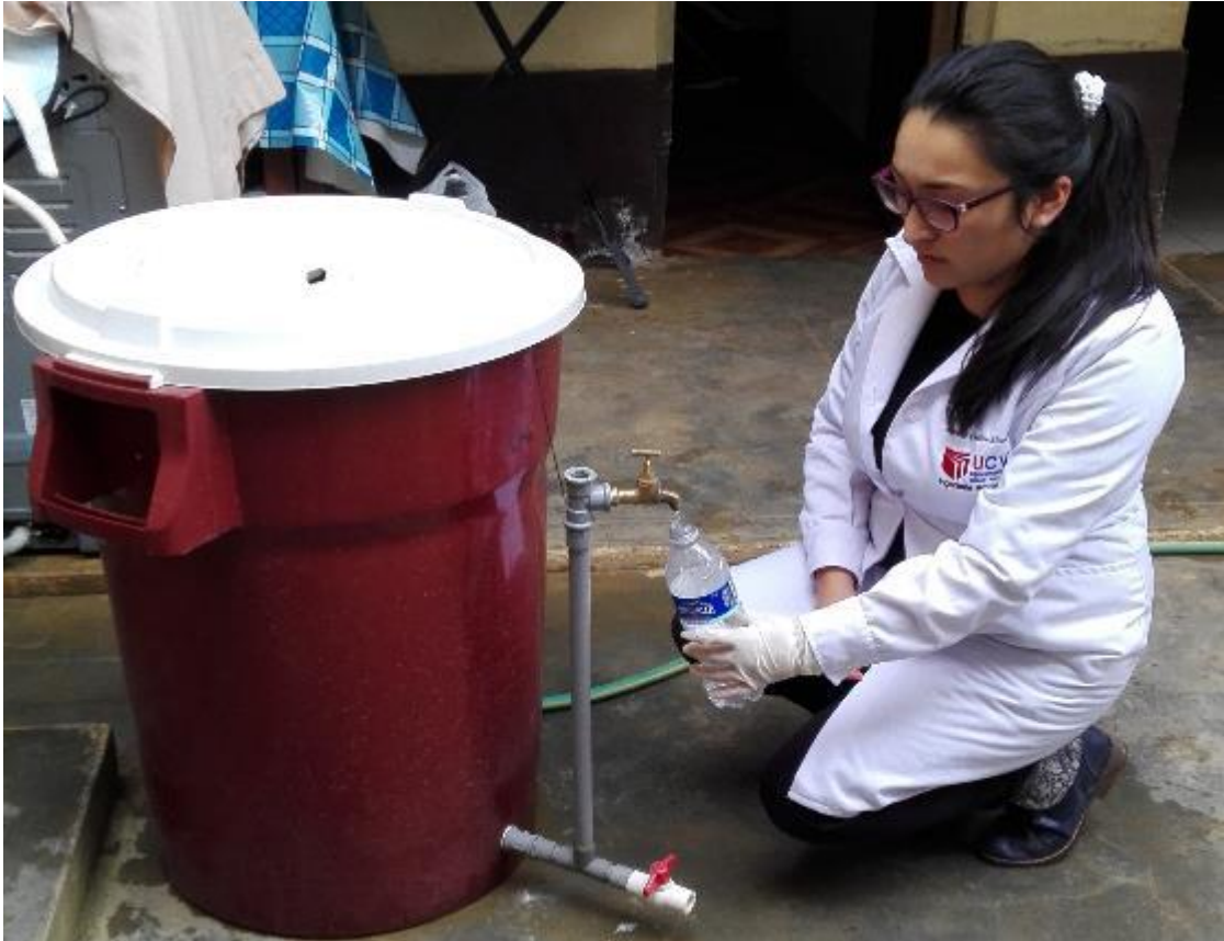
FIGURA N° 39 Toma de muestra del agua tratada (filtrada)
