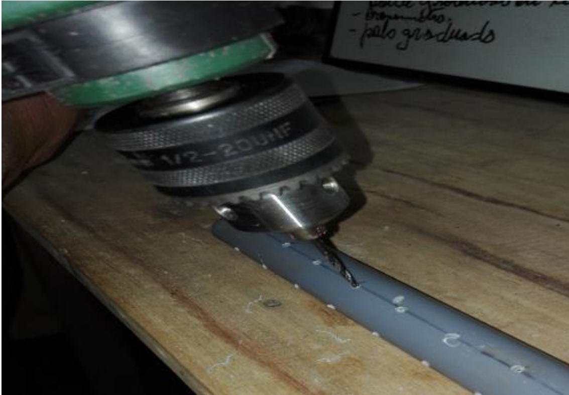
FIGURA N° 09 Perforación del tubo de 15 cm con una broca de 0,5 milímetros se realizó dos filas con una distancia de 1 cm.
