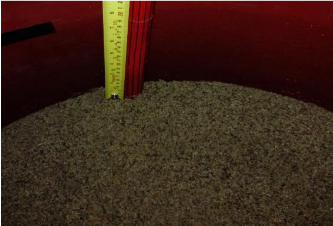
FIGURA N° 28 Toma de medida de los 7 cm del llenado de agua para la formación de la capa biológica
