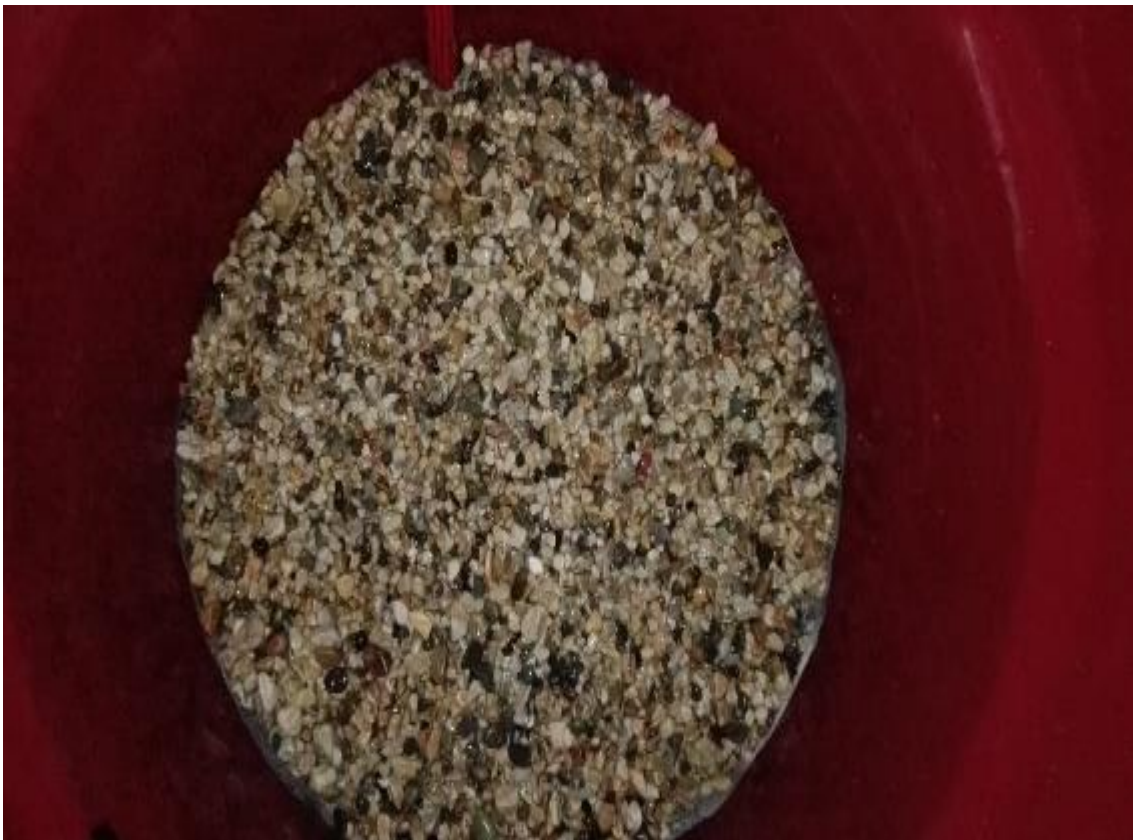
FIGURA Nº 22 Llenado de la tercera capa filtrante con gravilla de 1cm de diámetro
