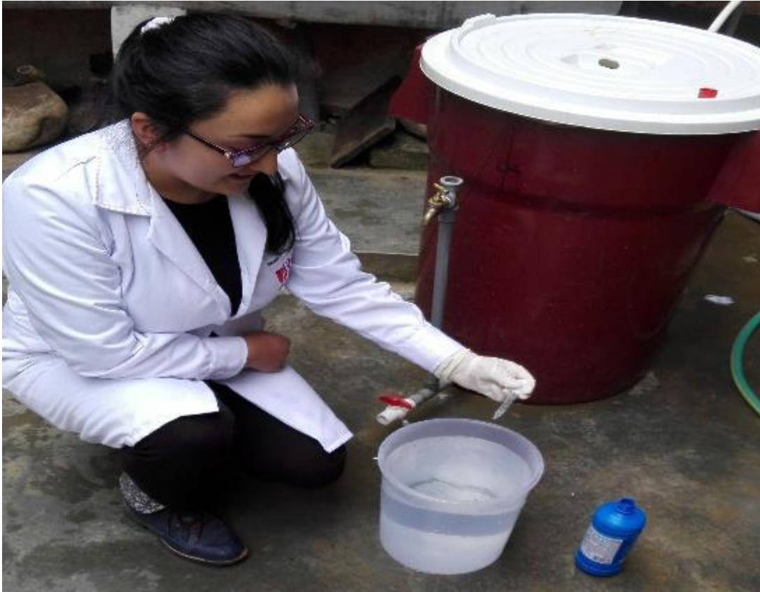
FIGURA N° 41 Cloración del agua después de la filtración 2 gotas de cloro/ litro
