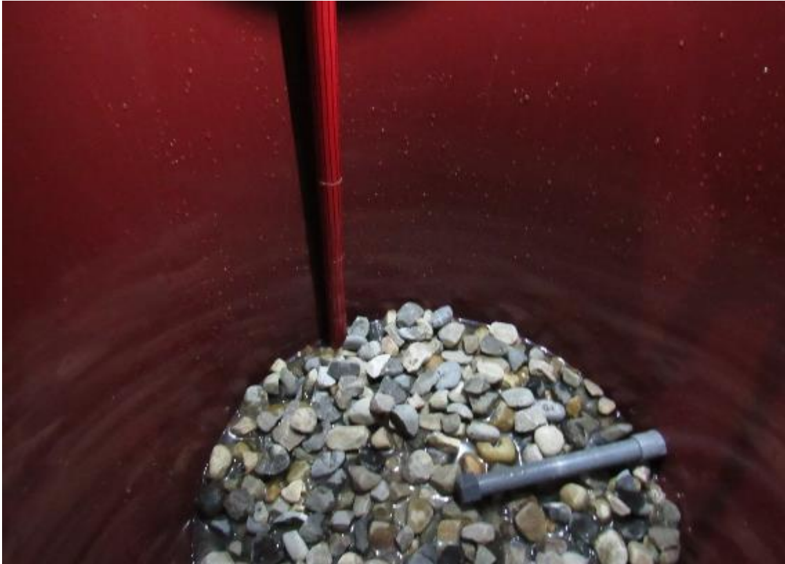
FIGURA N° 17 Llenado de la primera capa con ayuda de un palo de madera señalando los 10 cm
