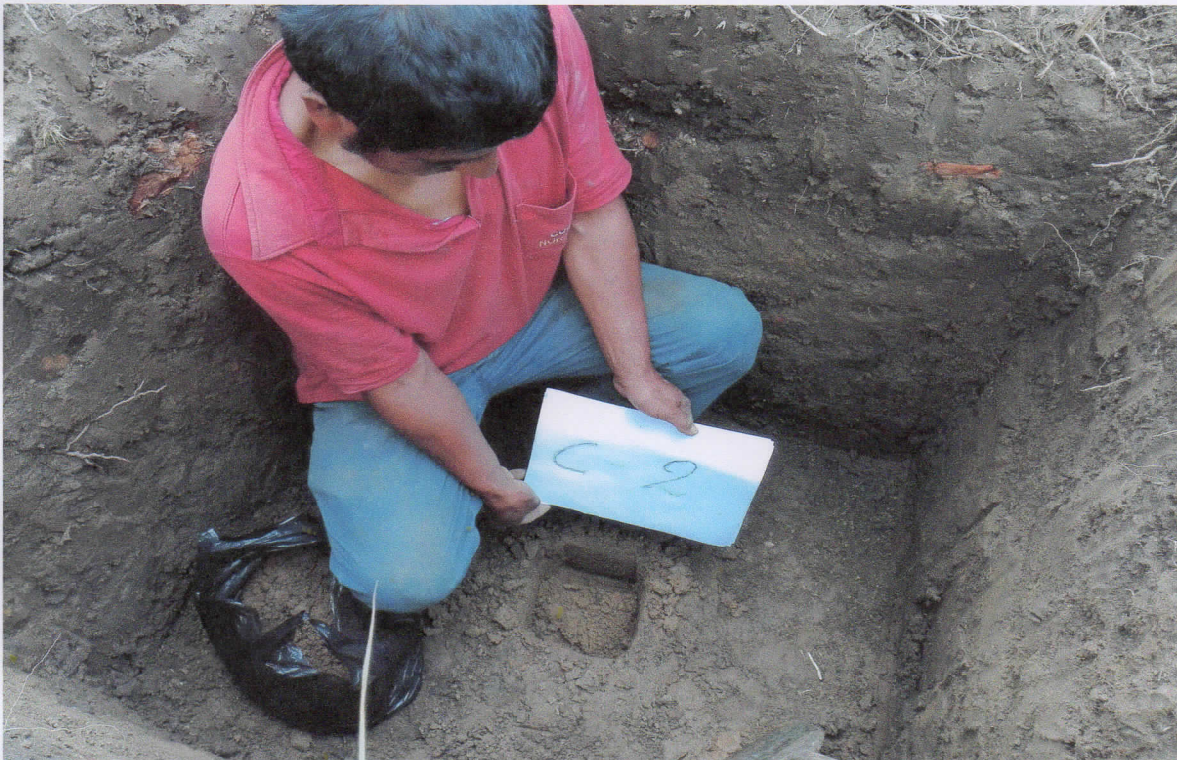
VISTA DE LA CALICATA N° 02 - LINEA DE CONDUCCION
