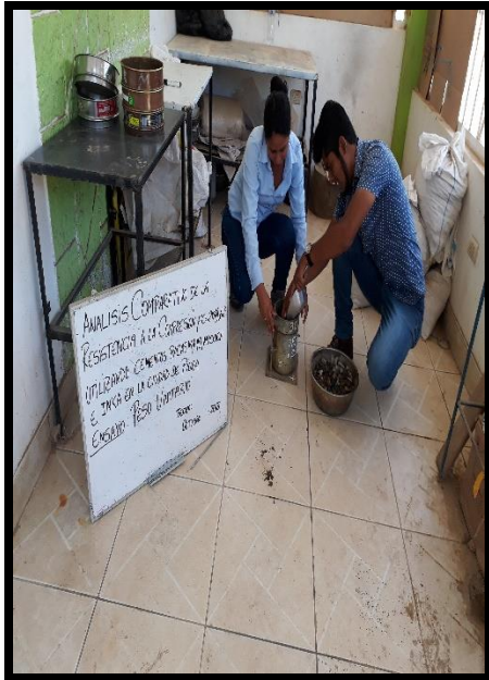
Figura 10: Ilustración del Procedimiento del Ensayo para el Agregado Grueso
