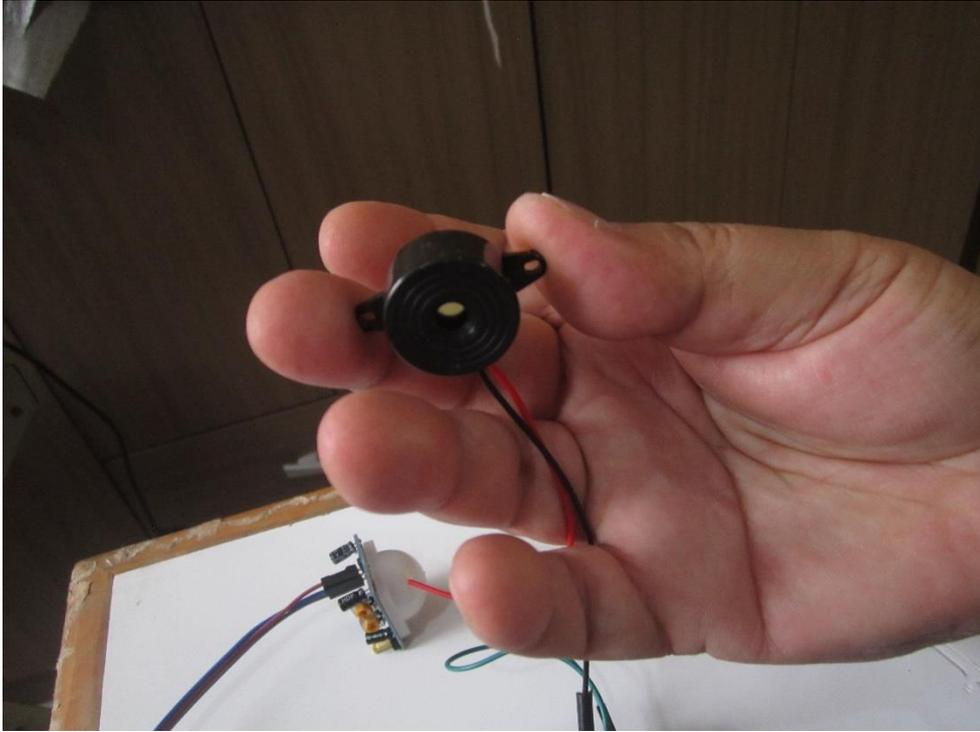
**Figura N° 26: Buzzer o bocina de la placa Raspberry**
