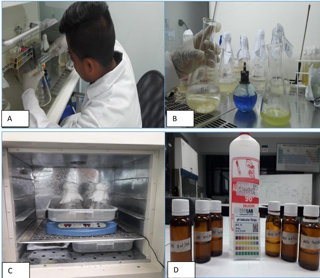
**A.-** 200ml de agua de río en cada matraz **B.-** Caldo TSB con *Pseudomonas aeruginosa* a 5, 10 y 15 ml a cada matraz **C.-** Incubar a 24, 48 y 72 h con el método de agitación **D.-** A cada muestra se agregó Hidróxido de Sodio hasta mantener el pH básico.
