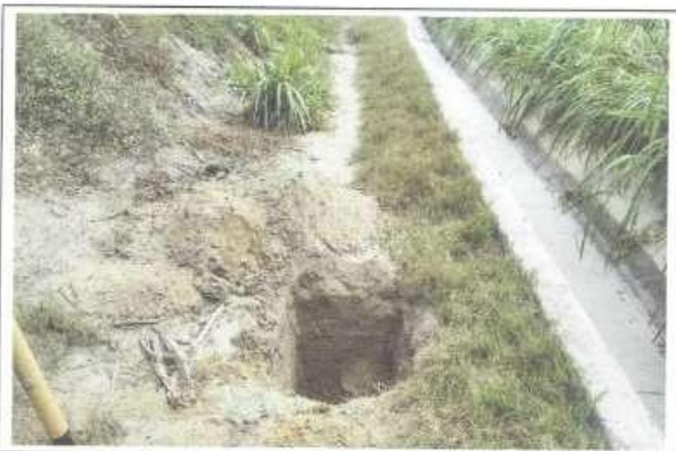
**Foto N°05:** Vista de la C-05, en su parte superficial se denota un suelo orgánico con presencia de resto de raíces de 0.00 – 0.10m; seguido de arena limosa (SM) a profundidad, suelto a medianamente compacto y de finos no plásticos y de color beige claro, hasta los 1.20m.
