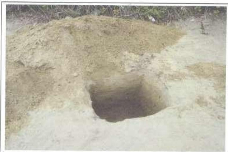
**Foto N°03:** Vista de la C-03, en su parte superficial se denota un suelo orgánico con presencia de resto de raíces de 0.00 – 0.10m; seguido de arena mal graduada con limo (SP-SM), suelto a medianamente compacto y de finos no plásticos hasta 1.35m.
