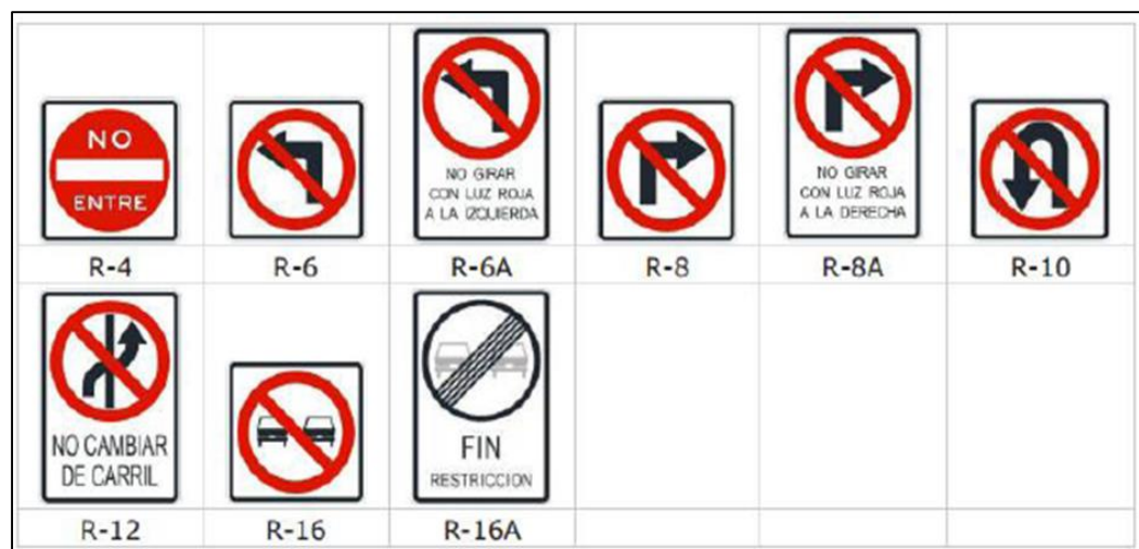
Figura 31: Señales de prohibición de maniobras y giros
