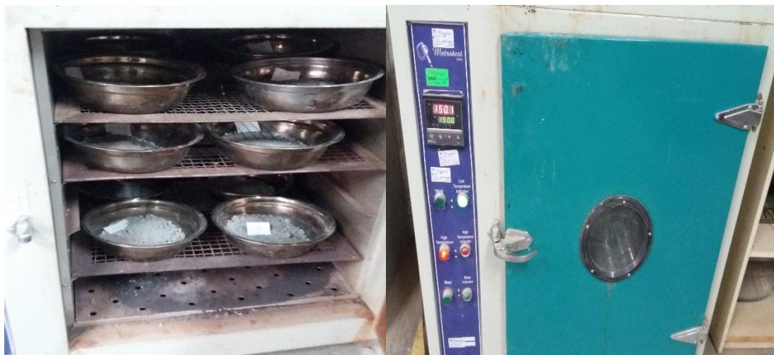
Figura 49. Mezclas a 150°C para luego ser compactadas.
