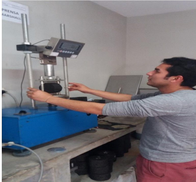
Figura 28. Prueba de tracción indirecta a la briqueta.
