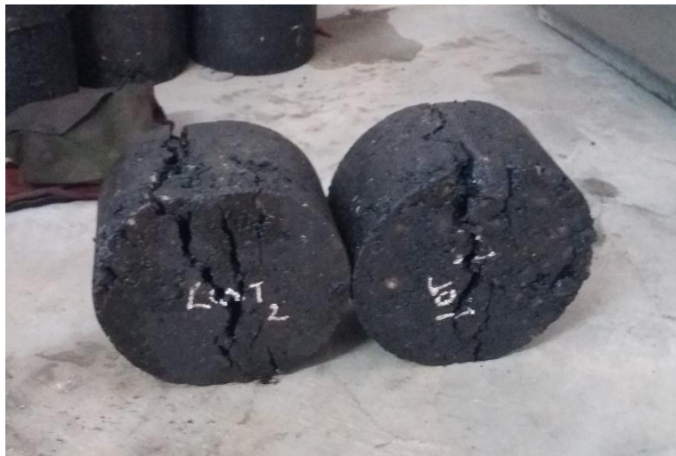
Figura 29. Visualización de las briquetas después de ser sometidas al ensayo lottman.
