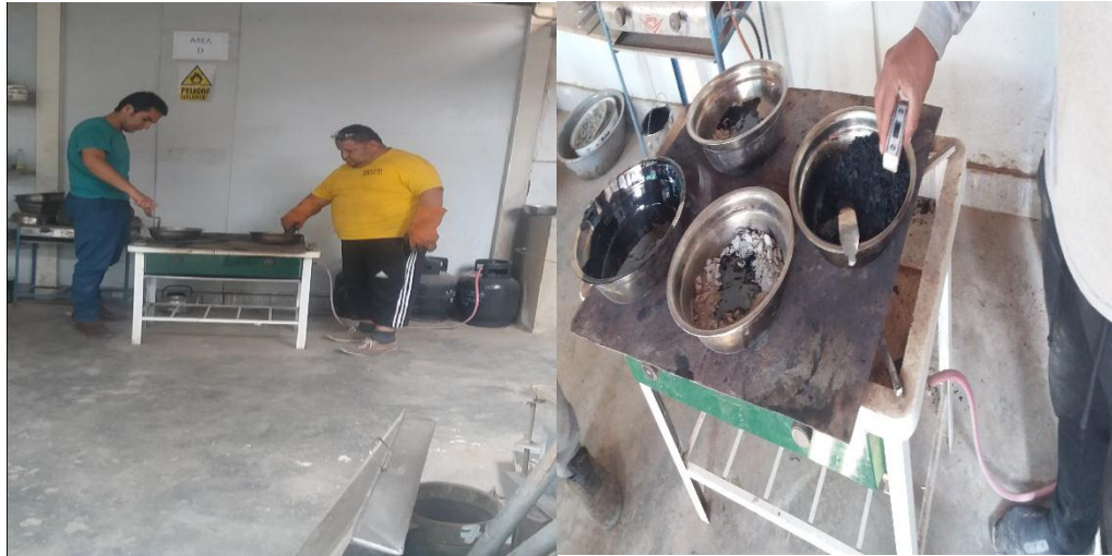
Figura 50. Mezclado de agregados a 145°C.
