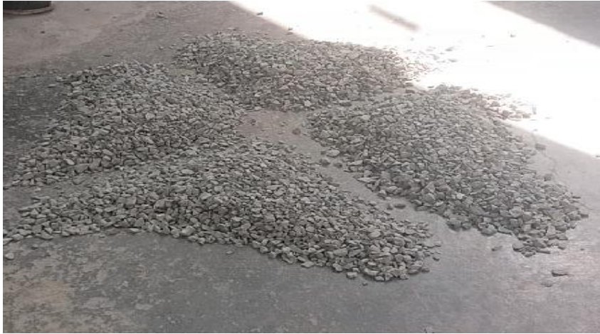
Figura 13. Cuarteo del agregado grueso.
