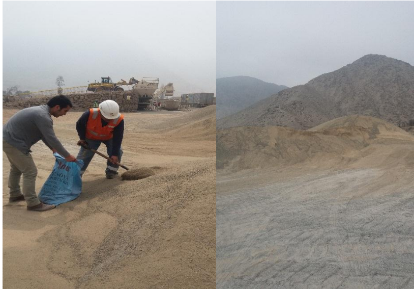
Figura 45. Recojo de arena natural en la mezcladora de asfaltos Gloria – Cantera Gloria.
