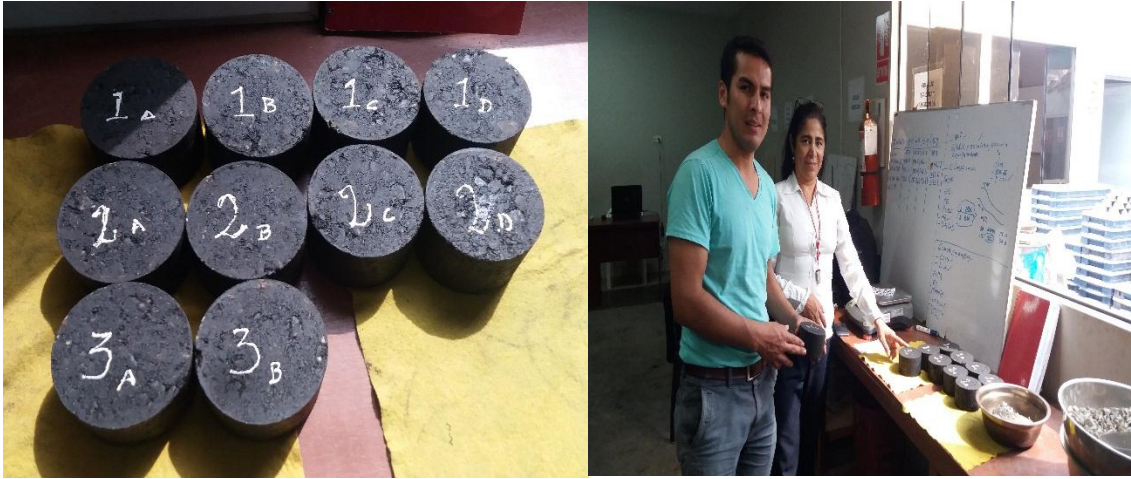
Figura 56. Briquetas con el 10, 15, 12 % de escoria.
