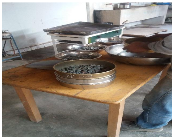
Figura 16. Tamizado del agregado grueso.
