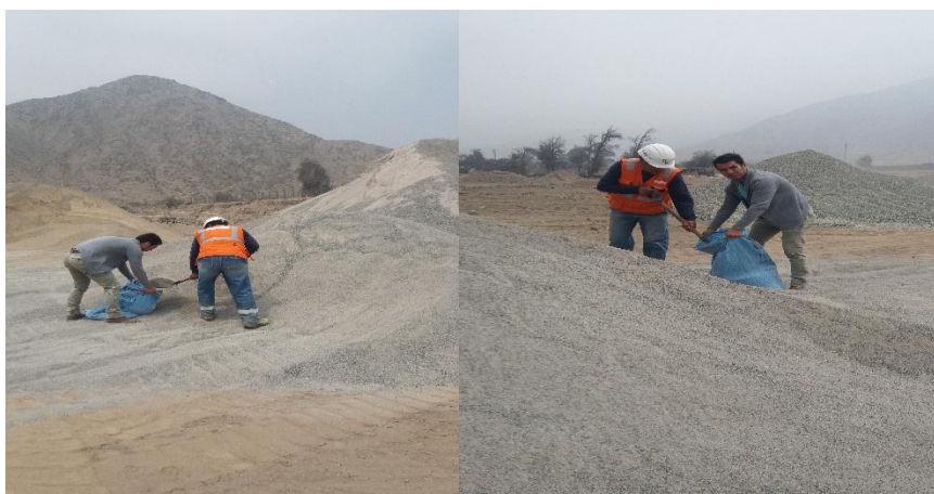
Figura 44. Recojo de la arena triturada en la mezcladora de asfaltos Gloria – Cantera Excalibur.
