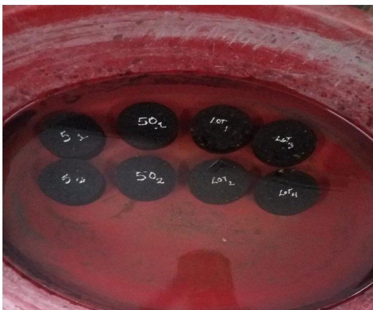
Figura 27. Saturación de briquetas para el ensayo lottman por 30 minutos.
