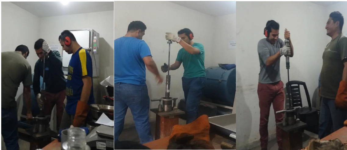
Figura 54. Compactación de mezclas asfálticas a 75 golpes según norma.
