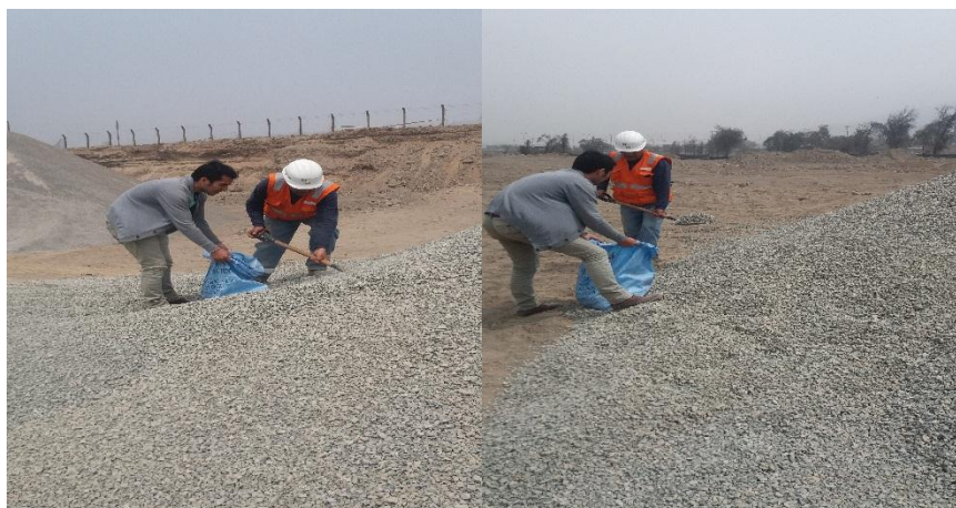
Figura 43. Recojo de la grava triturada en la mezcladora de asfaltos Gloria – Cantera Carapongo.
