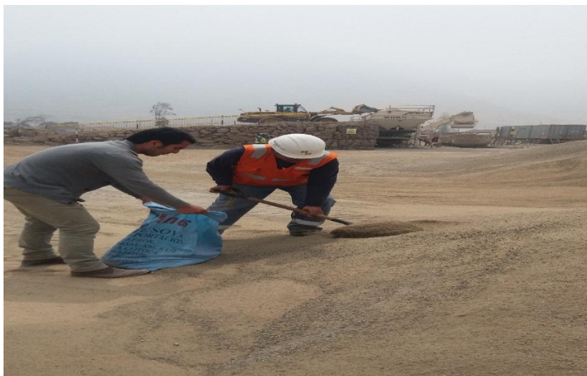
Figura 11. Recojo de agregados en la planta mezcladora de asfaltos Gloria ubicada en huachipa.
