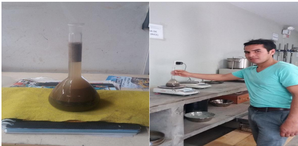
Figura 51. Ensayo de equivalente de arena.
