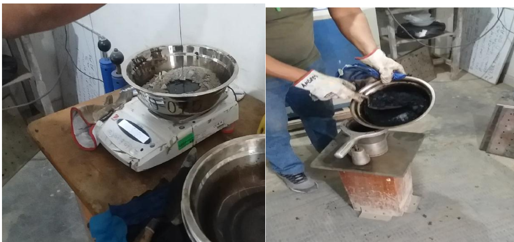
Figura 52. Adición de asfalto a la mezcla y echado al molde.
