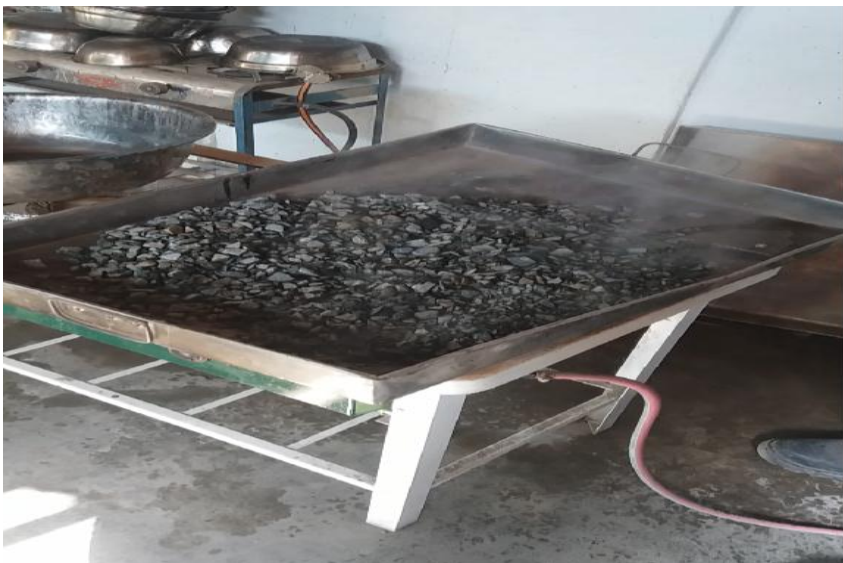
Figura 15. Lavado y secado del agregado grueso.
