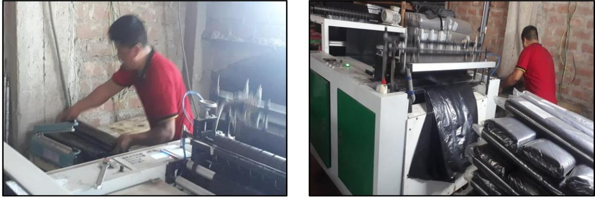
*Figura 25.* Empaque de bolsas y sellado manual del empaque
