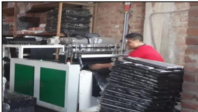
*Figura 24.* Retiro de las bolsas de la máquina selladora
