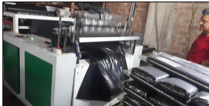
*Figura 26.* Inspección del sellado de bolsas
