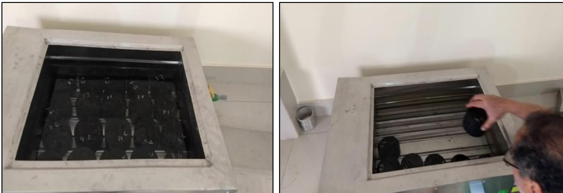
Figura 58. Baño maría de las briquetas a 60 °C por 30 min.
