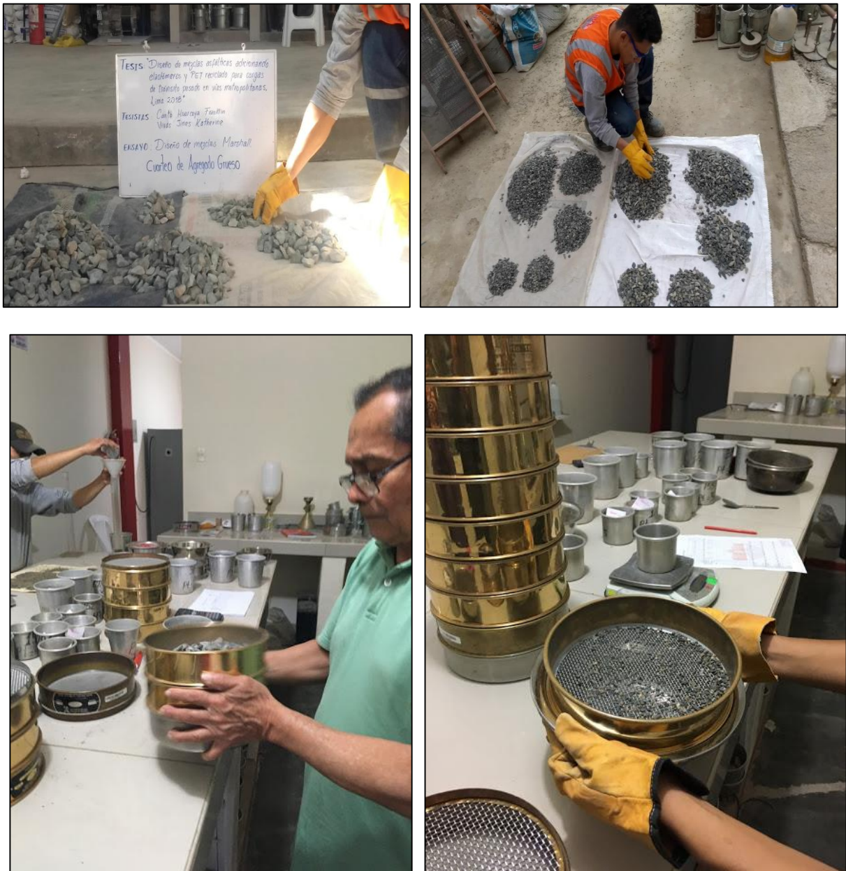
Figura 25. Tamizado y Cuarteo del agregado grueso
