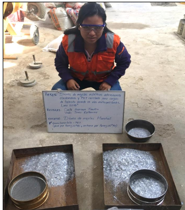
Figura 30. Granulometría del PET, pasa por tamiz N°10 y retenido en el tamiz N°40.
