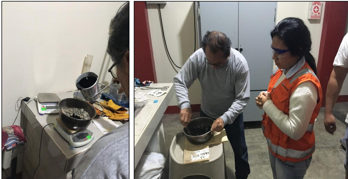
Figura 34. Mezcla de los agregados y el cemento asfáltico.
