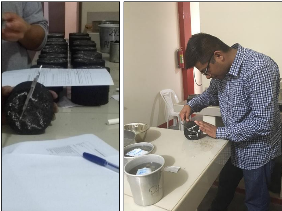
Figura 56.Medición de la altura de la briqueta
