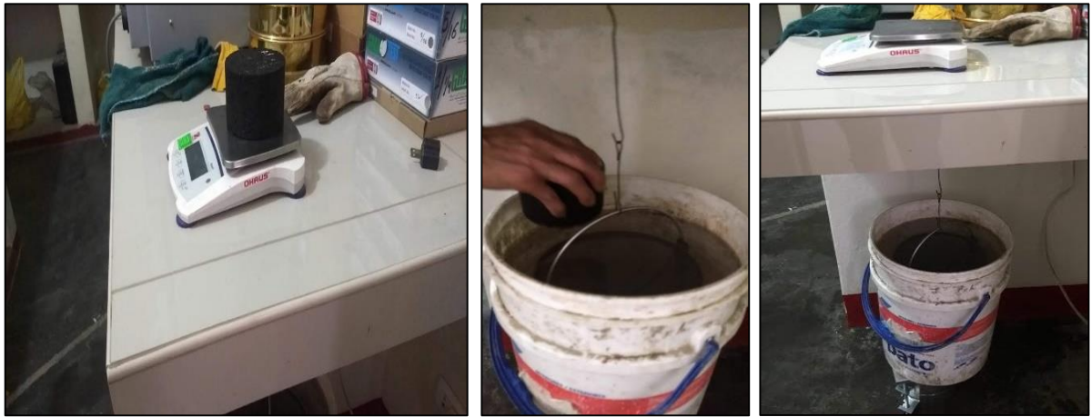
Figura 38. Peso seco de la briqueta y peso sumergido.
