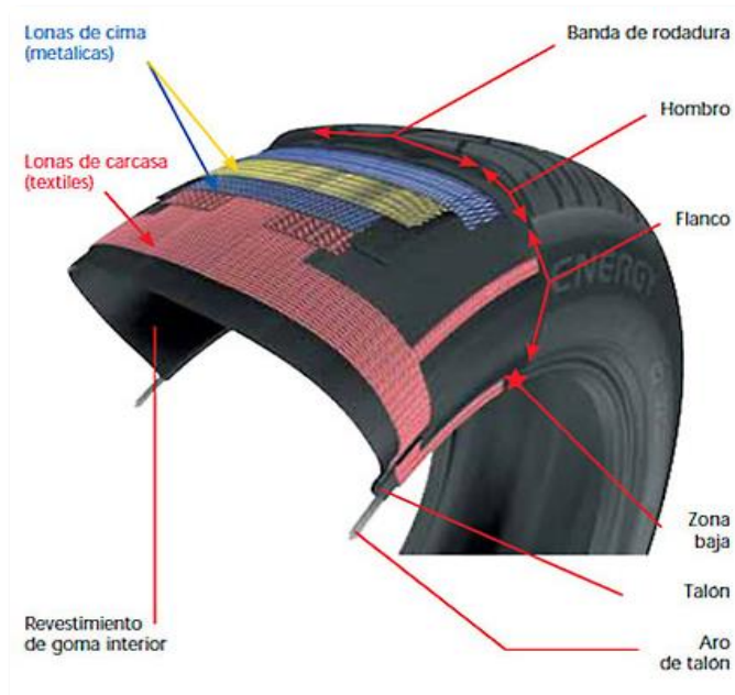
Figura 1. Composición de un Neumático que cumple con su función. Conocer la formación de sus componentes contribuye a la seguridad. Adaptado de Euromaster (2018).
