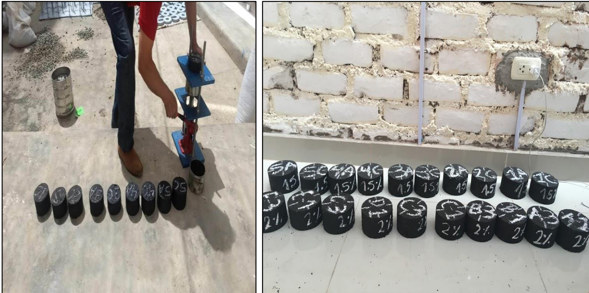
Figura 55.Extracción del espécimen del molde y codificación de las briquetas
