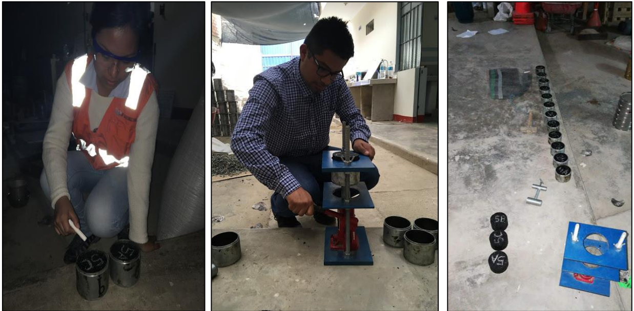
Figura 36.Extracción del espécimen del molde y codificación de las briquetas
