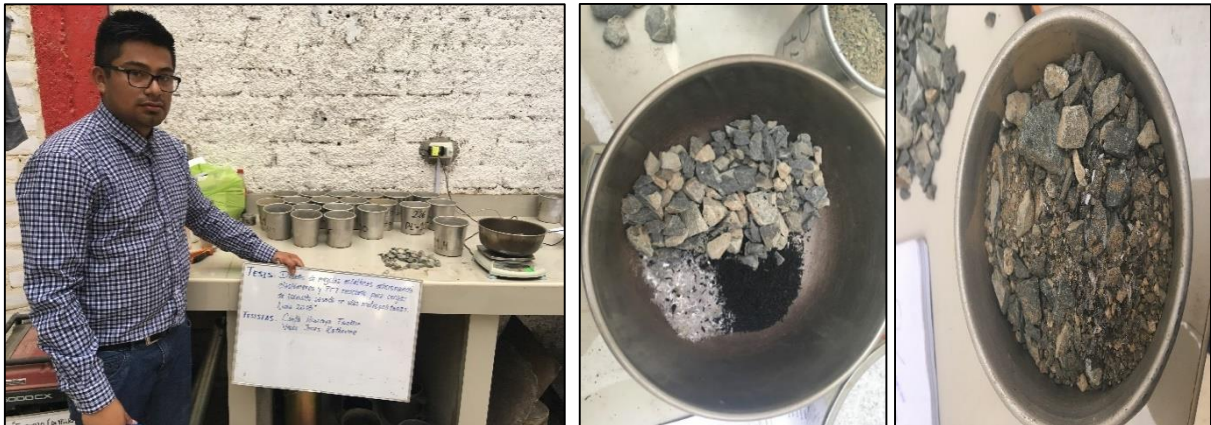
Figura 51. Peso de los agregados según dosificación
