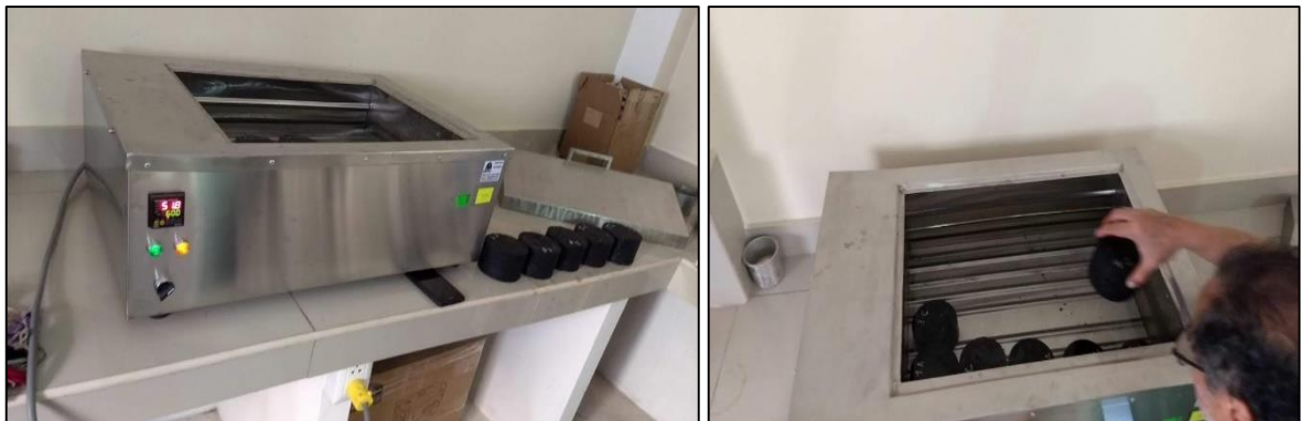
Figura 39. Baño maría de las briquetas a 60 °C por 30 min.
