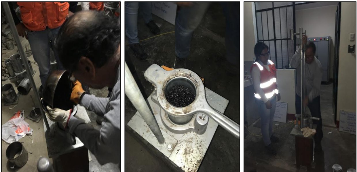
Figura 35. Compactación de la mezcla asfáltica patrón
