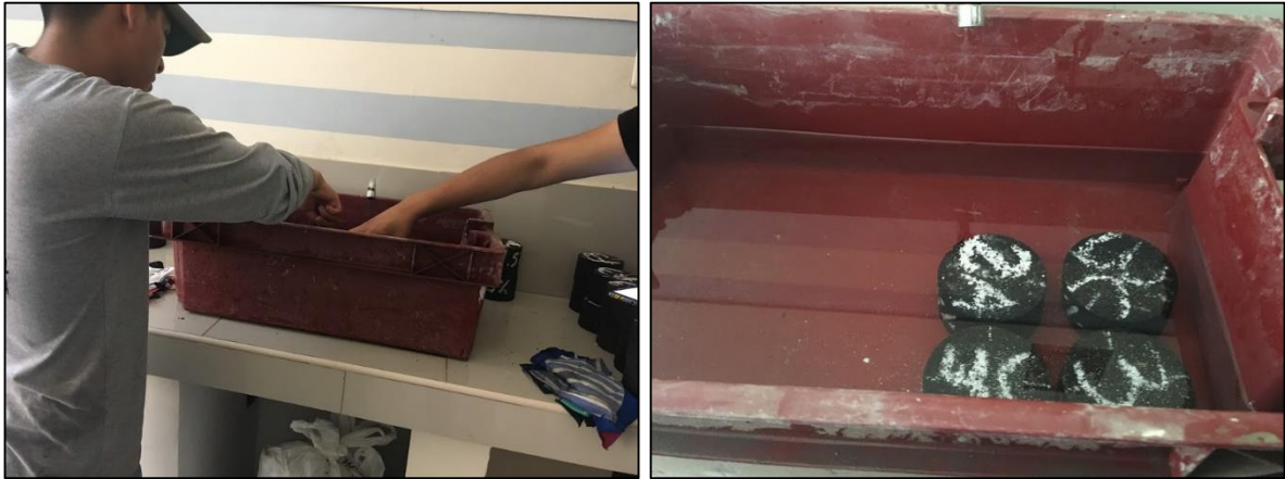
Figura 57. Peso seco de la briqueta y peso sumergido.
