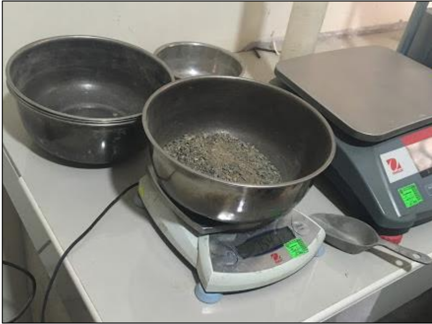
Figura 32. Peso de los agregados según dosificación
