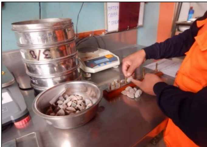
Figura 20. Determinación de partículas chatas y alargadas.
