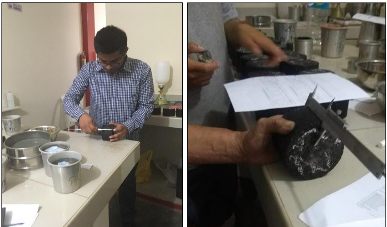
Figura 37.Medición de la altura de la briqueta
