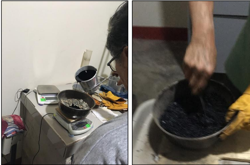
Figura 53. Mezcla de los agregados y el cemento asfáltico.
