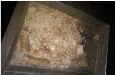
CHANCADO DE MATERIAL SECO COMPACTO PARA DETERMINAR SU GRANULOMETRÍA
