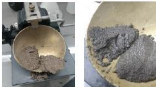
ENSAYO DE DETERMINACIÓN DE LÍMITE LÍQUIDO PARA DIFERENTES MUESTRAS DE SUELO
