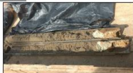
PRESENCIA DE ARENA CON ARCILLA EN UNA DE LAS MUESTRAS AL FINALIZAR EL ENSAYO
