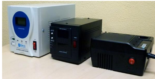
Figura N° 32: Estabilizador de Tensión
