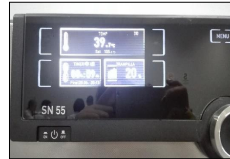
Se puso en la mufla durante 48 horas con una tempera 60°C.
