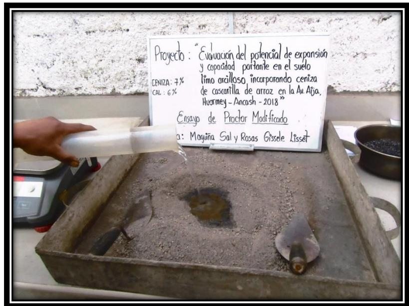
Preparación de suelo para ensayo de proctor modificado
