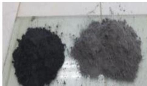
**Figura 4.** Ceniza de cascarilla de arroz después de la molienda
