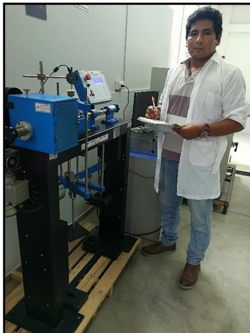
**Figura N° 16:** Máquina de Corte Directo Automatizado. Fuente: propia.
