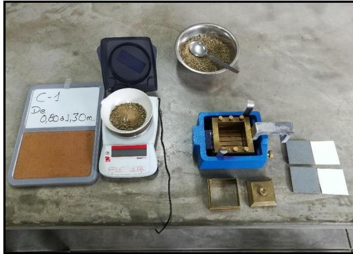
**Figura N° 15:** Muestra para ensayo de Corte Directo. Fuente: propia.
