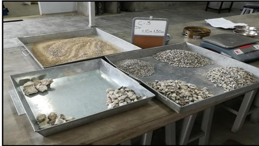
**Figura Nº 14:** Tamizado en muestra de calicata C-3. Fuente: propia.
