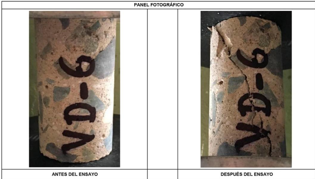
*Figura No. 26: Resistencia a la compresión. Estructura: viga piso 1.*
