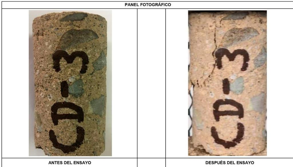
*Figura No. 23: Resistencia a la compresión. Estructura: columna piso 2.*
