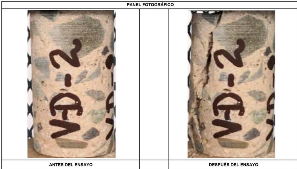
*Figura No. 22: Resistencia a la compresión. Estructura: viga piso 3.*
