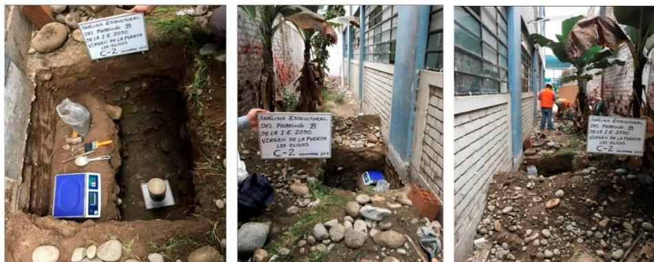
Foto N°05: Vista del ejecución del ensayo de densidad natural, donde se aprecia también el material granular existente en la zona.
