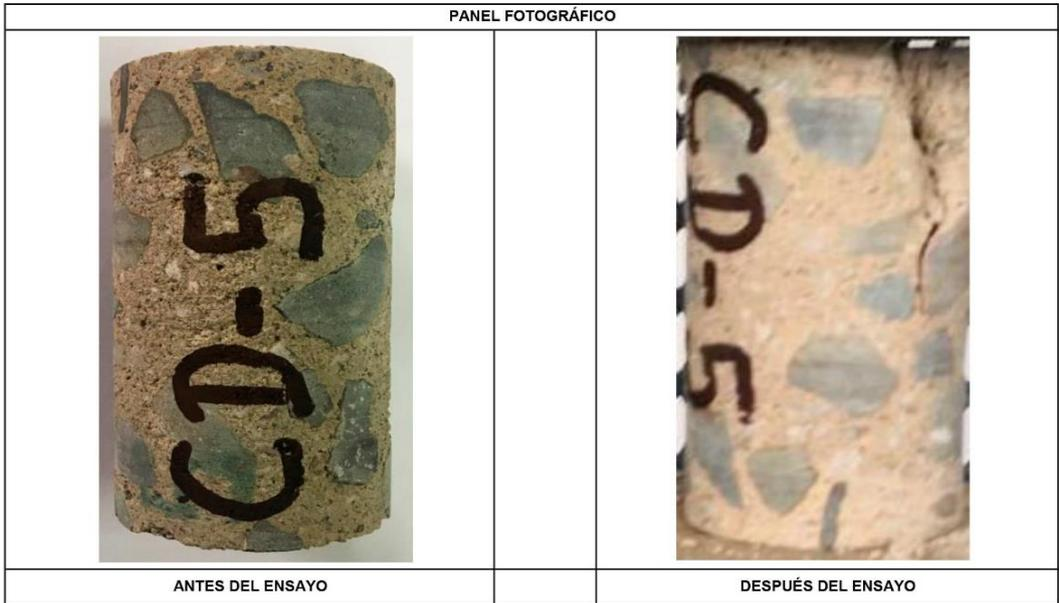
*Figura No. 25: Resistencia a la compresión. Estructura: columna piso 1.*
