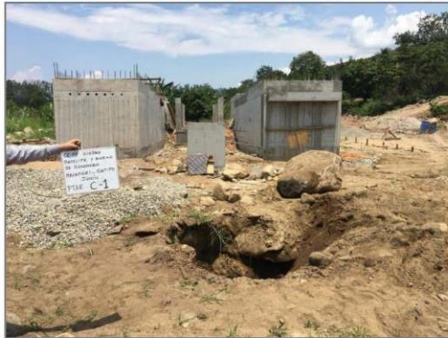
Panel 2.- Ubicación e interior de la calicata C-1, de naturaleza arenosa gravosa. Se aprecia la ejecución del ensayo de densidad de campo por cono de arena.
