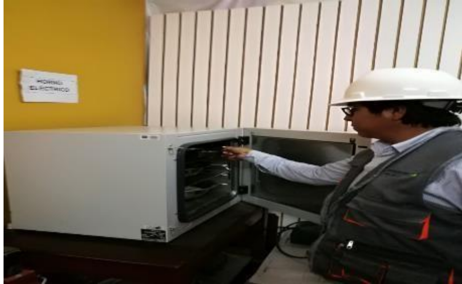
Foto 5. Determinación del contenido de humedad.
