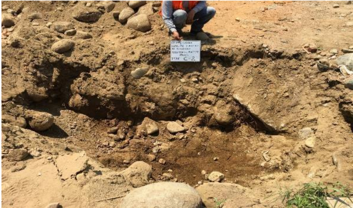
Panel 3.- Vistas de la ubicación en interior de la calicata C-2 mostrando el interior de los suelos presentes.
