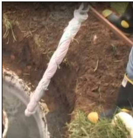
Figura 9: Palo con tela antes y después de introducirlo al tanque séptico
