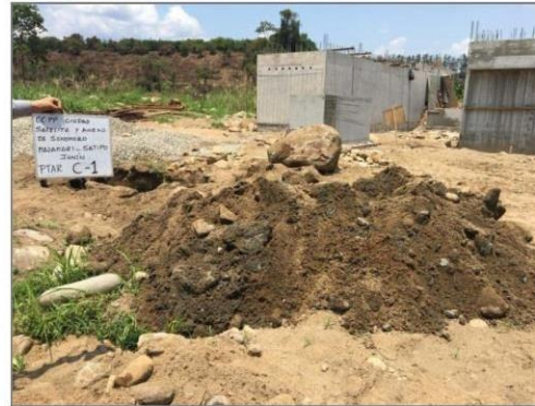
Panel 2.- Ubicación e interior de la calicata C-1, de naturaleza arenosa gravosa. Se aprecia la ejecución del ensayo de densidad de campo por cono de arena.
