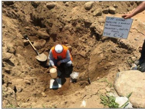
Panel 3.- Ubicación e interior de la calicata C-2, de naturaleza gravosa arenosa. Se aprecia la ejecución del ensayo de densidad de campo por cono de arena.
