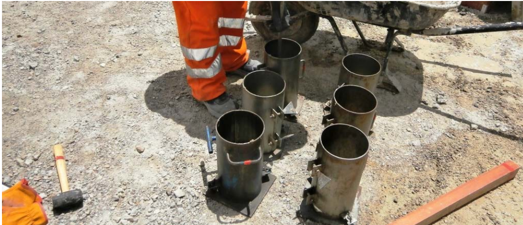
Figura 39: Ensayo de resistencia a la compresión probetas de 4 x 8". Fuente: Elaboración propia
