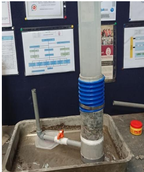
Figura 23. Permeámetro listo para ser usado. Fuente: Elaboración propia
