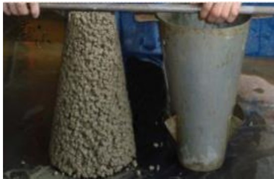
Figura 16. Obtención de trabajabilidad mediante el cono de Abrams. Fuente: tesis
