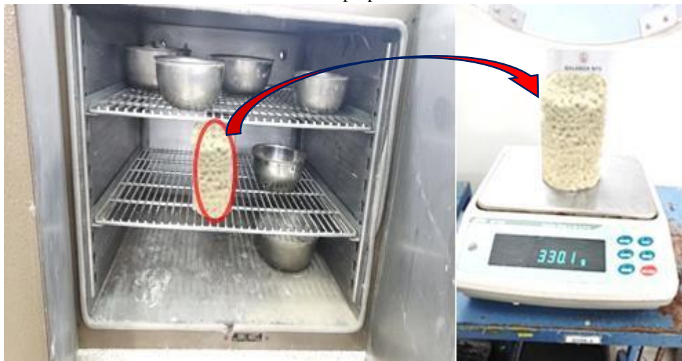
Figura 25. Secado y pesado del testigo. Fuente: Elaboración propia.
