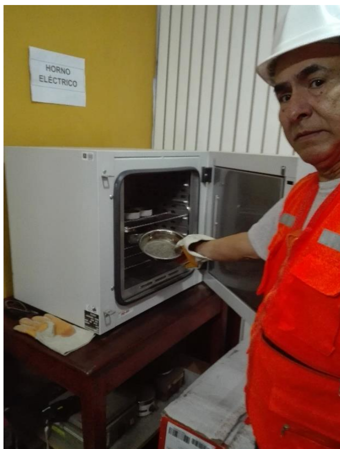
Figura 10. Secado de material en horno. Fuente: Elaboración propia
