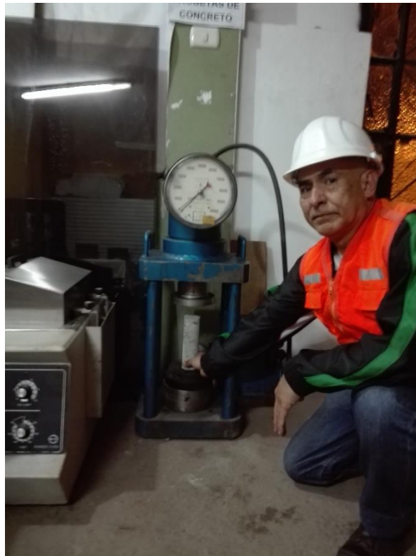
Figura 20. Proceso de rotura de probeta y probeta. Fuente: Elaboración propia.
