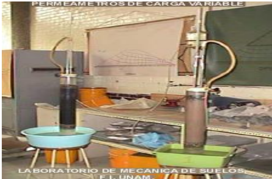
Figura 21. Elaboración del permeámetro de carga variable (ACI 522). Fuente: modelo de tesis.
