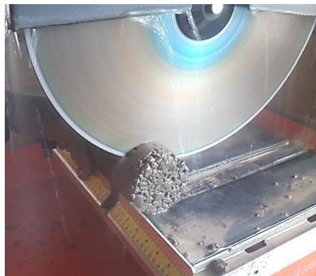
Figura 22. Proceso de corte de briqueta. Fuente: Elaboración propia
