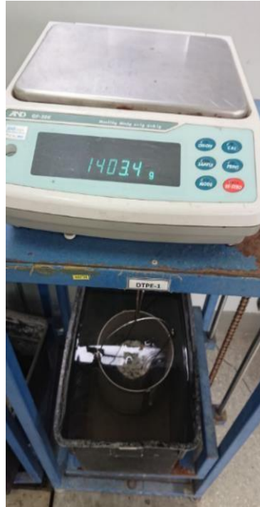
Figura 26. Saturación del testigo de concreto permeable. Fuente: Elaboración propia
