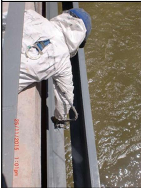
MEDICIÓN DE ESPESORES EN VIGA DE PLATAFORMA
