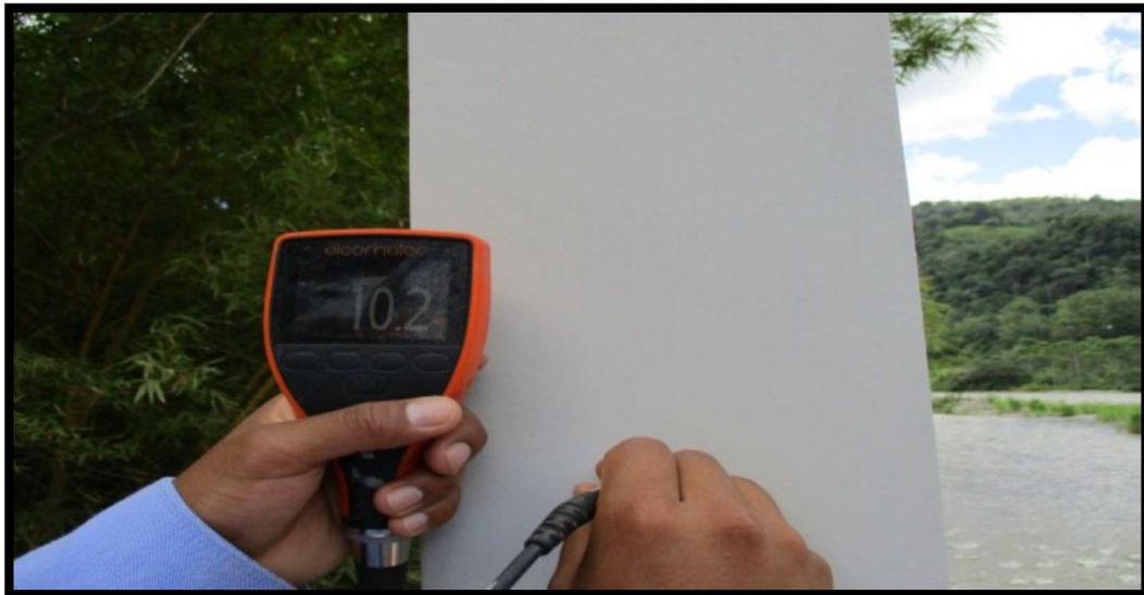
*Figura 18.* Medidor de espesor de pintura con ELCOMETER
