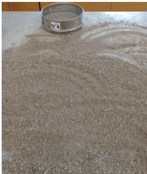
Figura 44. Muestra tamizada en la malla N°4. Fuente: Elaboración Propia
