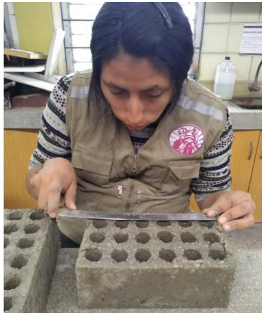
Figura 61. Medida del largo del Ladrillo de Con Escoria de acero. Fuente: Elaboración Propia
