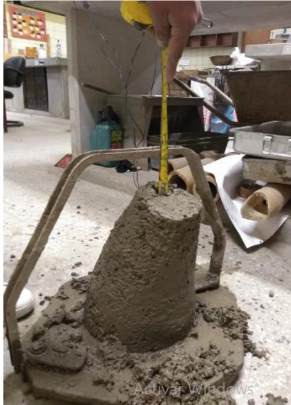
Figura 60. Verificación del Slump. Fuente: Elaboración Propia
