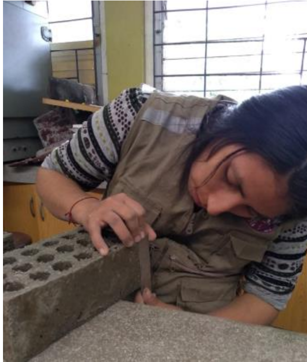
Figura 62. Medida del alto del Ladrillo de C. con Escoria de acero. Fuente: Elaboración Propia
