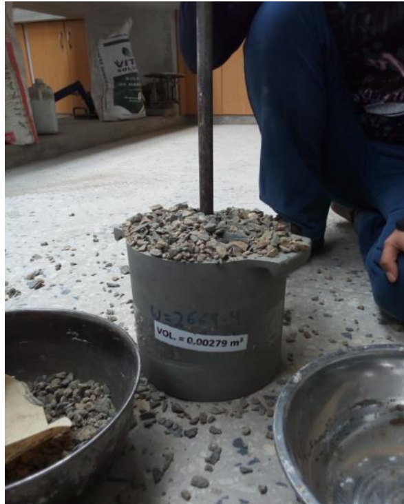
Figura 38. Tercera capa compactada. Fuente: Elaboración Propia
