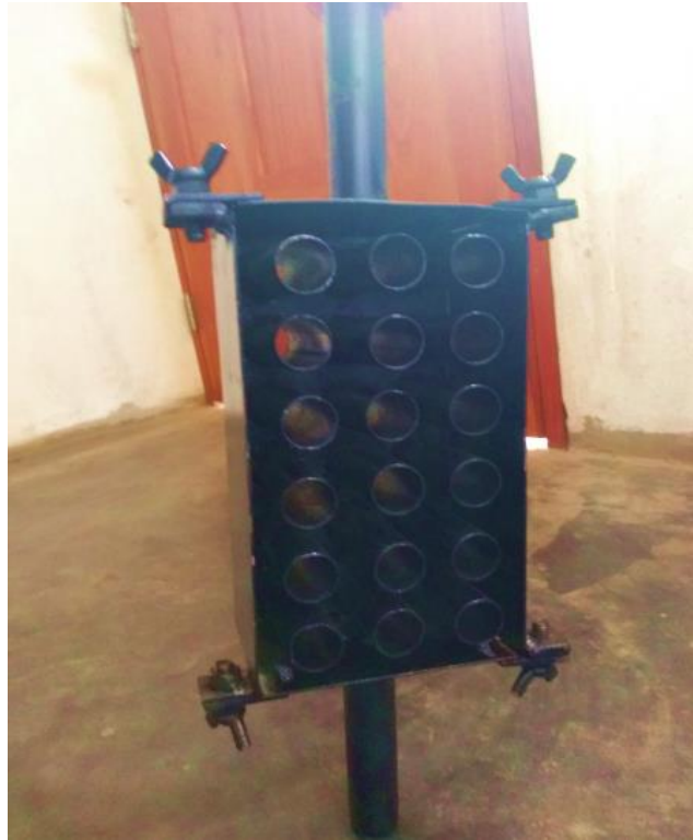
Figura 22. Molde de ladrillo. Fuente: Elaboración Propia
