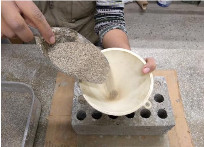
Figura 66. Llenado de la alveolos con arena graduada. Fuente: Elaboración Propia
