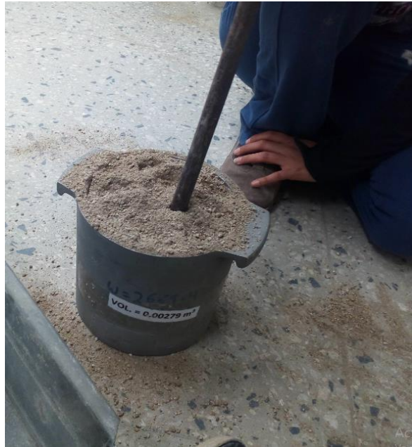
Figura 34. Tercera capa del Compactado Final. Fuente: Elaboración Propia
