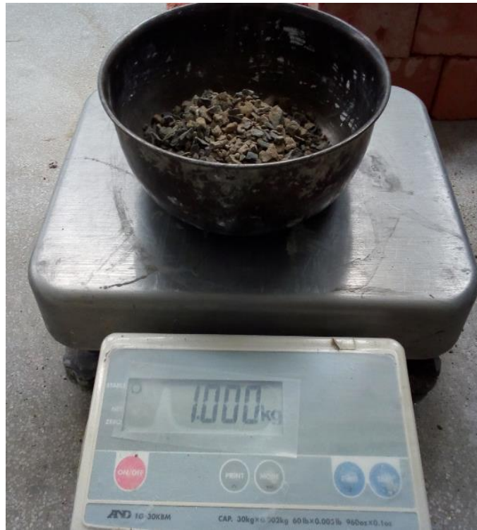
Figura 30. Peso del A.G para el tamizado. Fuente: Elaboración Propia
