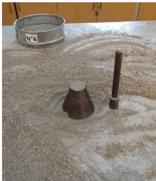
Figura 45. Muestra en el Molde Cónico. Fuente: Elaboración Propia
