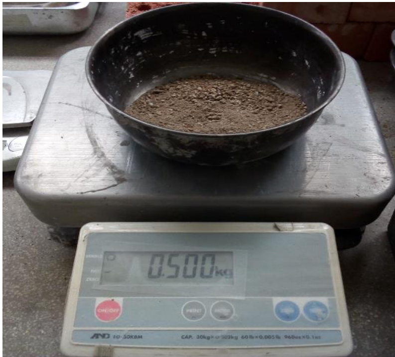
Figura 26. Muestra pesada para el tamizado. Fuente: Elaboración Propia
