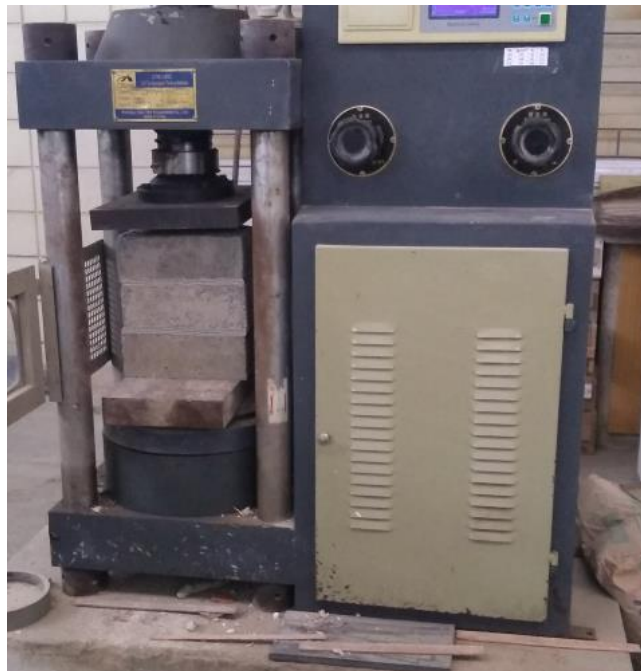
Figura 67. Rotura en la máquina de compresión por pila. Fuente: Elaboración Propia
