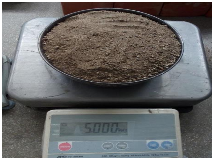
Figura 23. Peso del Agregado Fino. Fuente: Elaboración Propia
