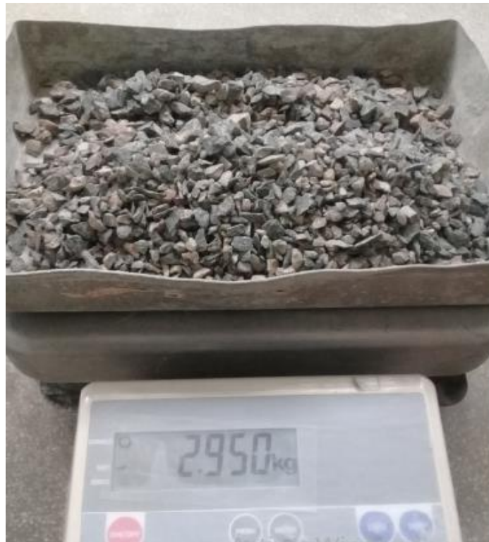
Figura 54. Peso de la muestra sacada en el horno. Fuente: Elaboración Propia
