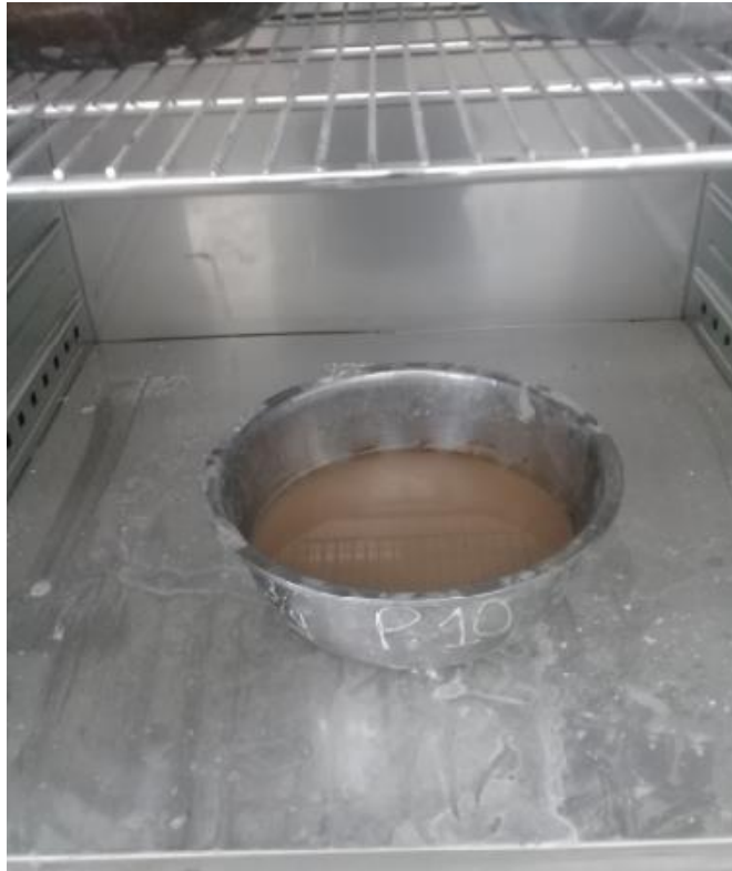
Figura 50. Secado de la muestra en el horno. Fuente: Elaboración Propia
