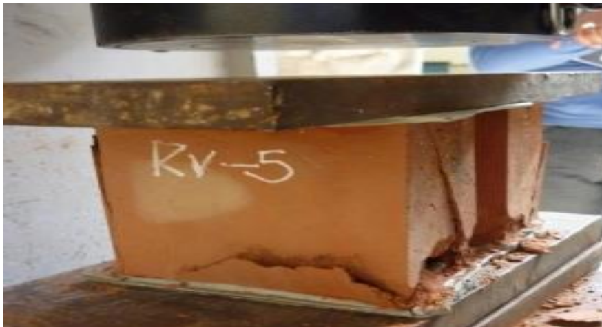
Figura 3: Resistencia a la compresión por Unidad. Fuente: Ensayos a la Unidad de Albañilería.
