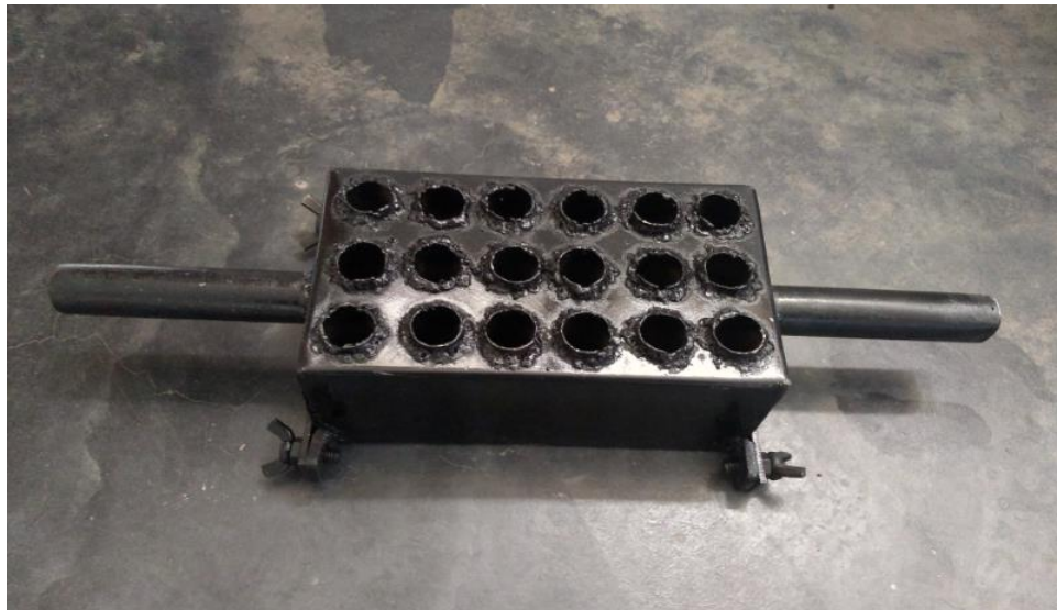
Figura 21. Molde de ladrillo. Fuente: Elaboración Propia
