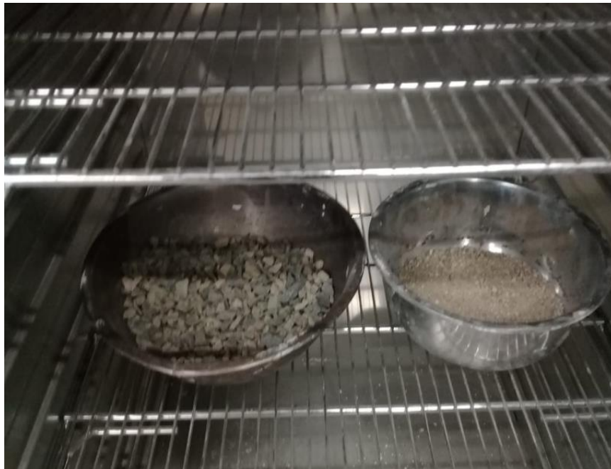
Figura 57. Muestra en el horno para el secado. Fuente: Elaboración Propia
