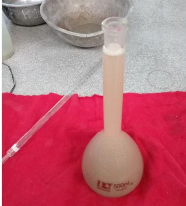
Figura 48. Muestra del agregado dentro del Picnómetro. Fuente: Elaboración Propia
