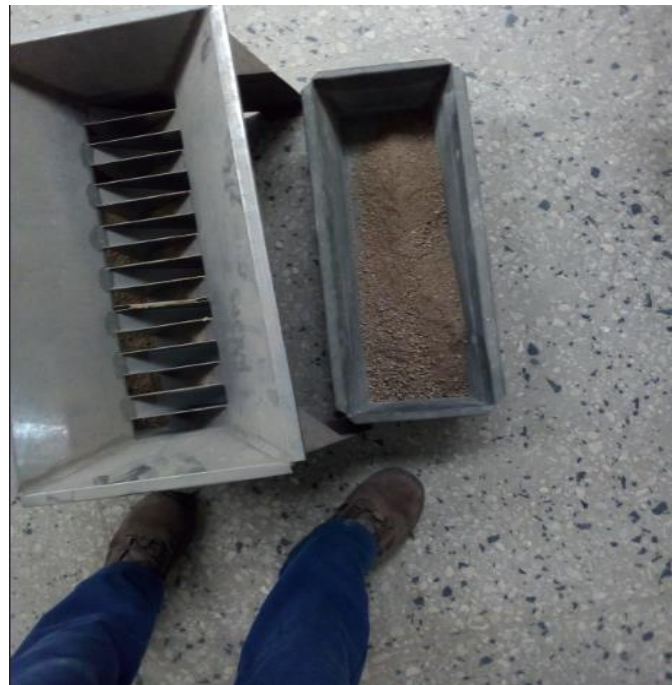
Figura 25. Muestra cuarteada del A.F. Fuente: Elaboración Propia
