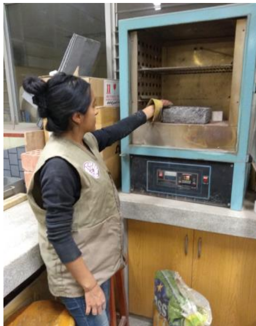
Figura 65. Secado del Ladrillo en el horno. Fuente: Elaboración Propia
