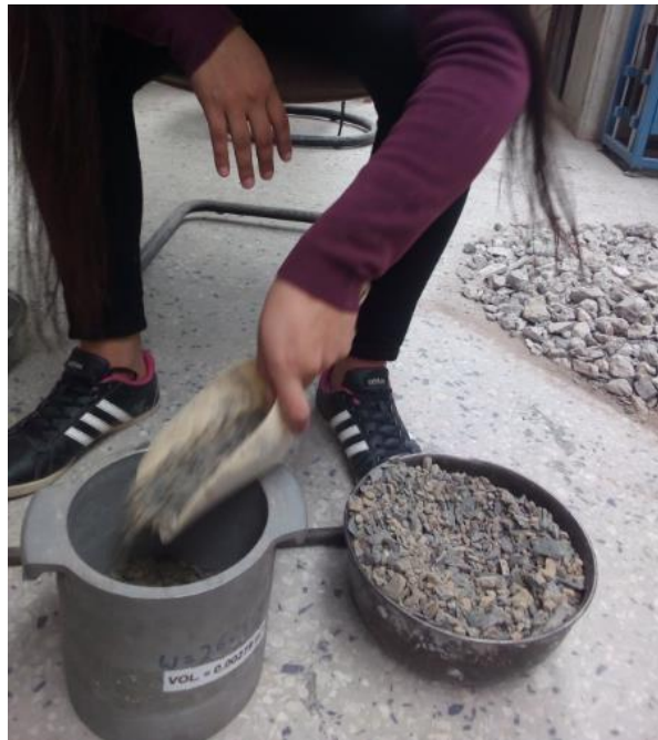
Figura 40. Colocación del A.G sin compactar. Fuente: Elaboración Propia
