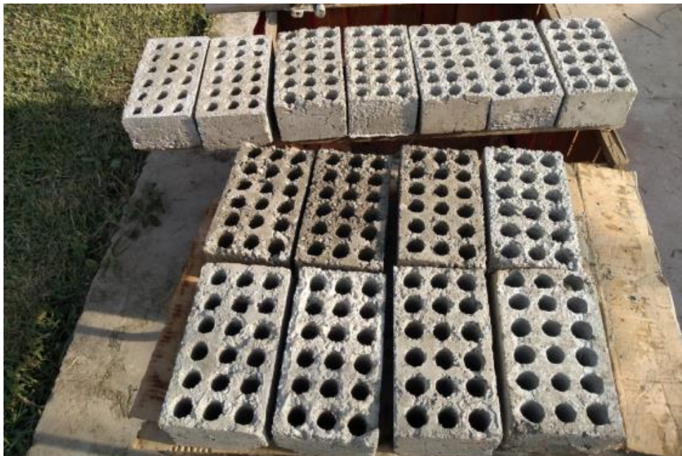
Figura 69. Ladrillos realizados con molde de metal. Fuente: Elaboración Propia
