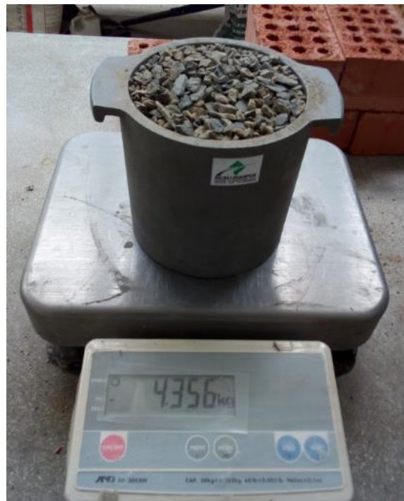
Figura 39. Peso del A.G compactado. Fuente: Elaboración Propia
