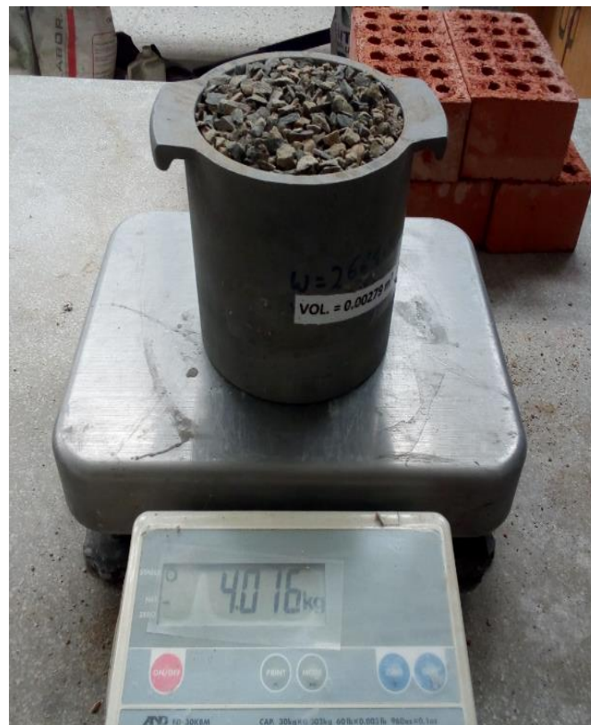
Figura 40. Colocación del A.G sin compactar. Fuente: Elaboración Propia
