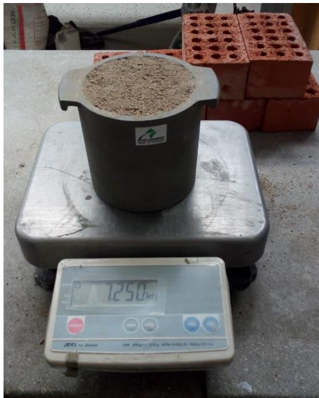
Figura 35. Peso del A.F compactado. Fuente: Elaboración Propia
