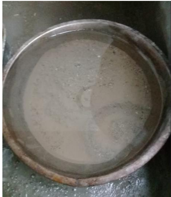
Figura 42. Muestra remojada (24h) del A.F. Fuente: Elaboración Propia
