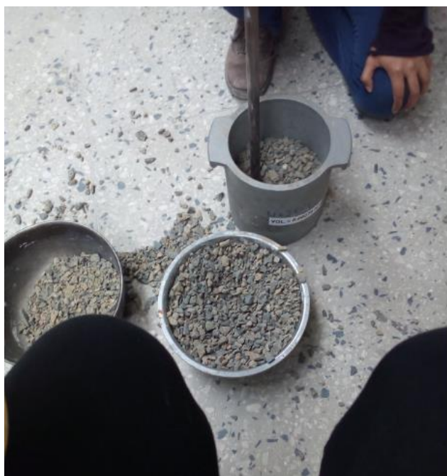
Figura 37. Material del A.G a compactarse. Fuente: Elaboración Propia
