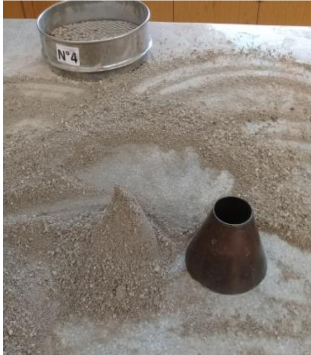
Figura 46. Muestra alcanzada a la condición de la superficie seca. Fuente: Elaboración Propia
