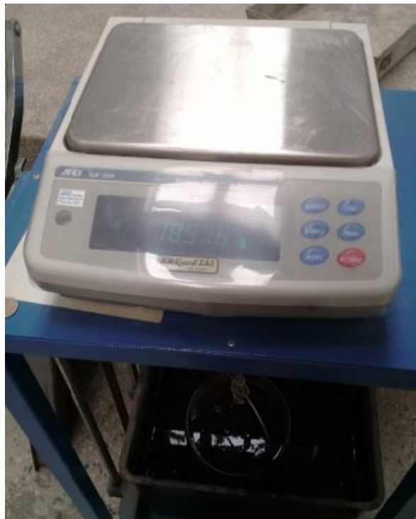
Figura 53. Muestra sumergida en la cesta. Fuente: Elaboración Propia
