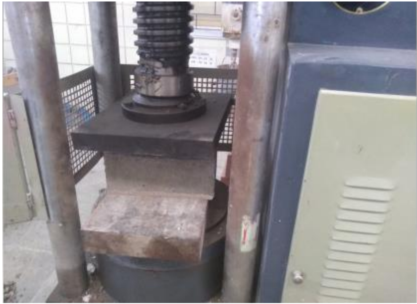
Figura 68. Rotura en la máquina de compresión por unidad. Fuente: Elaboración Propia
