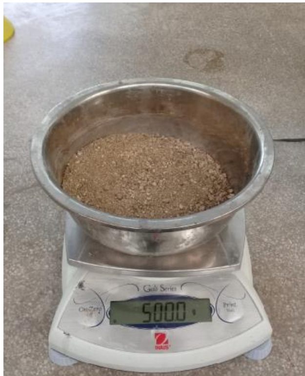
Figura 47. Peso de la muestra para el ensayo de % de Absorción. Fuente: Elaboración Propia
