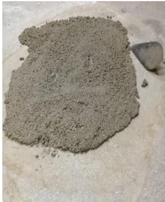
Figura 43. Muestra secada a la intemperie del A.F. Fuente: Elaboración Propia
