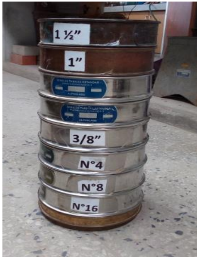
Figura 32. Mallas para el Tamizado del A.G. Fuente: Elaboración Propia
