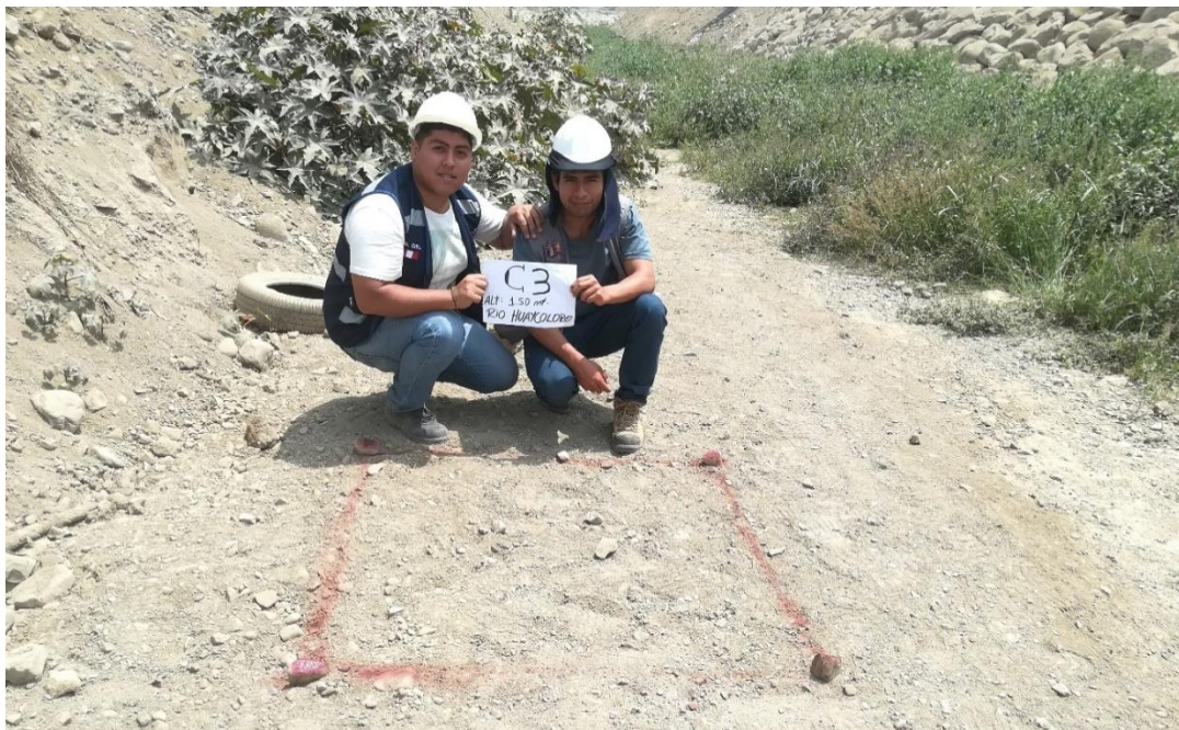
Imagen 14: Señalización de la calicata del equipo investigador C- 03 de 1.20 x 1.20
