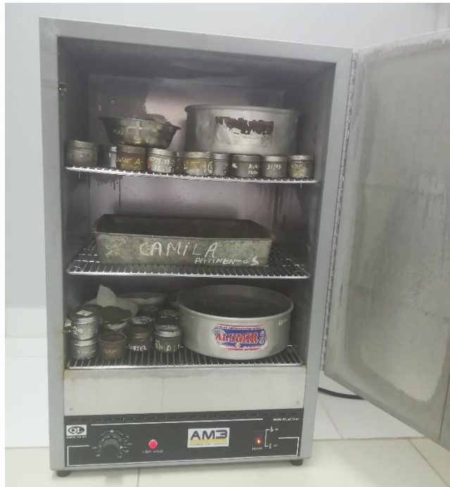
Imagen 19: Ejecución de gabinete – Contenido de Humedad
