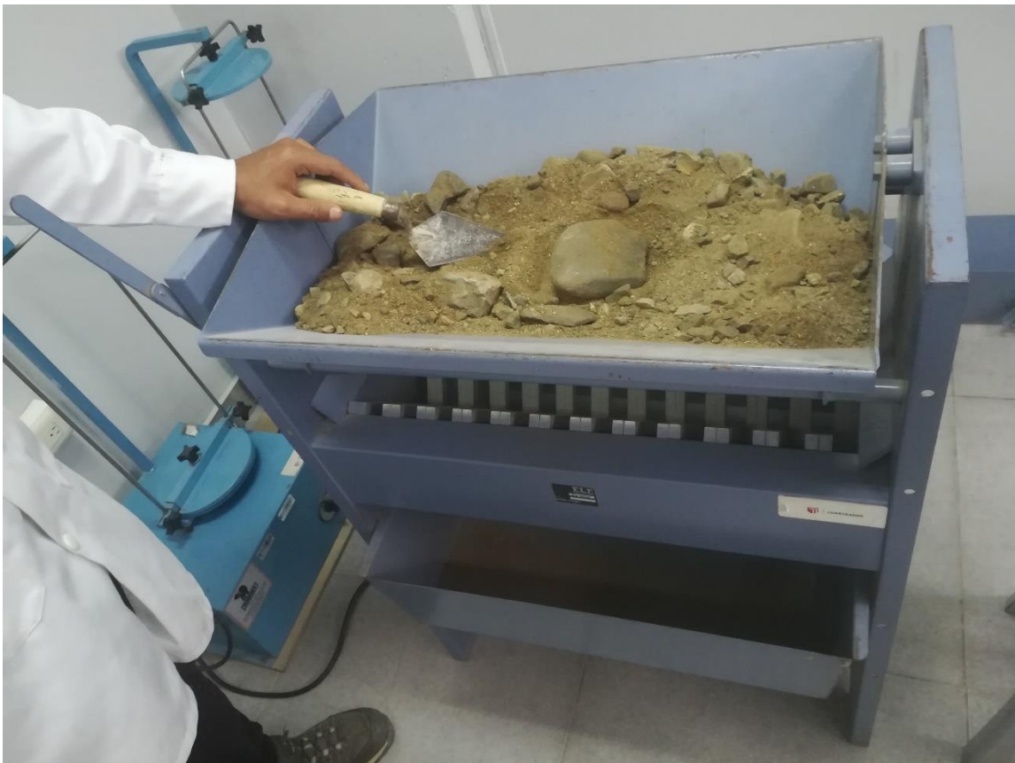
Imagen 18: Ejecución de gabinete - Cuarteo
