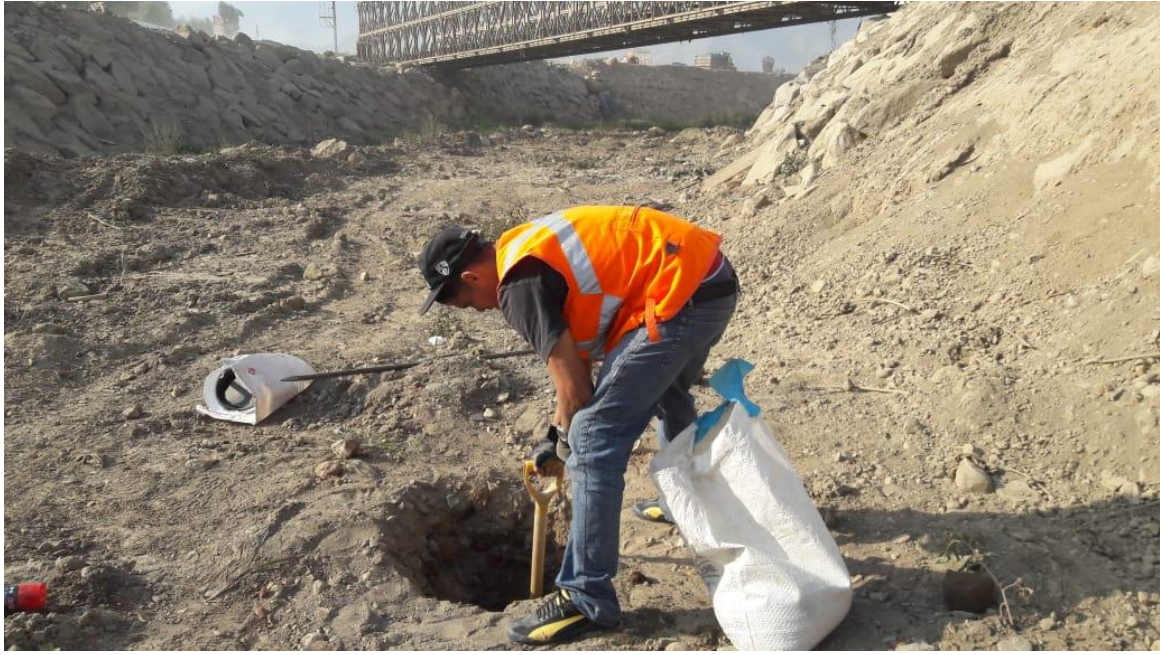
Imagen 17: Obtención de Muestra de suelo
