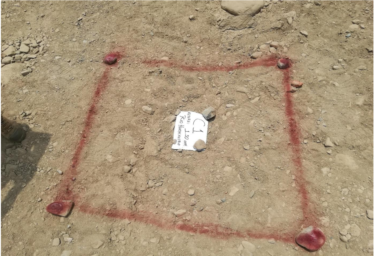
Imagen 11: Señalización de las calicata C- 01 de 1.20 x 1.20 mts
