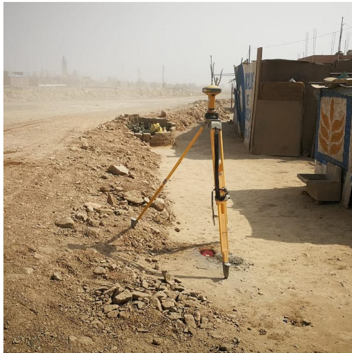
Imagen 2: Toma de puntos de coordenadas de GPS.
