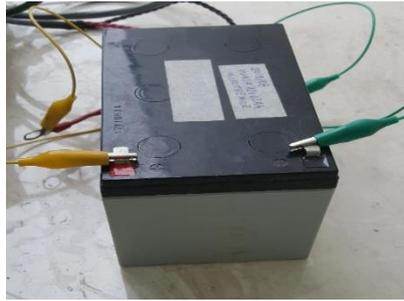
Figura 103. Bateria de 12v que alimenta al Digitalizador
