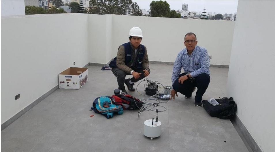
A-13. Evaluación del punto N°01 mediante el ensayo de microtremos
