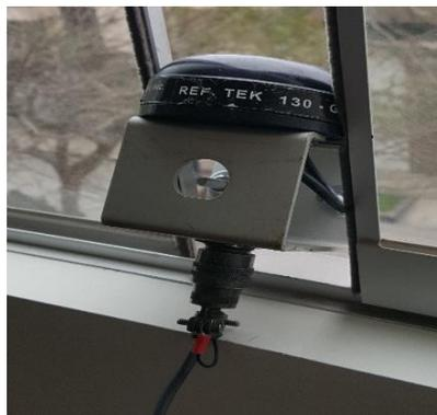
*Figura 102.* Antena de recepción de Coordenadas y Tiempo
