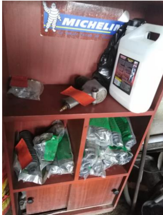
Figura 20. Ejecución de las tarjetas rojas Fuente: Elaboración propia
