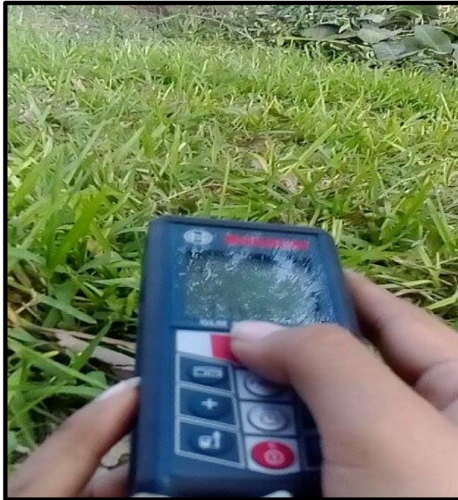
Fuente: Elaboración propia (datos de campo) Figura 6. Medición de altura con wincha laser
