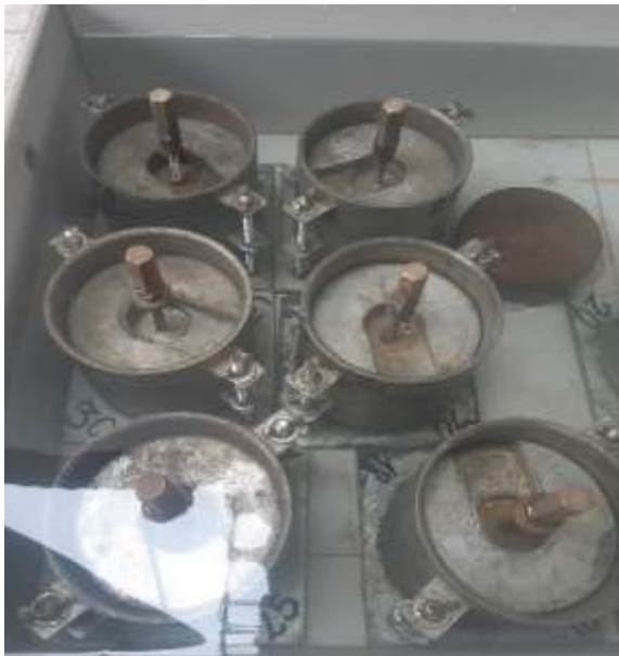
Foto N°23 Se sumergen por 96 horas los moldes CBR, Suelo Natural. Fuente: Elaboración Propia
