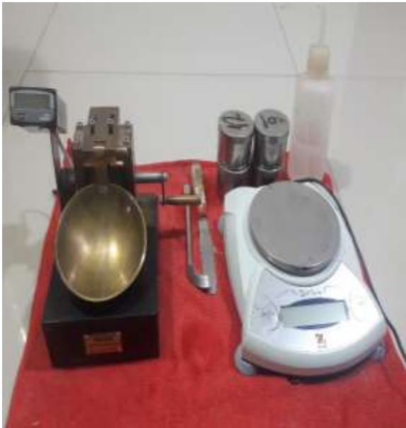
Foto N°15 Copa Casa Grande para realizar el Límite Líquido. Fuente: Elaboración Propia
