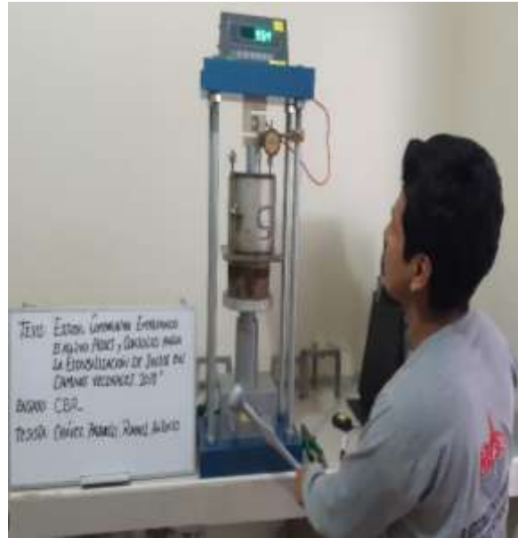
Foto N°24 Penetrando en la Prensa CBR, Suelo Natural. Fuente: Elaboración Propia
