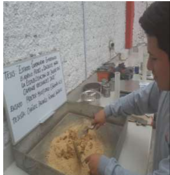
Foto N°20 Realizando el ensayo Proctor Modificado, Suelo Natural.
