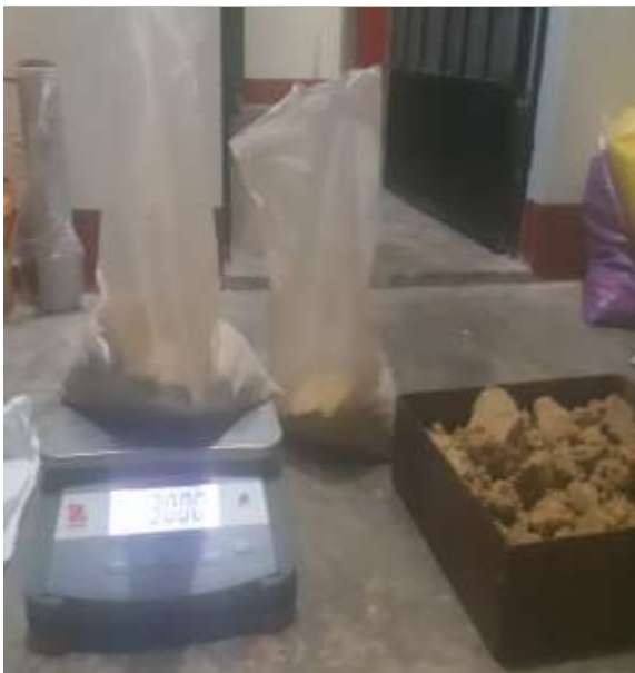
Foto N°18 Se realiza el pesaje de la muestra para realizar el ensayo Proctor Modificado y CBR.
