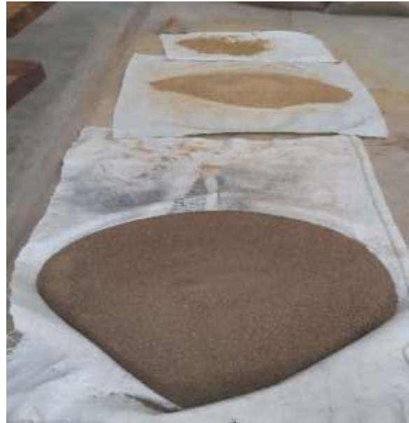
Foto N°18 Se disgrega el material natural para realizar el ensayo Proctor Modificado y CBR.
