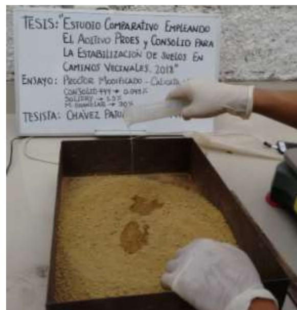
Foto N°28 Aplicando CONSOLID 444 luego se emplea el aditivo SOLIDRY. Fuente: Elaboración Propia
