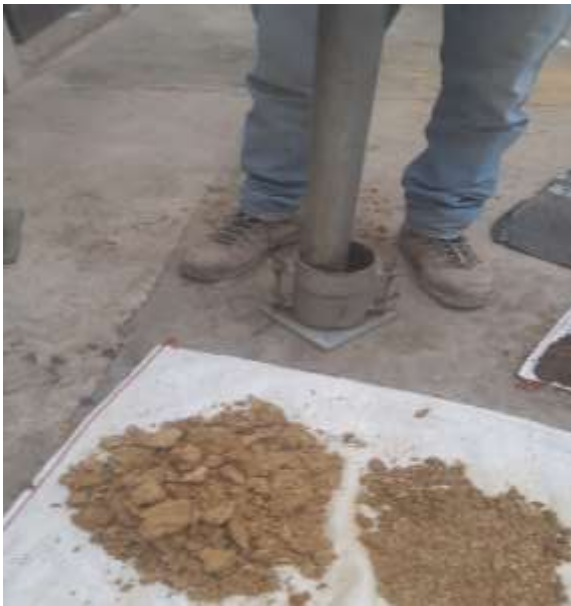
Foto N°21 Realizando el ensayo Proctor Modificado. Fuente: Elaboración Propia
