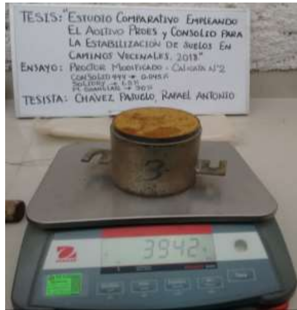
Foto N°30 Pesando luego de realizar 5 capas de 25 golpes para el Proctor Modificado Método "A" Fuente: Elaboración Propia
