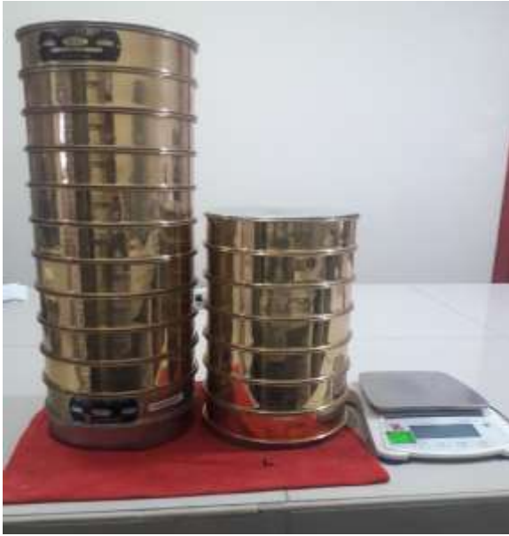
Foto N°13 Se realiza el ensayo de Granulometría, luego de haberlo lavado y secado Fuente: Elaboración Propia
