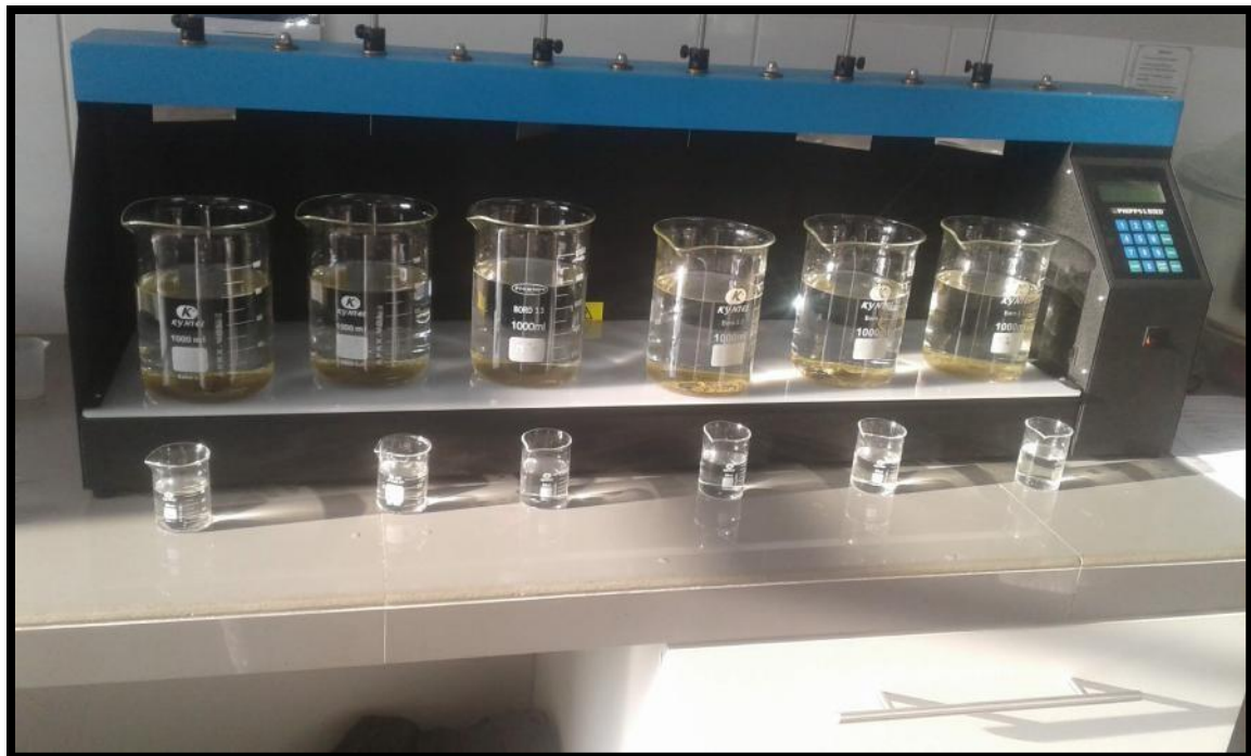
Foto 10: Las muestras de agua del Río Santa después del tratamiento de coagulación en el equipo de prueba de jarras.
