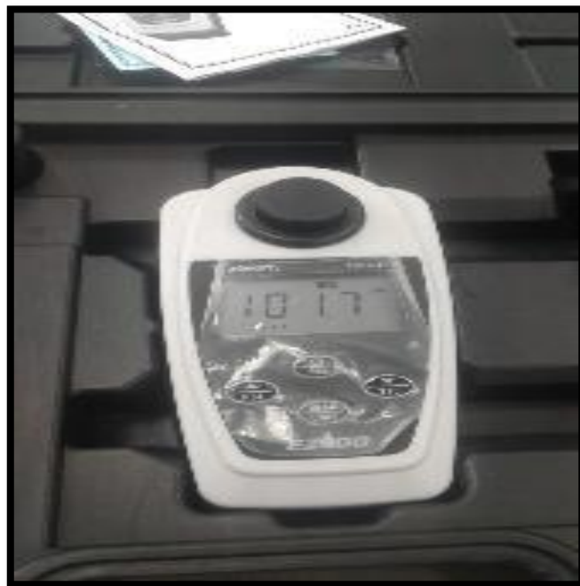
Foto 12: Medición de la turbiedad inicial de la muestra recogida del Rio Santa.
