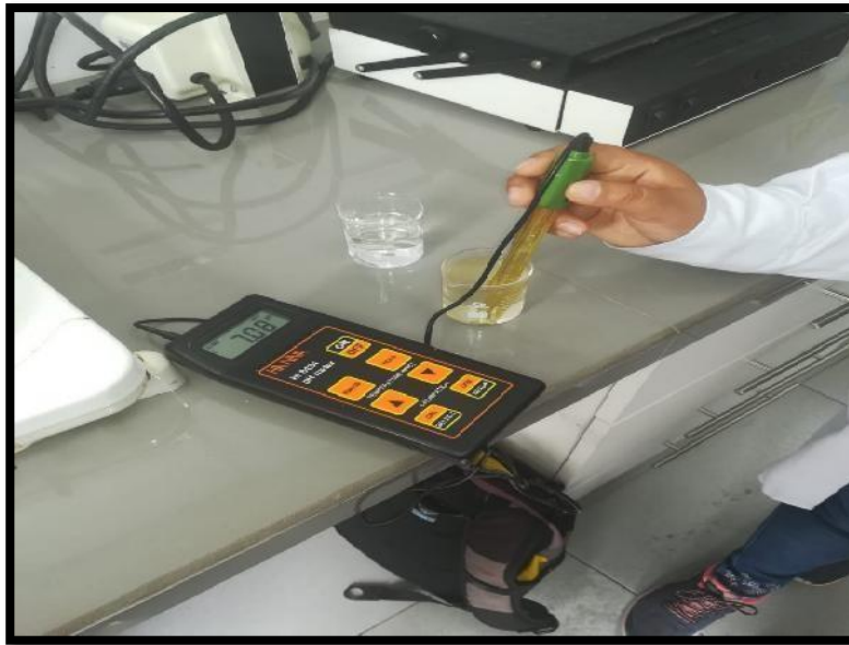
Foto 13: Medición del pH de cada muestra después del tratamiento en el test de jarras
