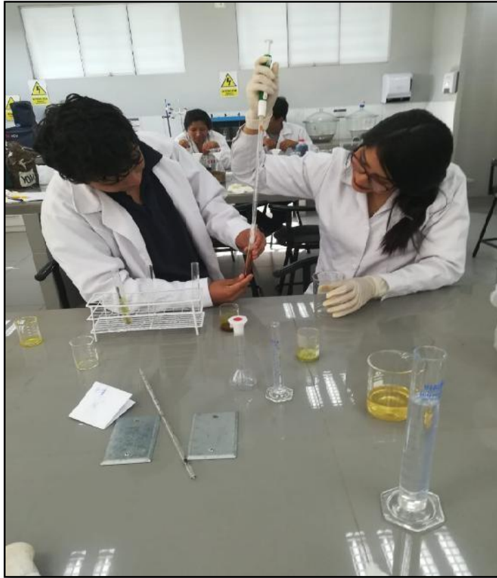
Foto 5: Tomando una alícuota de 1.5 ml de cloruro férrico para preparar el coagulante a una concentración de 500 ppm.
