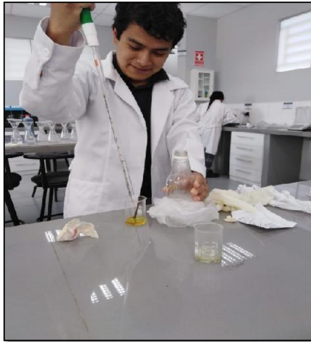
Foto 3: Añadiendo ácido clorhídrico concentrado a la viruta de chatarra de hierro.
