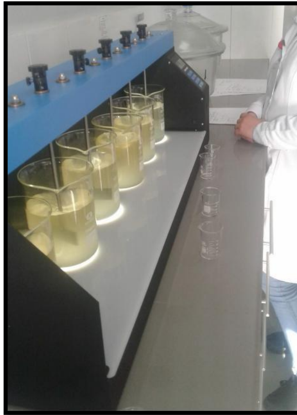
Foto 9: Muestras durante el proceso de coagulación con quitosano.
