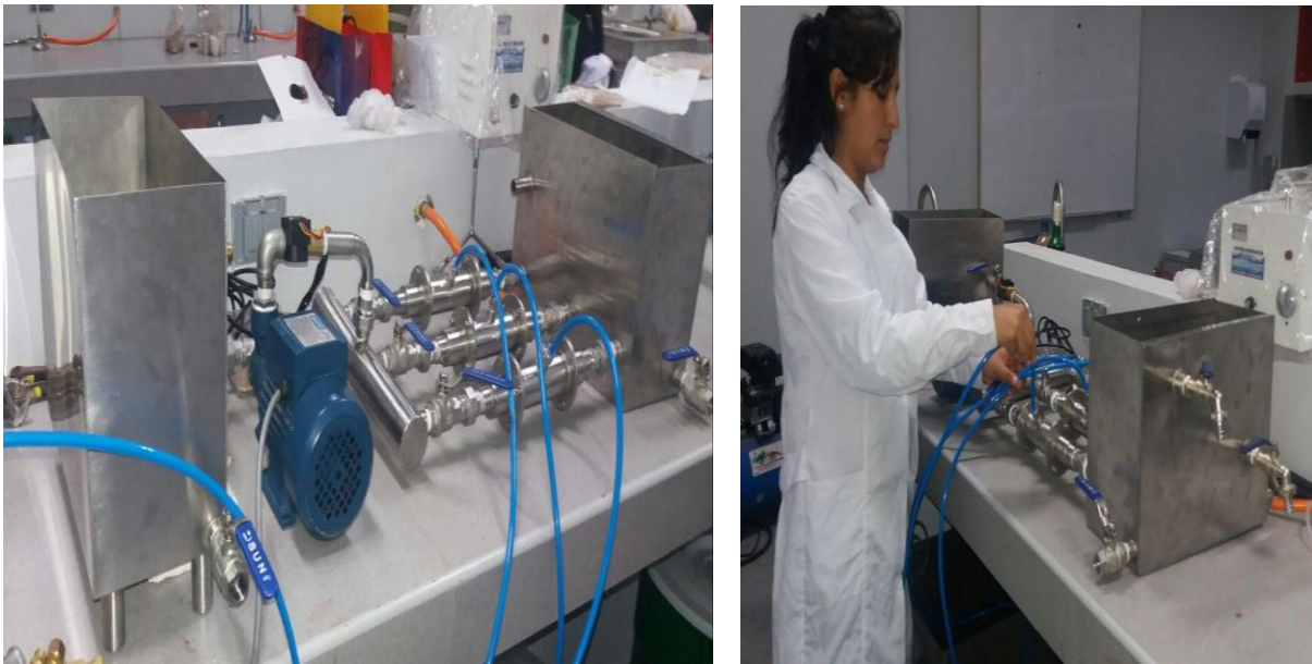
Figura 7. Dispositivo generador de micro nano burbujas
