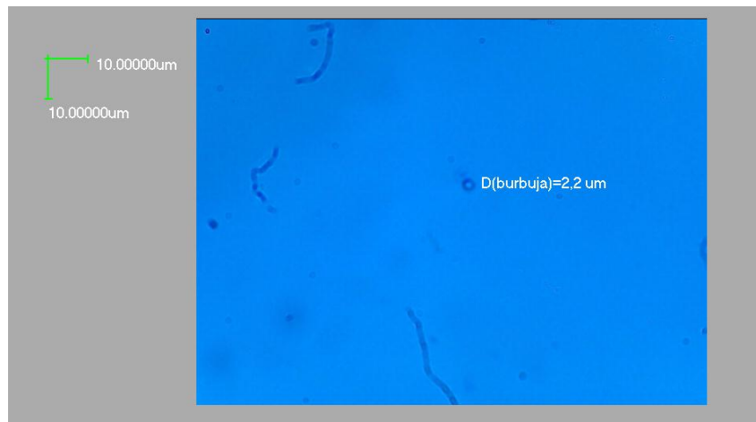
Figura 10. Tamaño de las burbujas determinado a través de un microscopio
