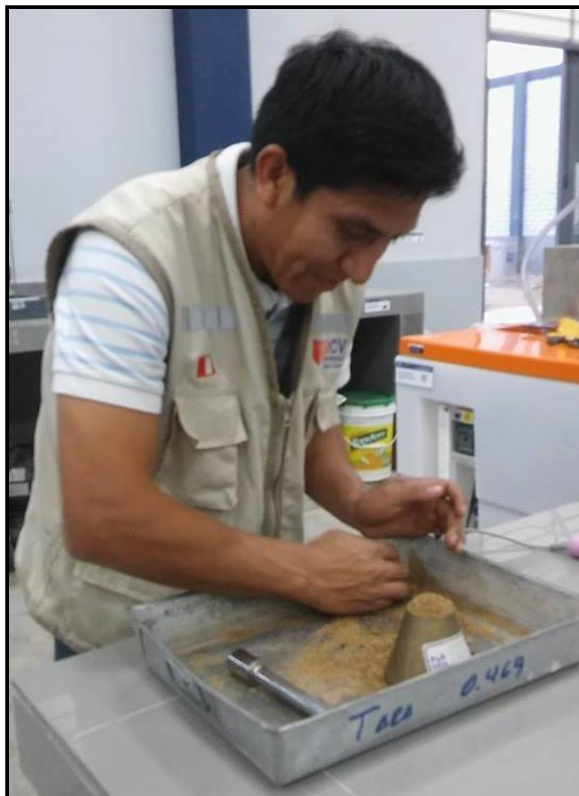
Figura 3: Gravedad específicas y absorción del agregado fino.
