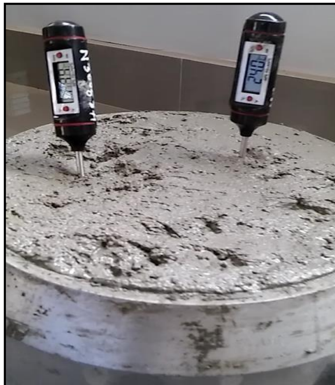
Figura 24: Temperatura del concreto.
