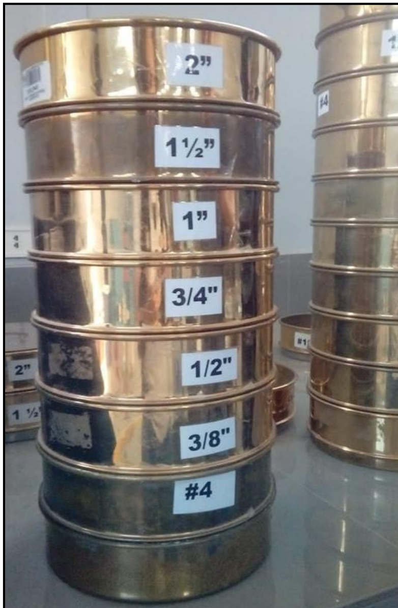
Figura 6: Juego de tamices para ensayo de granulometría
