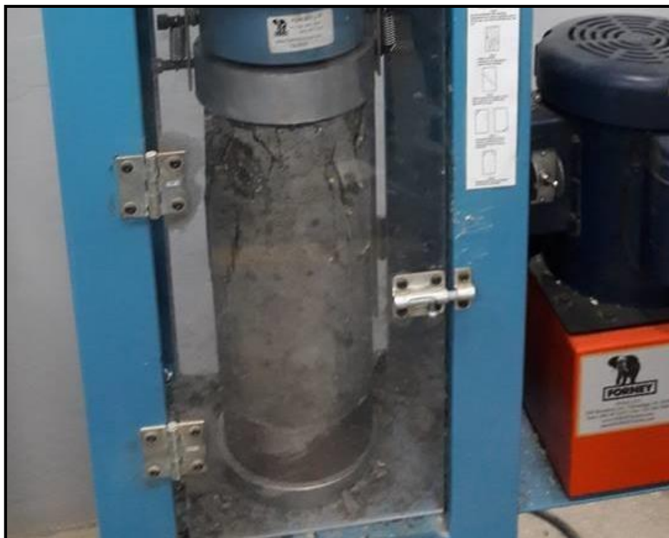
Figura 28: Reconocimiento de fallas en probetas - Laboratorio Mecánica de Suelos.
