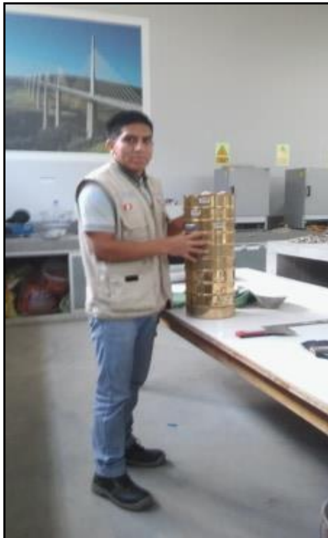
Figura 2: Juego de tamices para ensayo de granulometría
