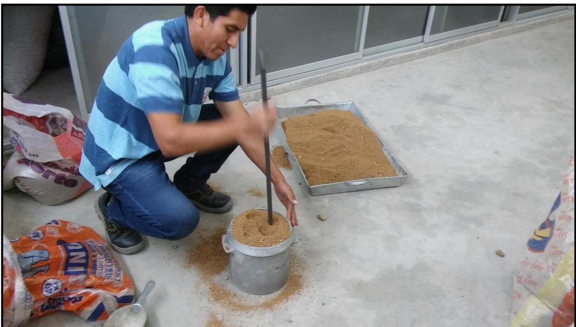
Figura 20: Peso unitario compactado o varillado agregado fino.
