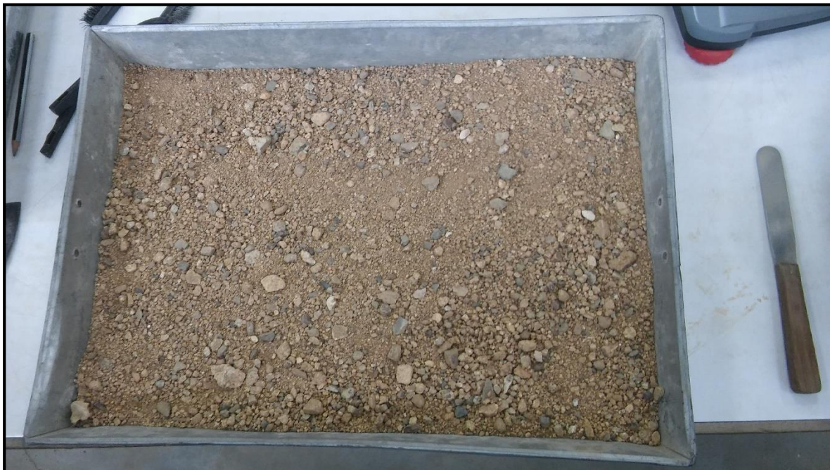
Figura 16: Agregado fino seco al horno para el ensayo Ganulométrico.
