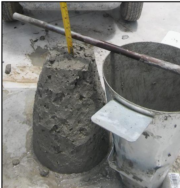
Figura 22: Trabajabilidad concreto patrón (SLUMP).
