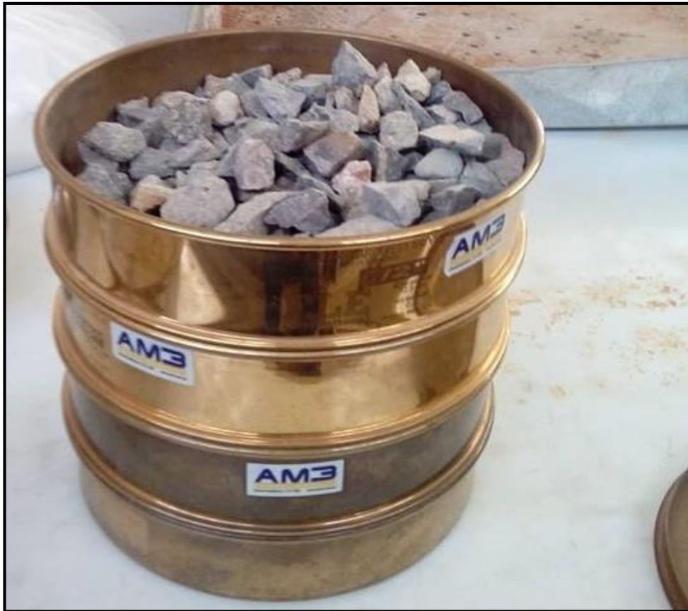
Figura 15: Ganulometría agregado grueso (tamizado).
