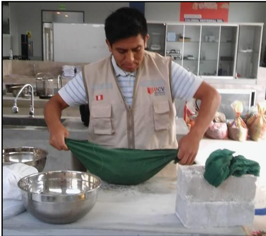
Figura 17: Peso específico del agregado grueso (secado superficial con franela)
