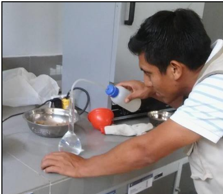
Figura 18: Peso específico del agregado Fino (llenado de agua destilada en la fiola)
