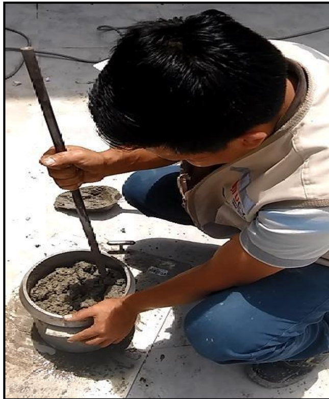
Figura 23: Ensayo del Peso unitario concreto patrón.
