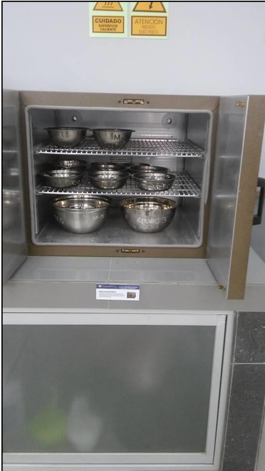
Figura 5: Colocación de muestra al horno para contenido de humedad
