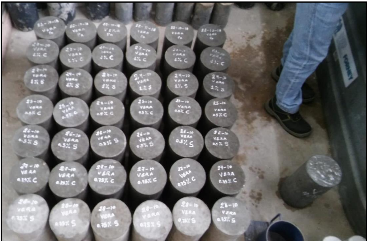
Figura 25: Total de probetas elaboradas y etiquetadas respectivamente.
