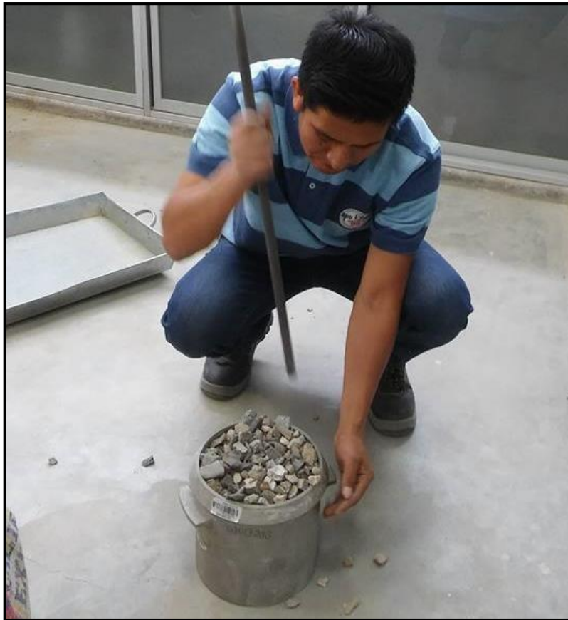
Figura 19: Peso unitario compactado o varillado agregado grueso.
