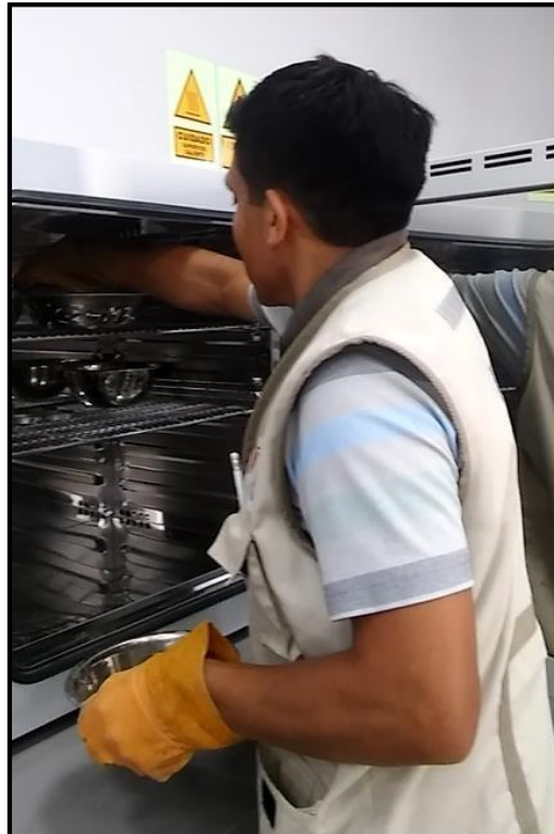
Figura 1: Colocación de muestra al horno para contenido de humedad
