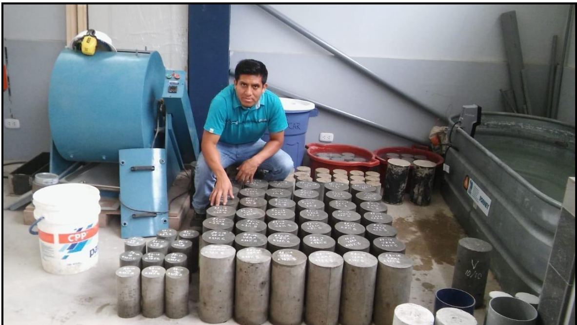
Figura 26: Total de probetas listo para el curado en tina de laboratorio.
