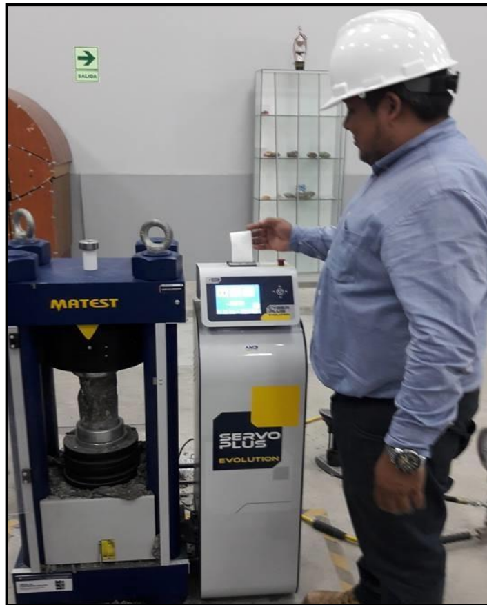
Figura 29: Fuerza a la compresión en probetas – Laboratorio Minas.
