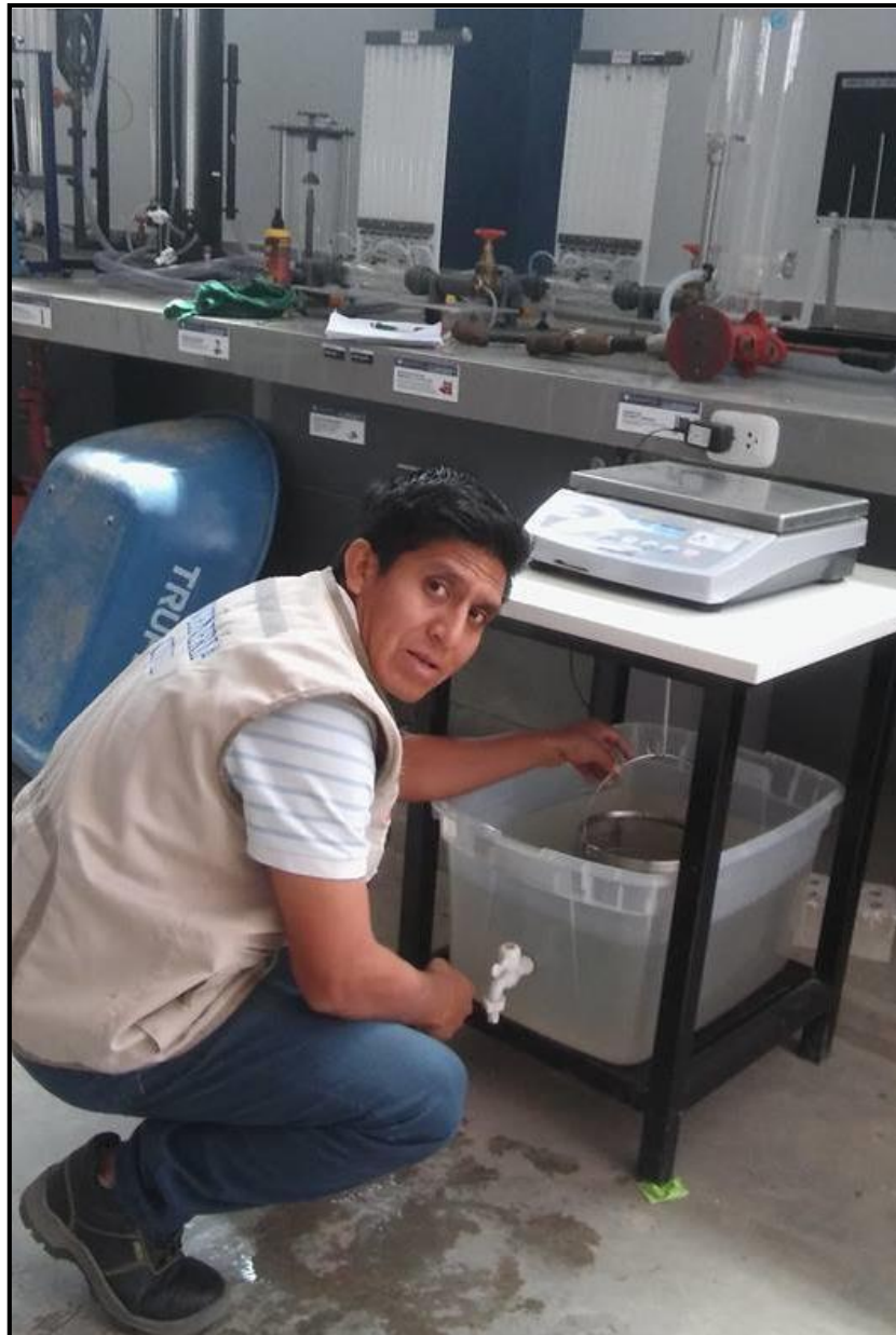
Figura 7: peso específico y absorción del agregado grueso
