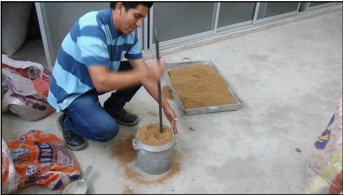
Figura 4: Peso unitario y compactado del agregado fino.
