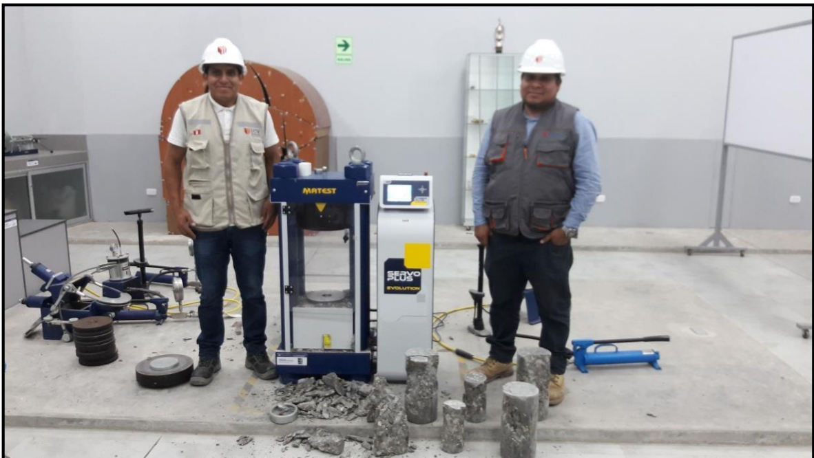
Figura 30: Reconocimiento de fallas en probetas - Laboratorio Mecánica de Suelos.
