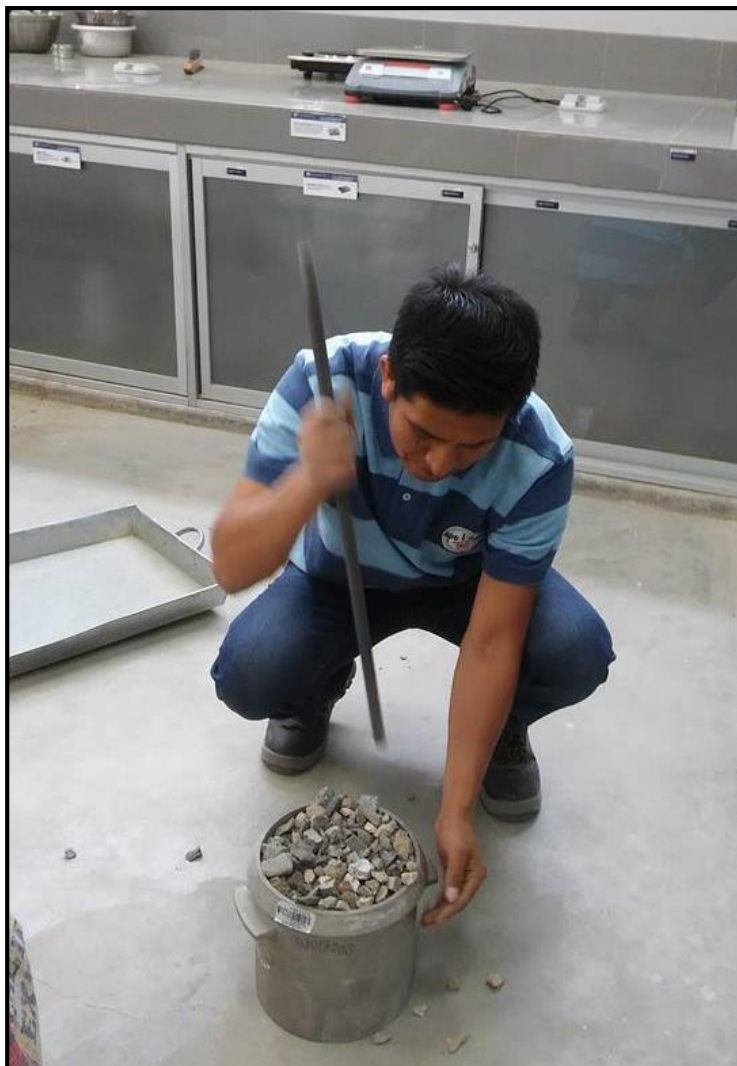
Figura 8: Peso unitario y compactado del agregado grueso.
