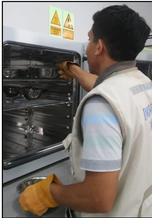
Figura 14: Colocación de muestras al horno para contenido de Humedad.
