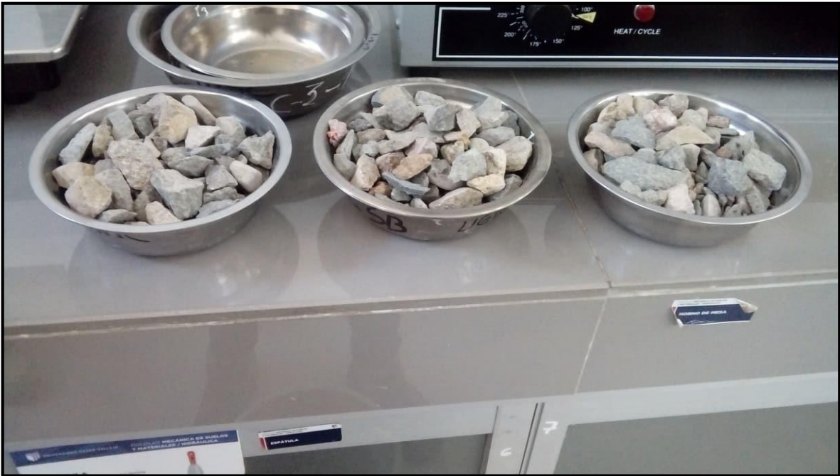
Figura 14: Colocación de muestras al horno para contenido de Humedad.
