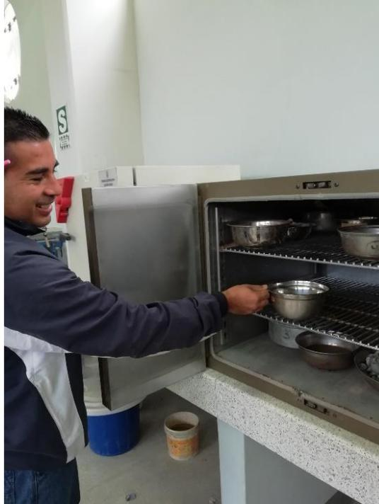
*Figura 11.* Determinación del contenido de humedad. (Fuente: Elaboración propia)
