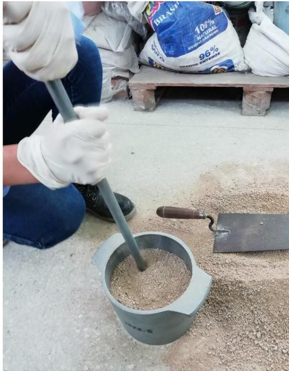
Figura 10. Determinación de peso unitario compactado. (Fuente: Elaboración propia)
