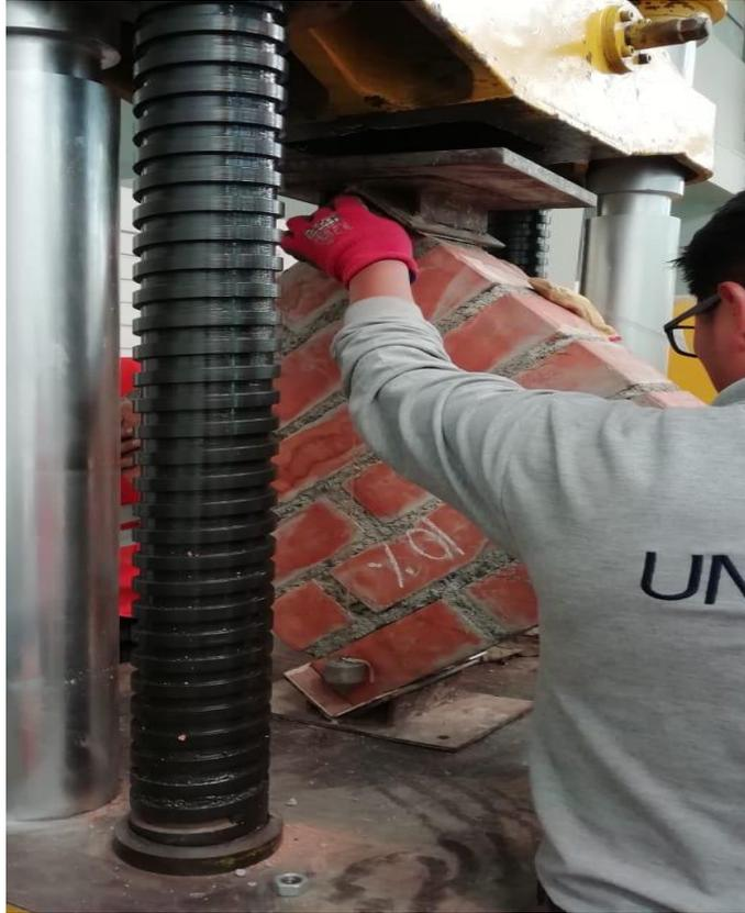
*Figura 20.* Armado del equipo para ensayo de compresión diagonal. (Fuente: Elaboración propia)
