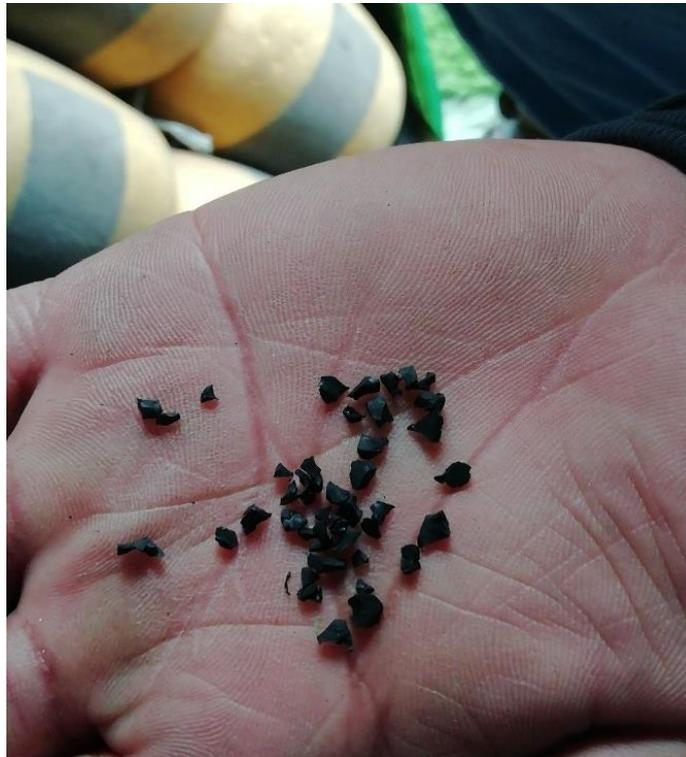
Figura 5. Grano de Caucho Reciclado (Fuente: Elaboración propia)
