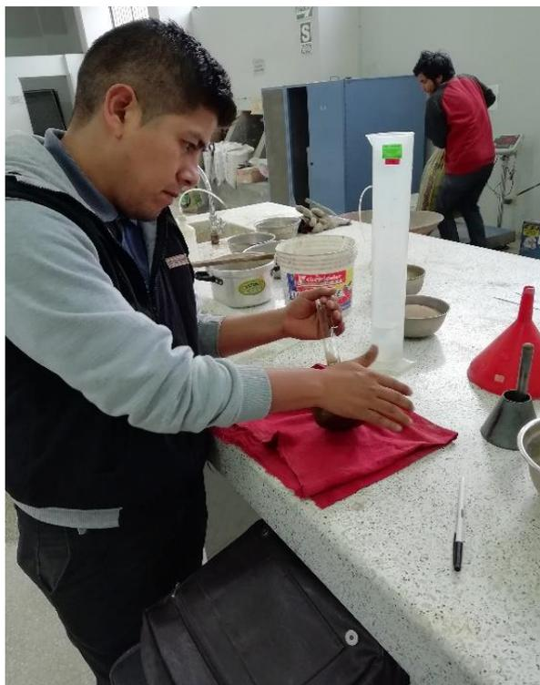
*Figura 8.* Determinación de peso específico y porcentaje de absorción (Fuente: Elaboración propia)
