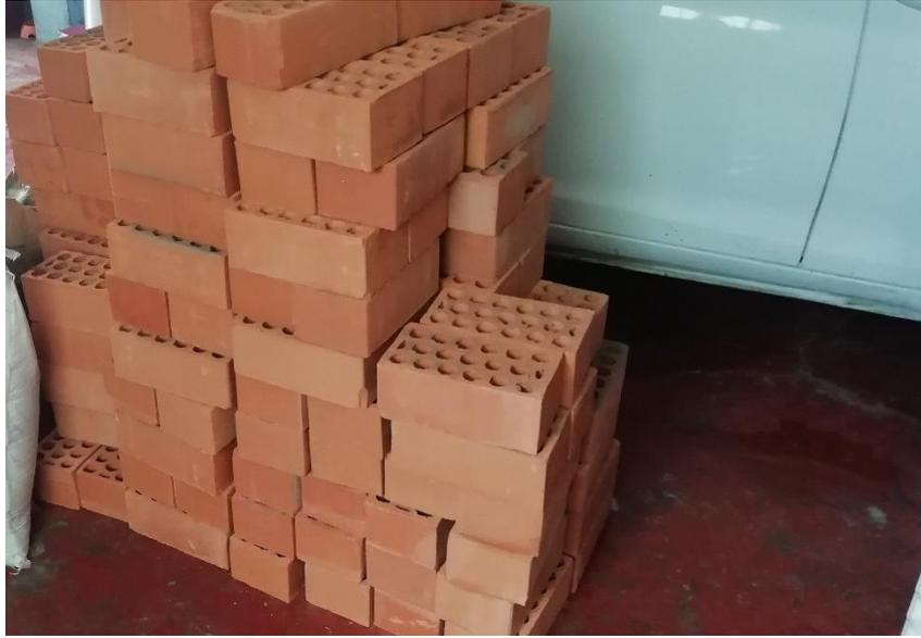
*Figura 12.* Ladrillo para muro portante 18 huecos. (Fuente: Elaboración propia)
