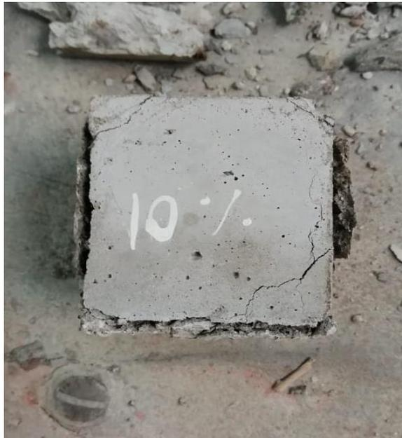
*Figura 28.* Rotura del mortero a compresión (Fuente: Elaboración propia)
