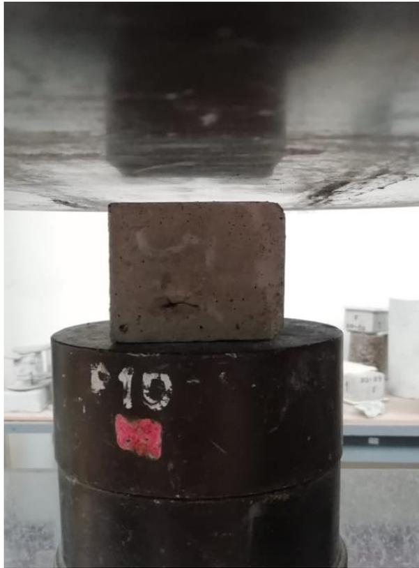
*Figura 27.* Cubo de mortero a compresión (Fuente: Elaboración propia)
