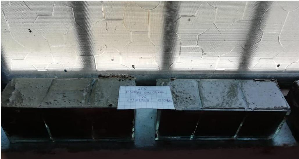
*Figura 24.* Cubitos de mortero con caucho al 5%. (Fuente: Elaboración propia)
