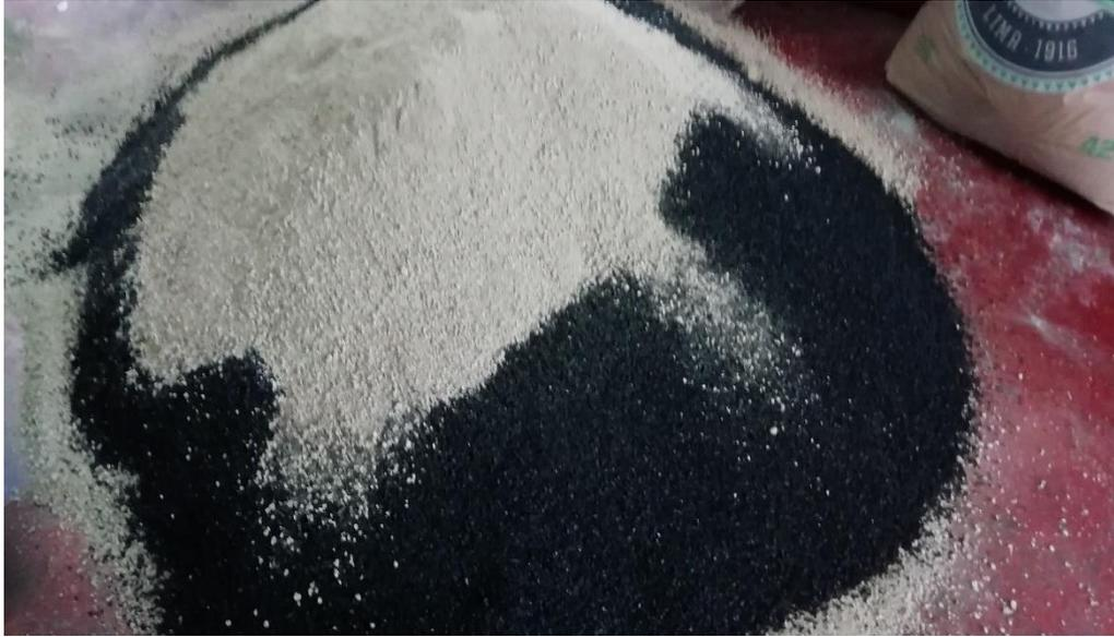
*Figura 13.* Mezcla de agregados con caucho. (Fuente: Elaboración propia)
