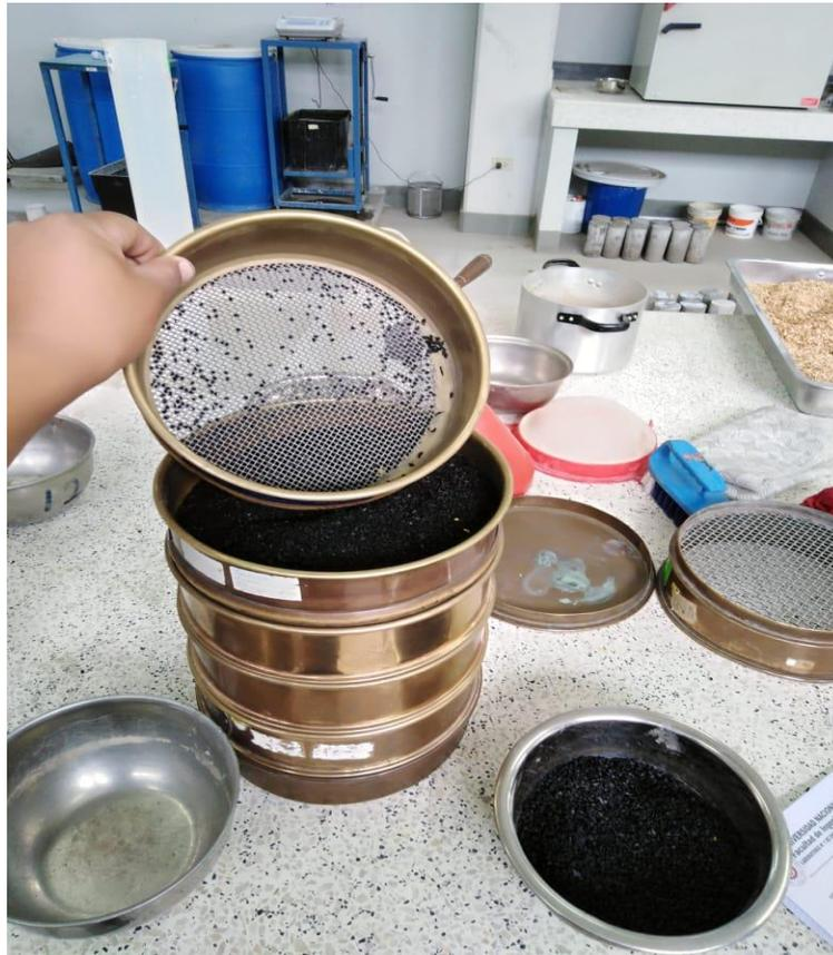
Figura 3. Granulometría del caucho reciclado
