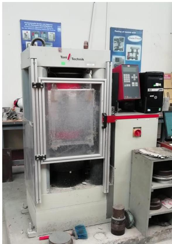
*Figura 26.* Equipo para ensayo a compresión en cubos de mortero (Fuente: Elaboración propia)
