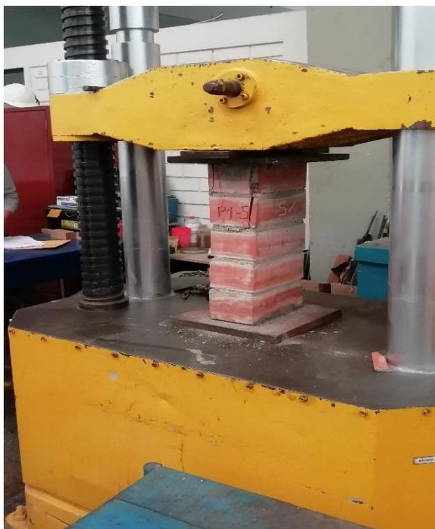
Figura 15. Ensayo a compresión axial. (Fuente: Elaboración propia)
