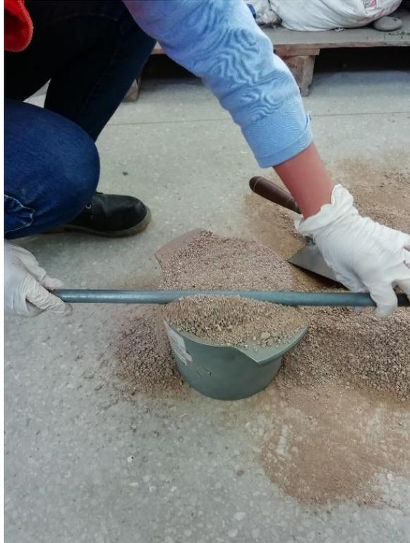
*Figura 9.* Determinación de peso unitario suelto. (Fuente: Elaboración propia)
