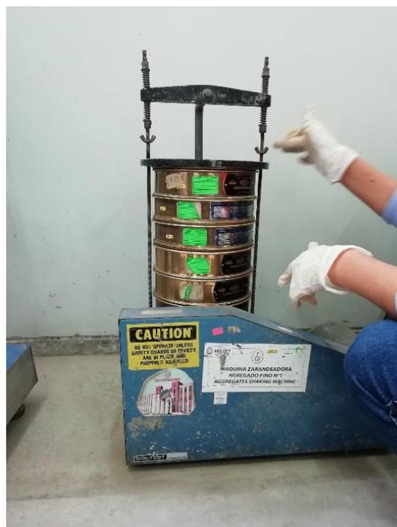
Figura 6. Zarandeador de agregado fino(Fuente: Elaboración propia)
