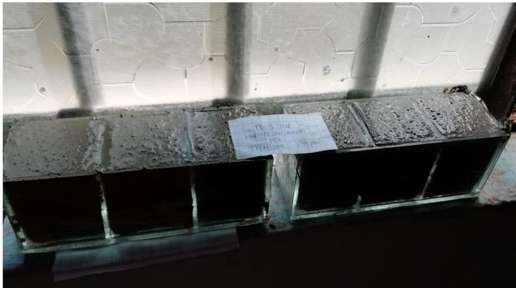
*Figura 25.* Cubitos de mortero con caucho al 10%. (Fuente: Elaboración propia)
