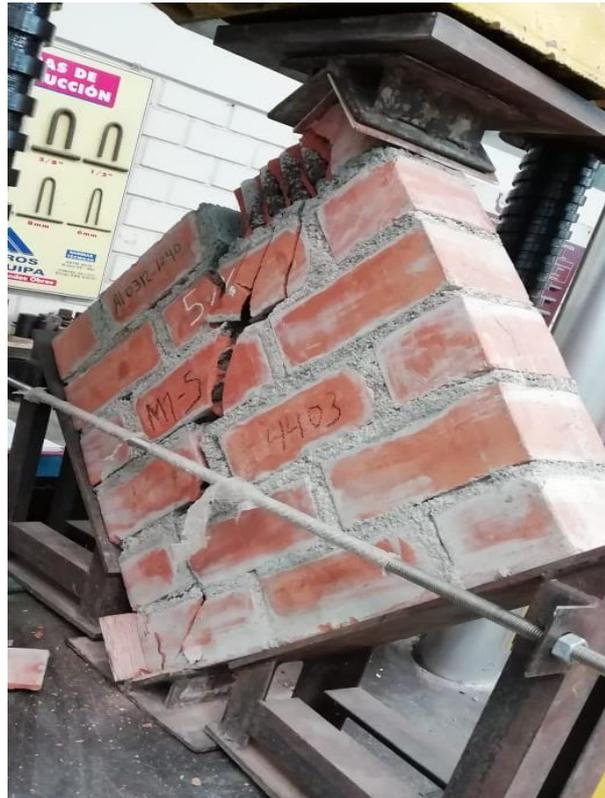
Figura 21. Falla de corte en murete. (Fuente: Elaboración propia)
