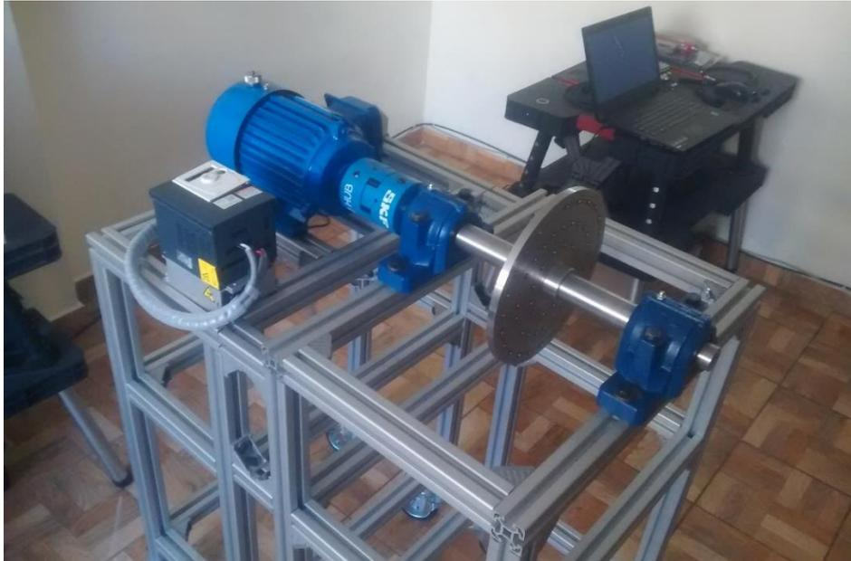
Figura 52. Ensamble terminado del módulo de ensayos vibracionales
