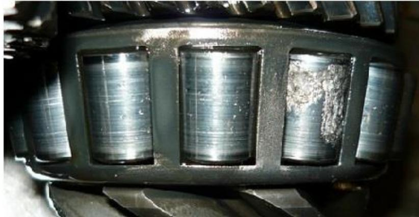
Figura 13. Falla por picadura en un rodamiento.
