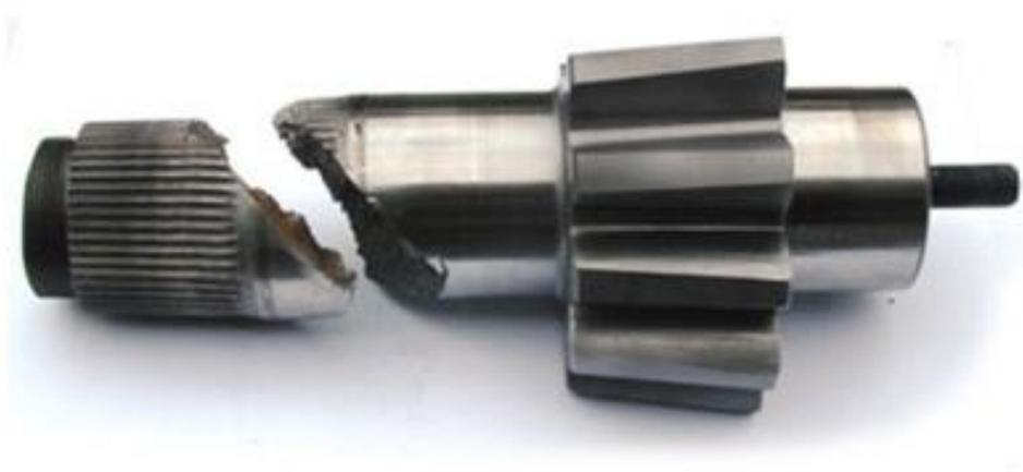
Figura 15. Rotura de un eje de transmisión debido a fatiga.
