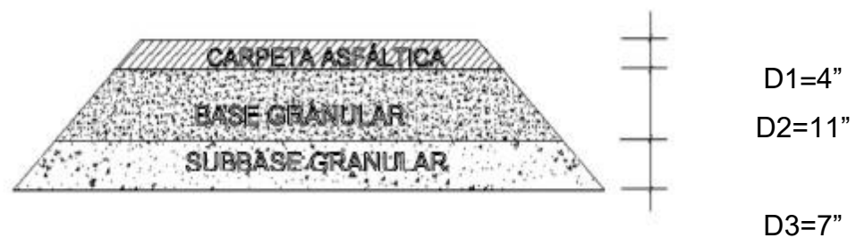
Figura 7: Diseño estructural del pavimento flexible base granular
