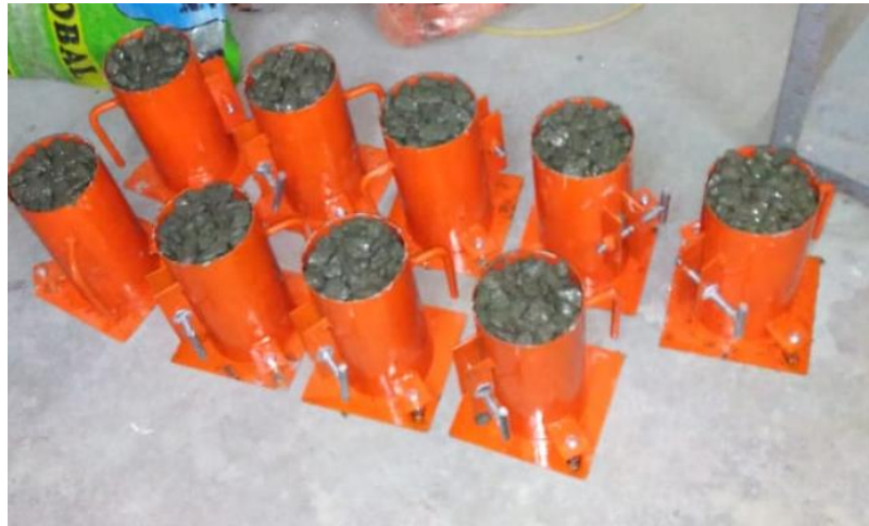
Vertido del concreto en las probetas.
