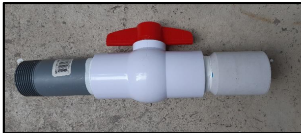
Figura 12. Unión de la válvula tipo bola con el niple y reducción.
