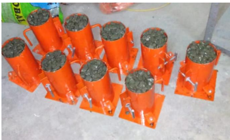
Figura 21. Muestras vertidas en moldes de acero de 4'' por 8''.
