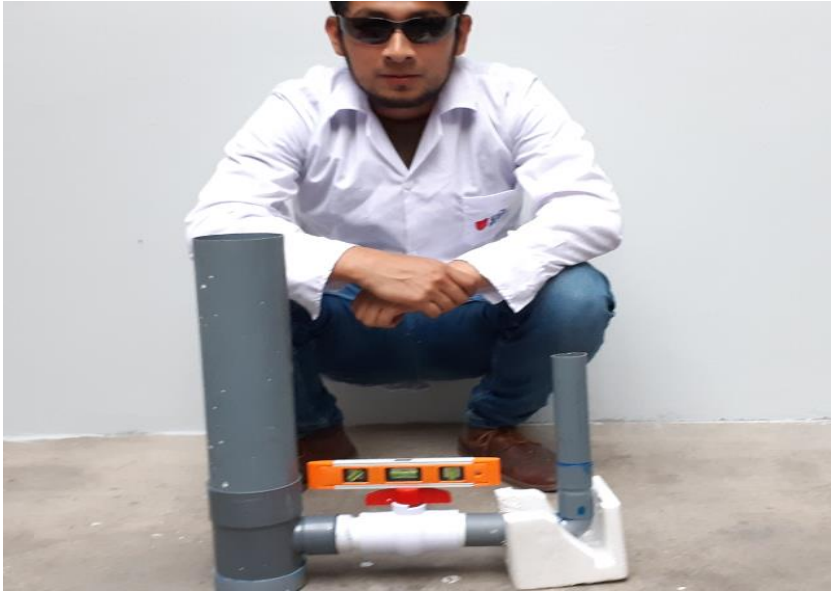
Construcción del permeámetro
