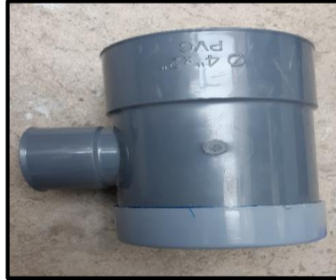
Figura 11. "Unión de la T de 4" con la tapa de 4"
