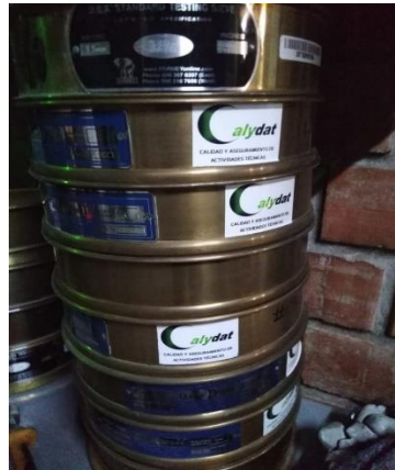
Tamices de 8" empleados para el ensayo de granulometría.
