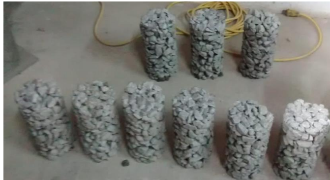
Figura 22. Especímenes de concreto para el ensayo de resistencia a la compresión
