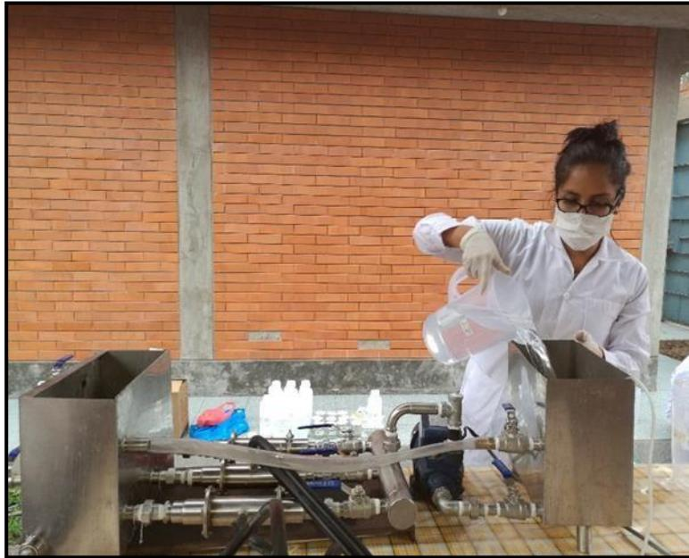
**Figura 10. Dosificación de la muestra en el generador de micro nanoburbujas**
