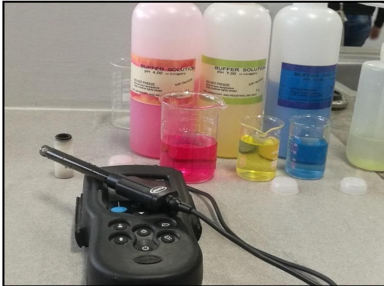
**Figura 5. Insumos y equipos para la calibración de equipos.**
