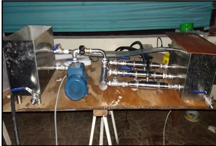
**Figura 9. Generador de micro-nanoburbujas.**
