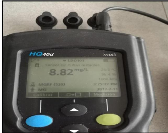
**Figura 7. Equipo para la medición del Oxígeno disuelto.**
