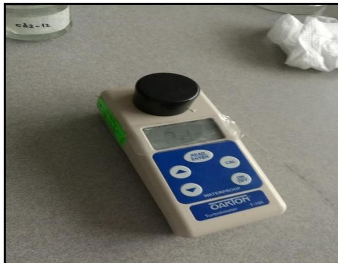
**Figura 8. Equipo para la medición de la Turbidez.**
