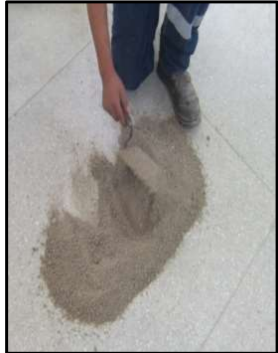
Figura 20. Cuarteo de la muestra
