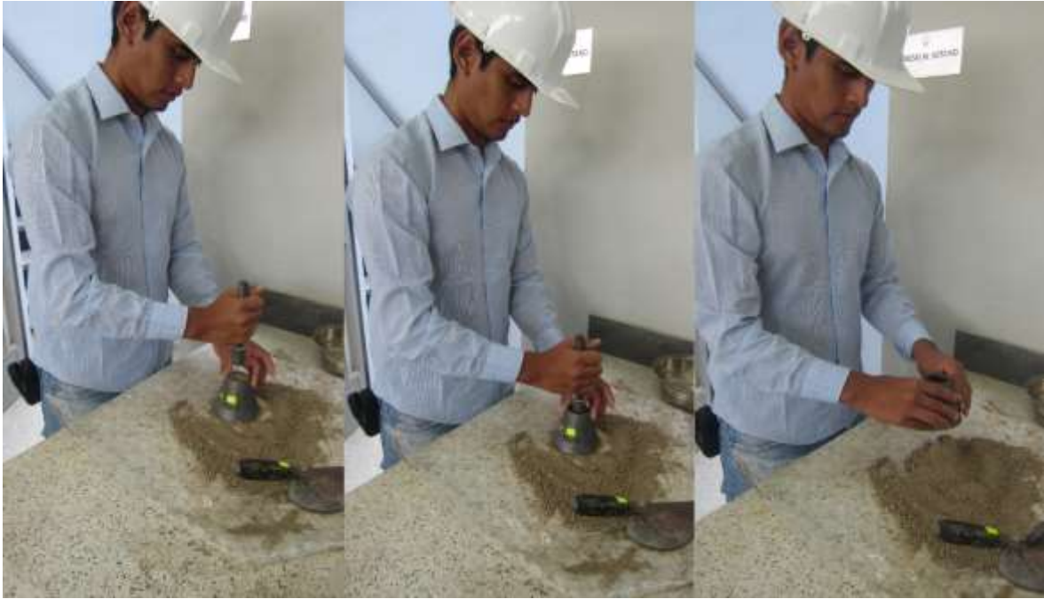
Figura 10. Proceso del ensayo de evaluación con el cono para agregado fino.
