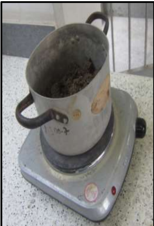
Figura 28. Secado por 2 horas de la muestra
