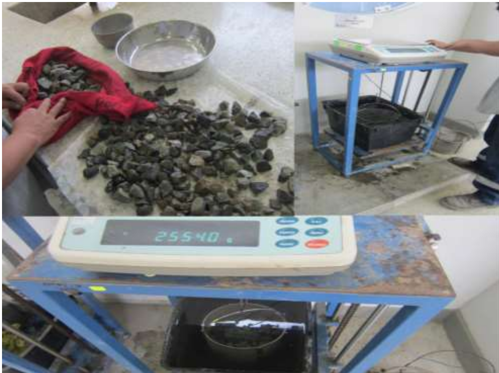
Figura 12. Secado del agregado y pesado en la balanza hidrostática
