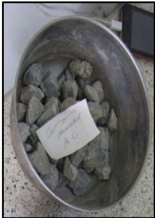
Figura 42. Muestra para el contenido de humedad del amterial
