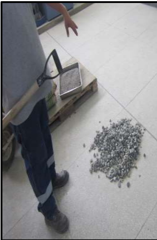
Figura 37. Cuarteo del agregado grueso
