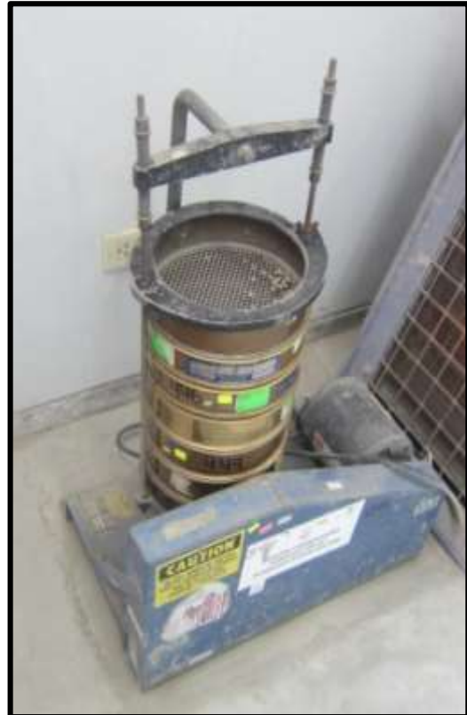
Figura 23. Finalización del peso retenido
