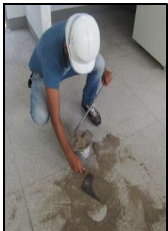
Figura 34. Peso específico de la arena
