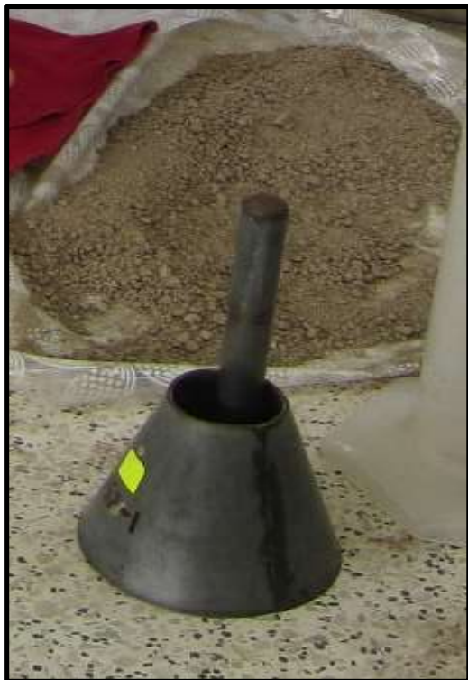
Figura 29. Cono para control de secado de muestra
