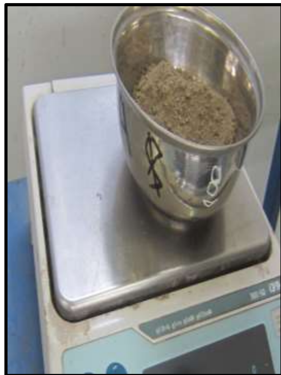
Figura 25. Peso de la muestra para saturar
