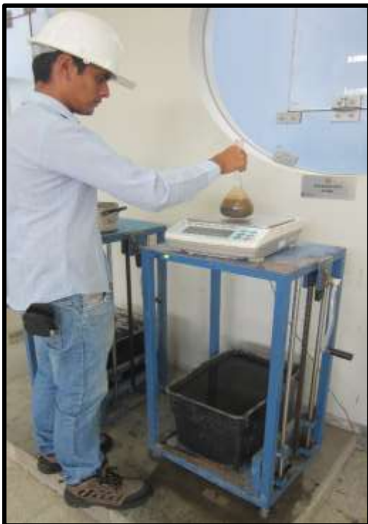
Figura 33. Peso para el contenido de humedad
