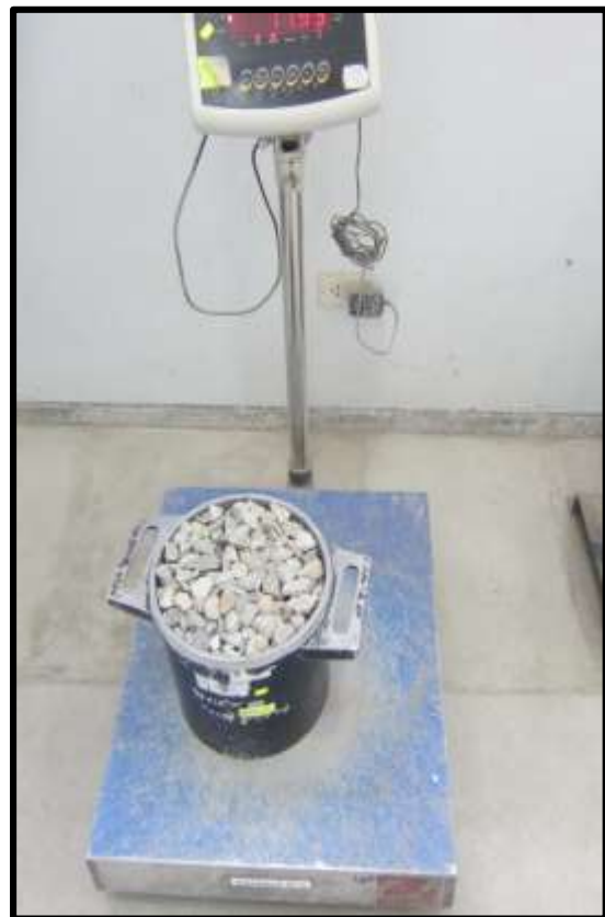
Figura 53. Peso de la muestra para el agregado grueso
