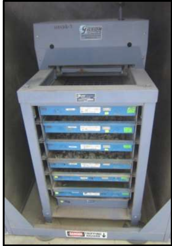
Figura 40. Tamizado por 2 min
