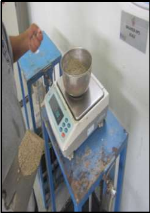
Figura 19. Peso del agregado fino
