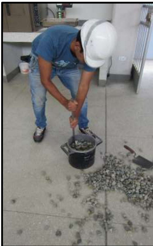
Figura 52. Peso específico compactado
