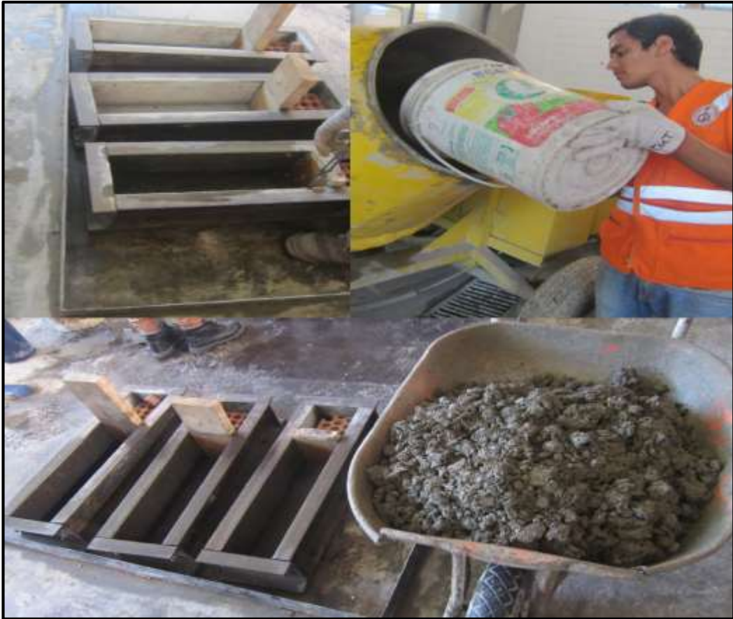
Figura 15. Elaboración de la mezcla para el vaciado en el molde.
