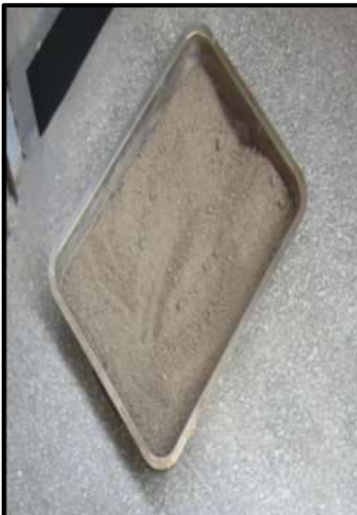
Figura 24. Muestra para el contenido de humedad
