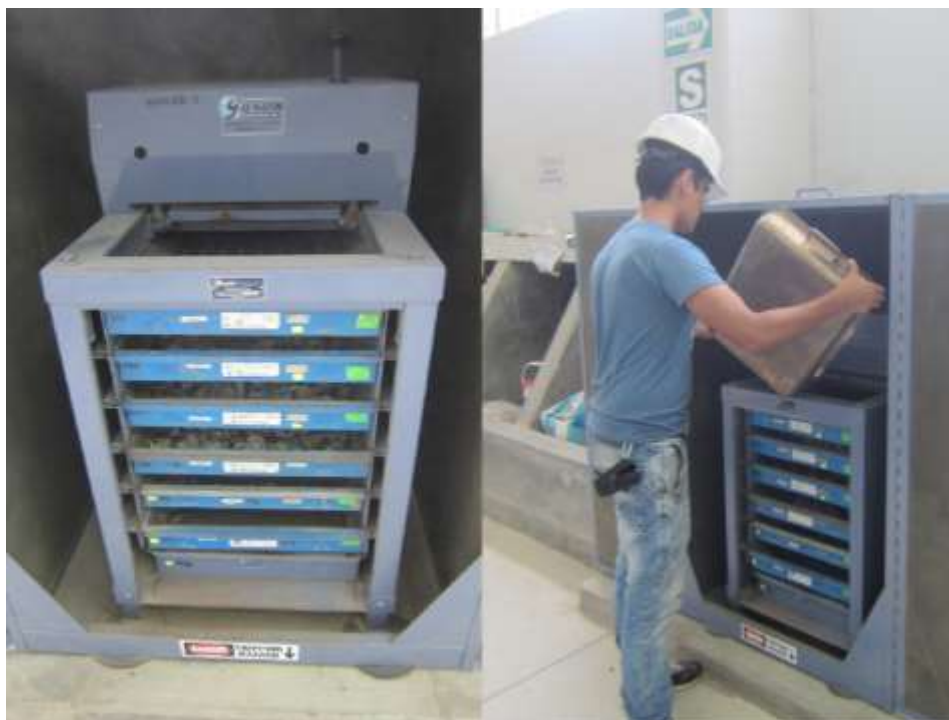
Figura 11. Colocado del agregado grueso en la tamizadora.
