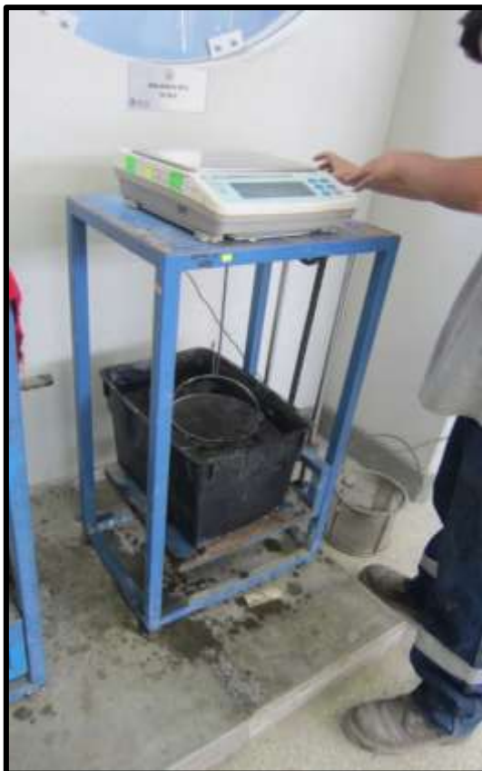
Figura 48. Peso de la muestra en la balanza hidrológica
