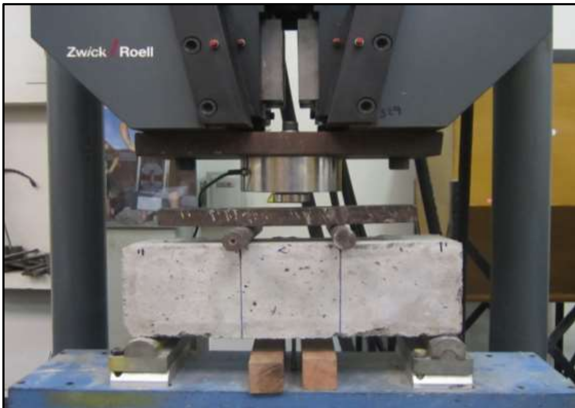
Figura 18. División de la viga en los tercios
