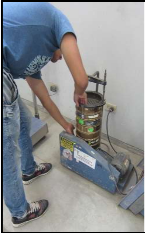
Figura 22. Verificación del tamizado
