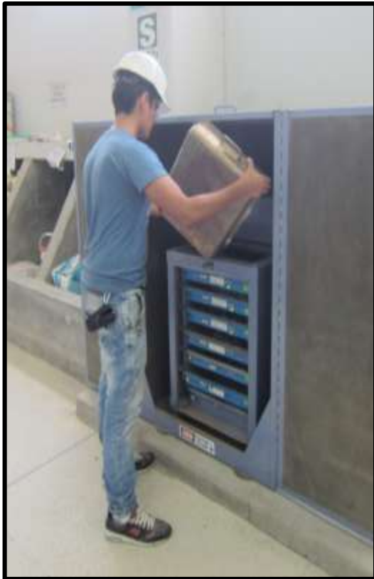
Figura 39. Vaciado del agregado grueso en la tamizadora
