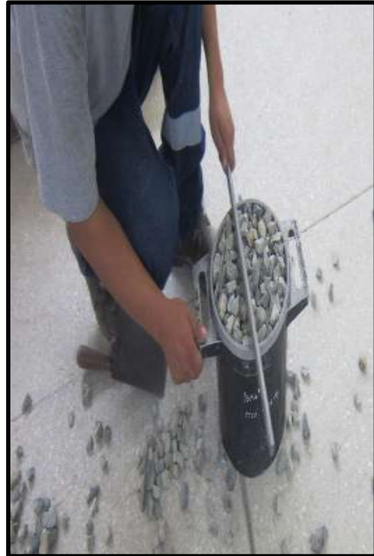
Figura 51. Peso específico suelto
