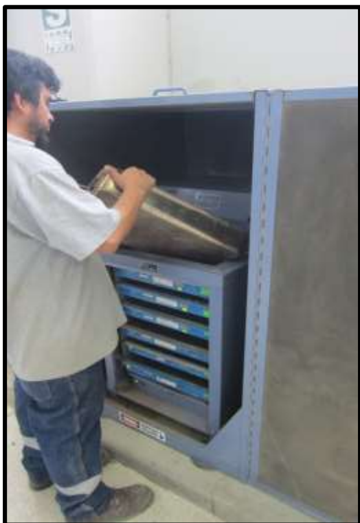
Figura 42. Tamizado de la muestra para el contenido de humedad
