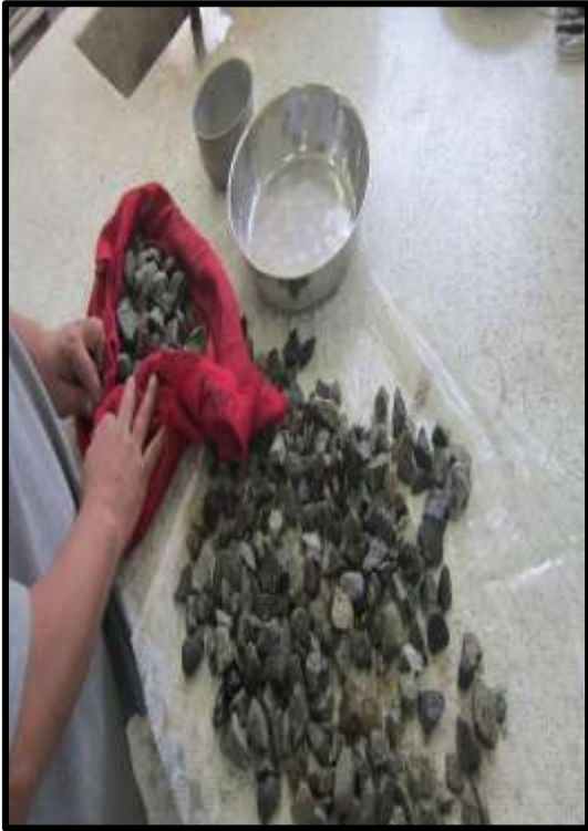
Figura 46. Secado de la muestra saturada
