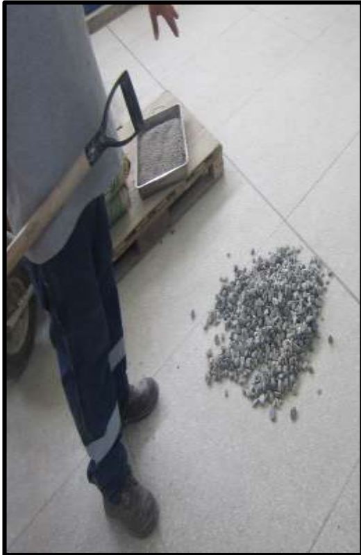
Figura 50. Cuarteo de la muestra para el peso específico
