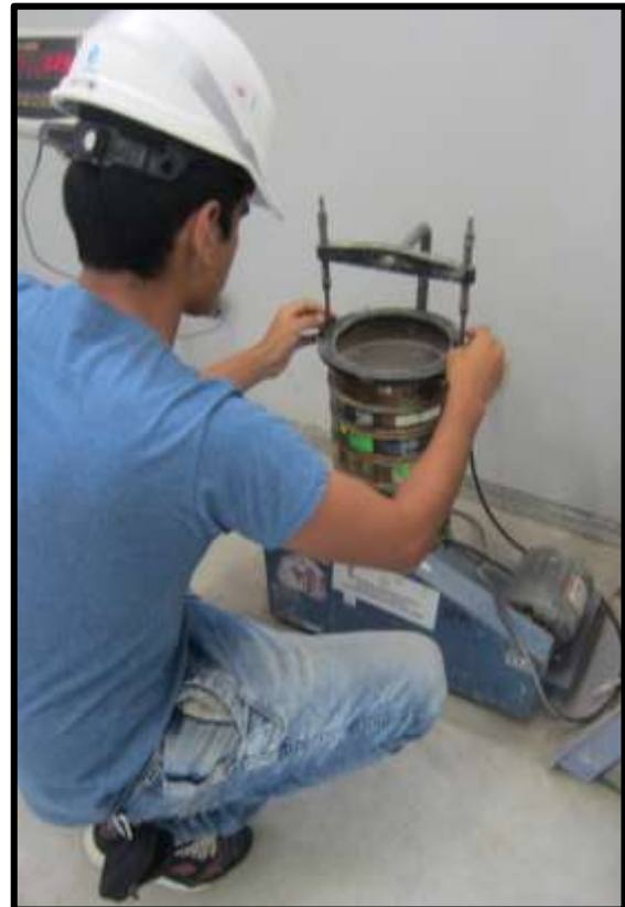
Figura 20. Tamizado del agregado fino
