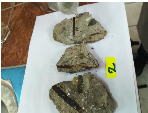
Anexo27: eflorescencia en la columna
