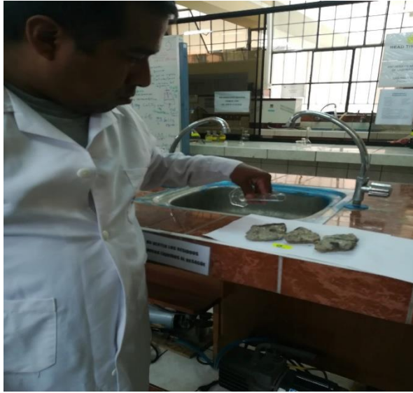
Anexo31: aplicación de fenolftaleína
