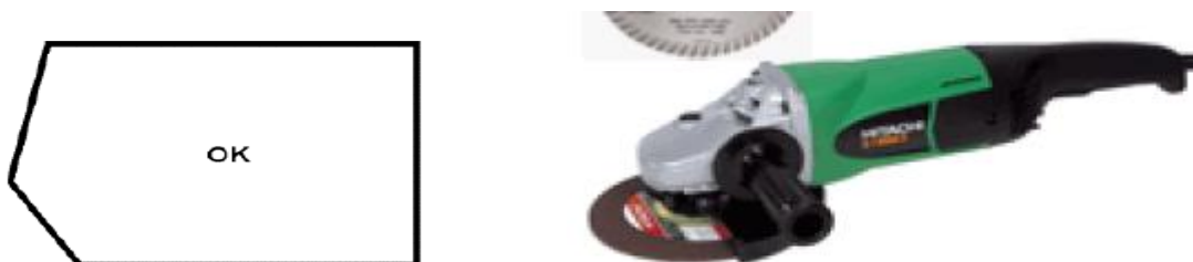
Figura51: corte de sierra circular dar la forma con menor Angulo posible
